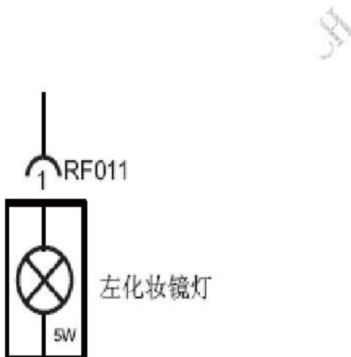
部件端连接器在电路图上如上显示。该图表示母连接器RF001的针脚1与部件（左化妆镜灯相连）。杯形符号“<”表示母连接器。
