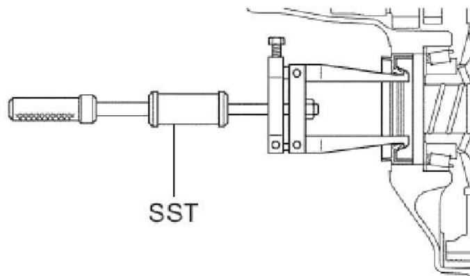
14). 安装差速器半轴轴承护圈油封
