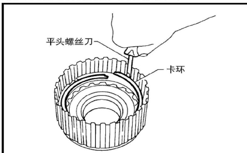
9). 使用塞规测量超速档离合器挡片与卡环间的间隙。如果超过允许极限，选择合适的挡片。
