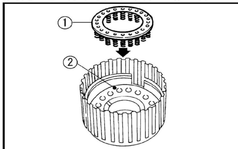
6). 将专用维修工具[SST] 置于弹簧座总成上，在压缩弹簧座总成时安装卡环。
