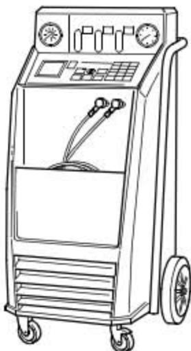
◆ 首先必须用空调制冷剂充放机 -VAS 6007A- 将制冷剂抽出。
