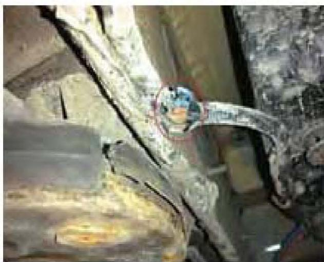
5). 底护板，发现护板破裂的位置有好几根线也被压断了，如图所示。检查发现断开的几根线正好通到压缩机上面。再次询问车主才明白，原来故障出现前刚刚在外面轮胎店补过轮胎。分析原因可能是在拆卸轮胎时，举升车辆顶错了位置，造成右前底护板破裂，线束被压断，导致车辆行驶中 EHC 系统报警。修复断开的线束，清除故障码，启动车辆，故障报警消失。
