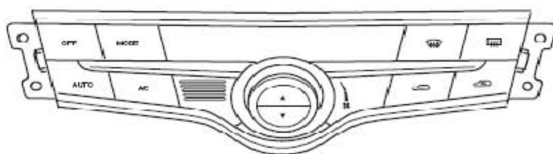
暖风和通风的控制机构安装在仪表板中心的面板上，控制面板也形成了空调(A/C)ECU的一部分。温度调节按键控制着车内出风口温度，鼓风机风速旋钮控制鼓风机的转速，一个模式按键控制空气分配，两个按钮开关分别控制新鲜/循环空气的选择，前挡风玻璃除霜和后风窗加热(HRW)的操作。当分别按下上述开关时，LCD中相应的图标被点亮。面板上和控制开关上的图标表明了各功能块的运行位置和功能。
