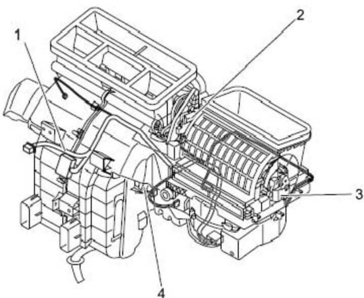
5). 拆卸内/外循环风门执行器。
