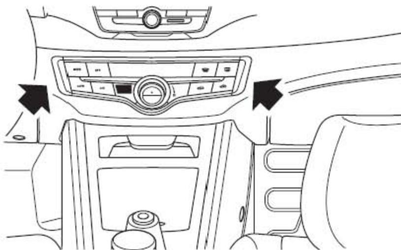
3). 拆卸空调控制器总成紧固螺钉。
