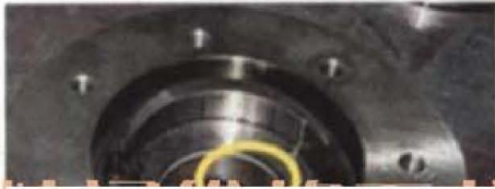
图三：磨损的油泵铜套
