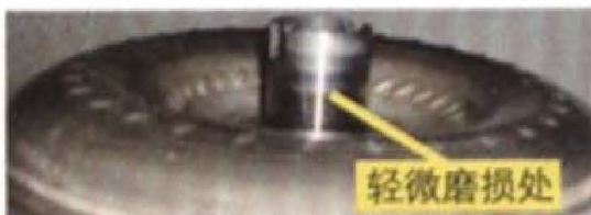
图二：轻微磨损的变扭器轴颈
