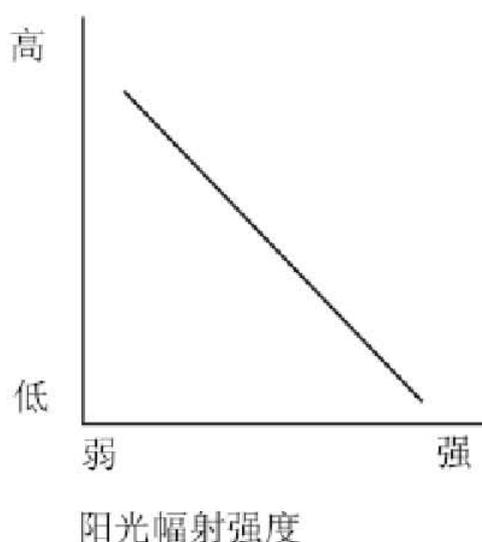
阳光传感器安装在仪表板上侧，用来检测阳光和控制空调 AUTO 模式。阳光传感器的输出电压根据阳光量大小而变化。随着光线的增强，输出电压增高。随着光线的减弱，输出电压降低。空调放大器检测到阳光传感器的输出电压。
