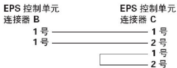
EPS 控制单元连接器 B (2 针) 阴端子的线束侧
