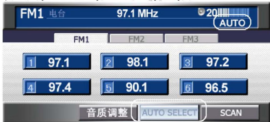
开始自动搜索可接收的电台，搜索结束显示电台列表，搜索完毕后会自动回到第一个电台。
