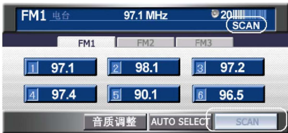
扫描预览功能会对所有波段内的所有已存储电台进行播放预览。显示屏上会显示“SCAN”字样。系统将对所有波段上已存电台依次播放约 10 秒钟。若此时不进行任何操作，系统将继续播放下一电台，当播放到您欲收听电台时，只需再按一下屏幕[SCAN]按钮或面板[SCAN]按键即可。
