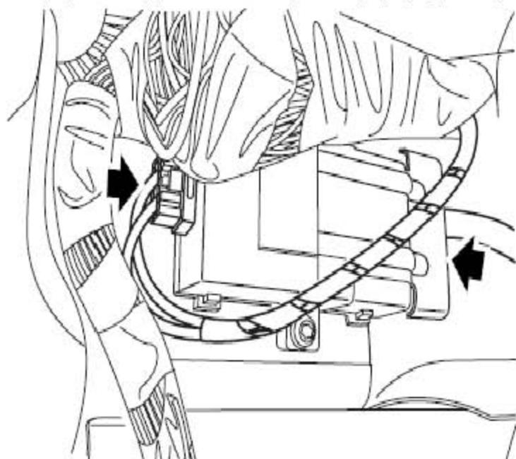
59). 从发动机防盗控制单元上断开连接器
