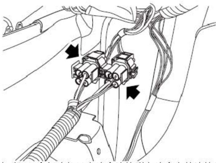
38). 断开2个把冷却风扇线束连接到主线束上的连接器。
