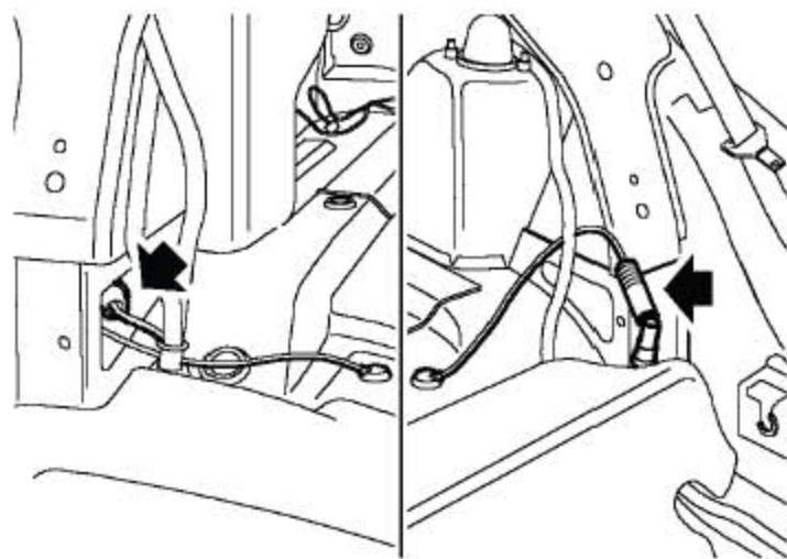
87). 从后座椅后面断开2个ABS传感器连接器。
