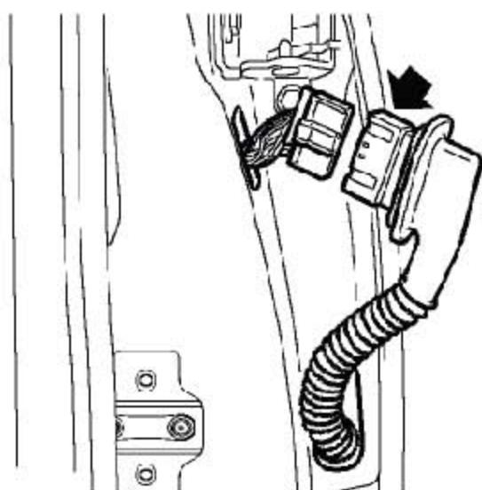
6). 从门和BC 柱上松开线束套筒和连接器。
