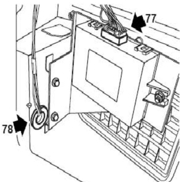
77). 从停车距离控制ECU上断开连接器。
