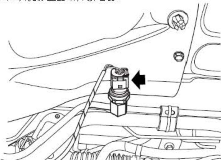
22). 断开三级压力传感器连接器。
