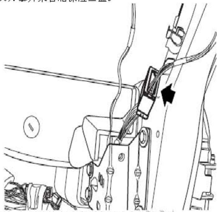
57). 断开连接主线束到车顶线束连接器。
