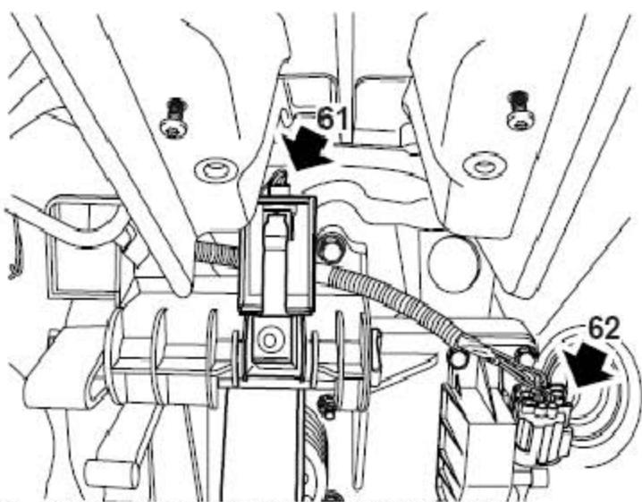
61). 从制动踏板后部断开制动灯开关连接器。
