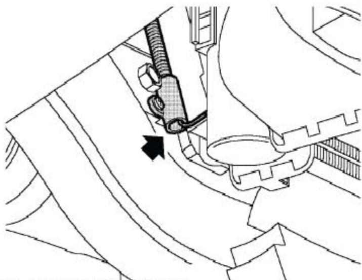
26). 断开空调压缩机连接器。
