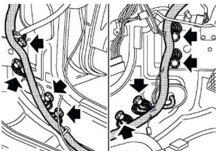
66). 从左右两侧A柱下断开8个接地头。
