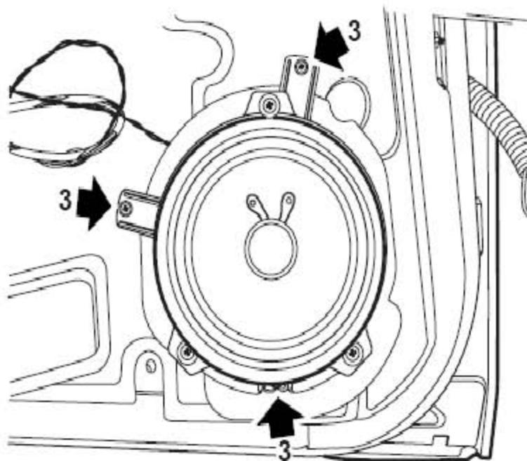
3). 松开3个把低音扬声器总成固定到车门上的螺钉。
