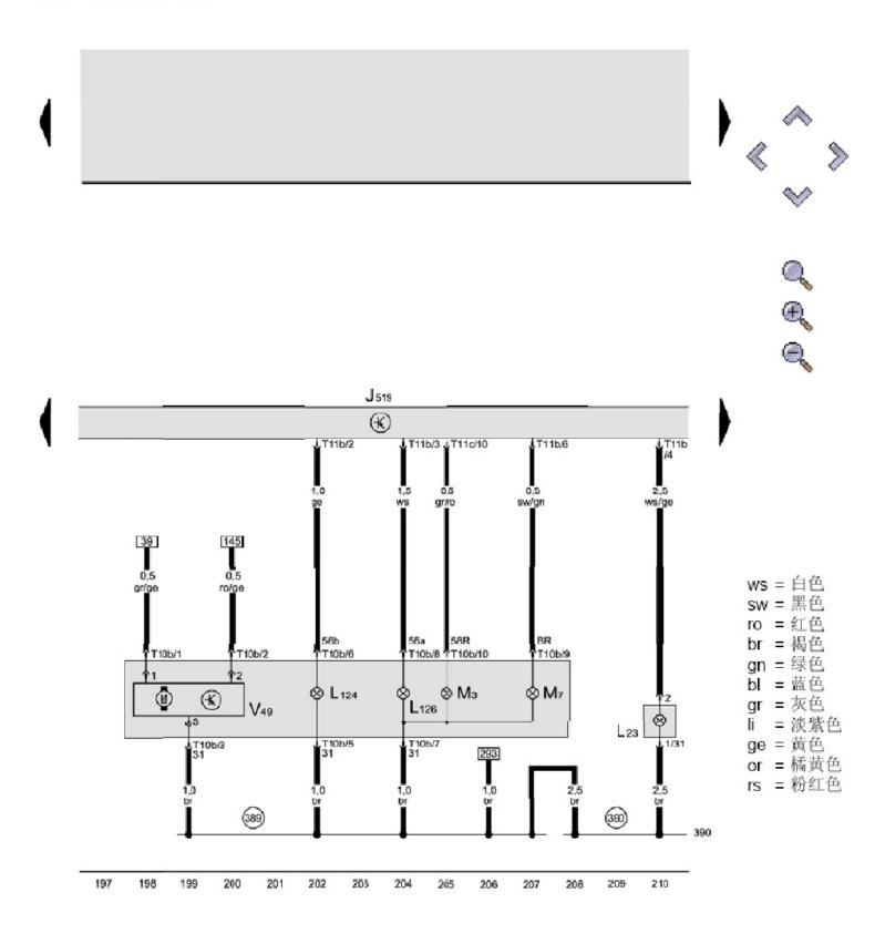
车载电网控制器、右侧雾灯灯泡、右驻车灯灯泡、右前转向信号灯灯泡、照明距离调节右伺服马达、右侧近光灯灯泡、右侧远光灯灯泡
