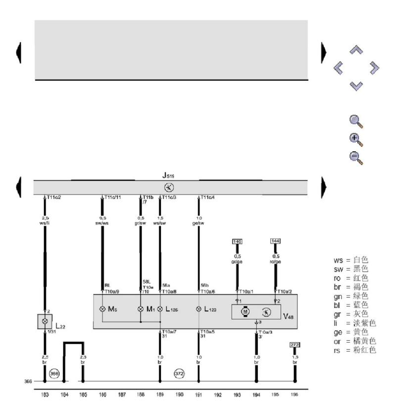
车载电网控制器、左侧雾灯灯泡、左驻车灯灯泡、左前转向信号灯灯泡、照明距离调节左伺服马达、左侧近光灯灯泡、左侧远光灯灯泡
