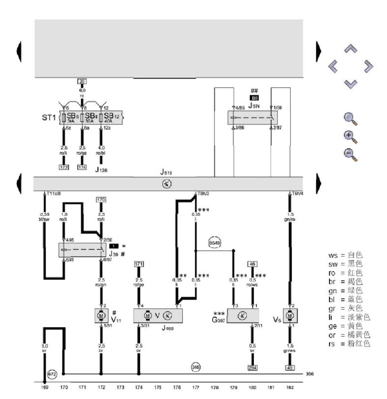
车载电网控制器、大灯清洗装置继电器、挡风玻璃清洗泵继电器、雨刮马达控制器、雨水和光线识别传感器
