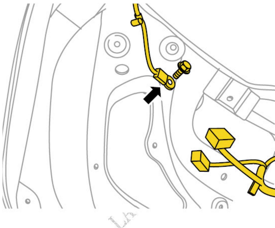
2). 用粗砂布清洁线束侧接地铜环的两个接触表面，（包括与车身侧及与螺栓侧）直到氧化物完全清洁干净。
