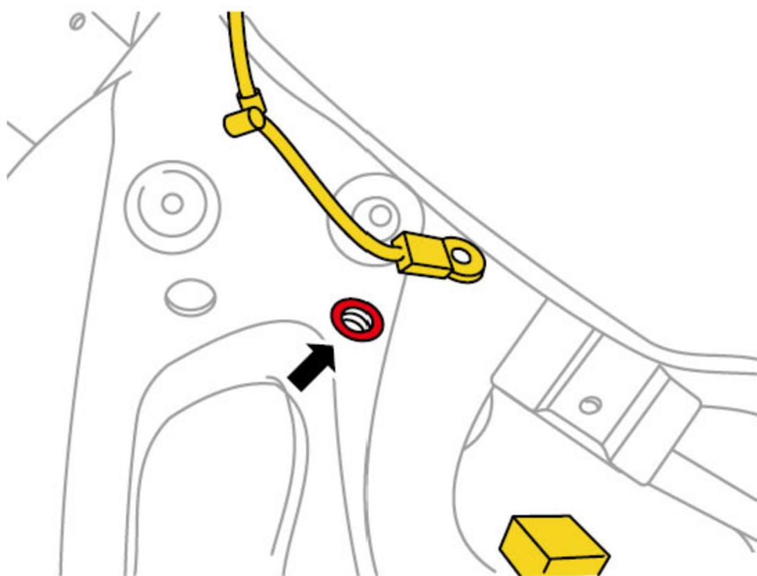
4). 重新安装接地点线束及固定螺栓，并按规定力矩拧紧。
