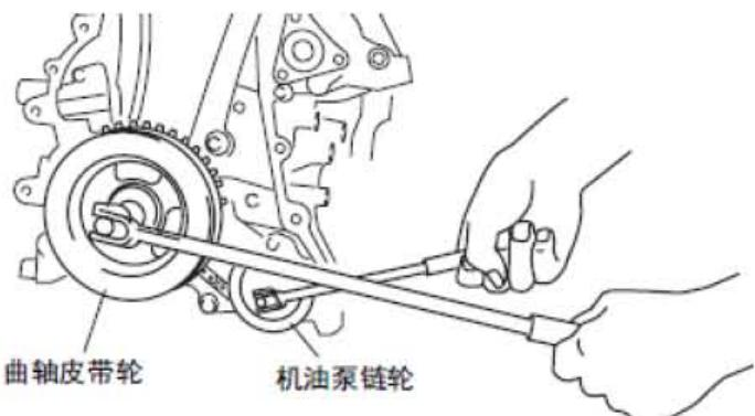
2). 拆/装油泵链轮，然后拆下曲轴皮带轮及其锁紧螺栓。
