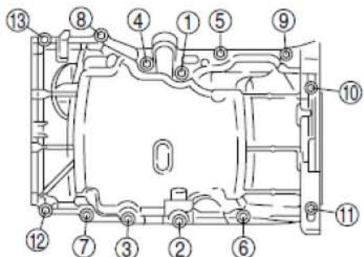
6). 拧紧油底盘- 变速驱动桥的安装螺栓。
