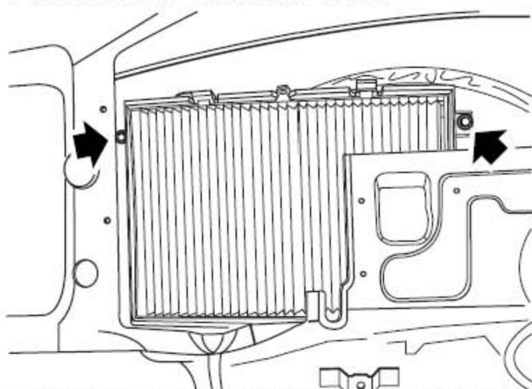
3). 拆下将空调滤清器进风罩固定到车身上的两个螺栓，拆下空调滤清器进风罩。
