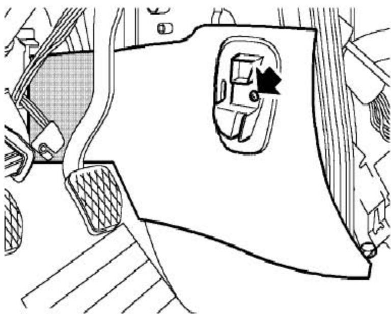
9). 松开将暖风机左右两侧出风口固定到空调隔热板上的螺钉，拆下空调隔热板。
