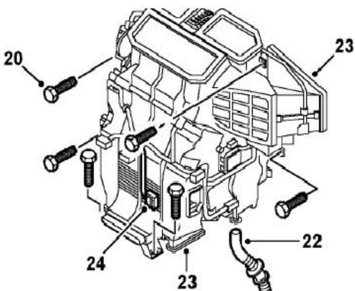
20). 拆下6个将暖风机总成固定到车身上的螺栓。
