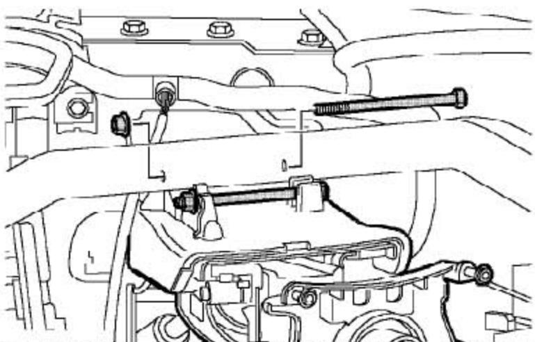
13). 拆下将转向管柱支架固定到仪表板骨架上的2个螺母和螺栓。
