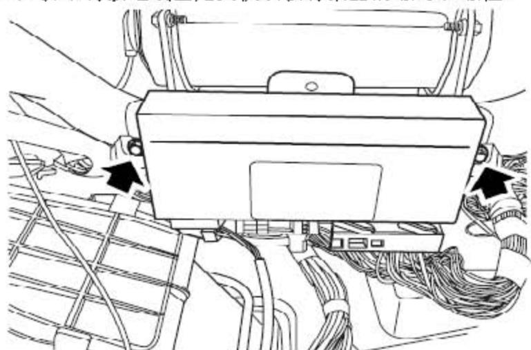
17). 拆下2个将BCU固定到仪表板骨架上的螺栓并降低BCU。
