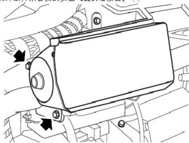
12). 拆下4个将前排乘客侧前气囊模块固定到仪表板骨架上的螺栓，拆下气囊模块。
