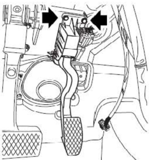
3). 松开将油门踏板固定到踏板支架上的螺栓，拆下油门踏板。
