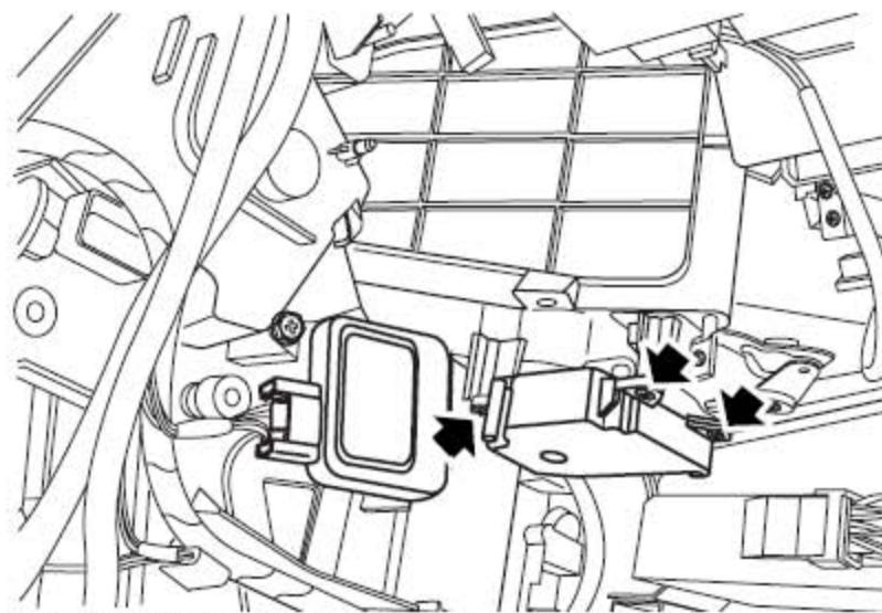
2). 拆下3个固定新鲜循环空气风门电机的螺钉。
