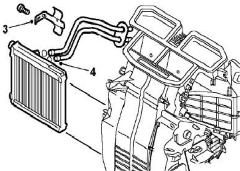
3). 松开将管子固定到暖风机总成上的支架。
