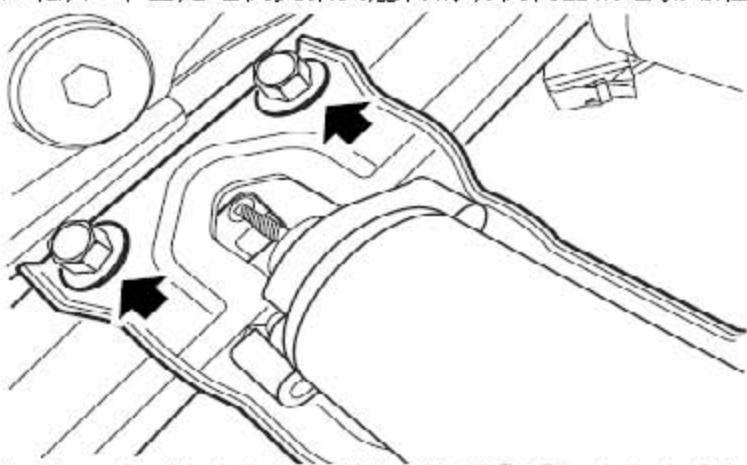
6). 松开2个固定电机支架的左侧螺栓，拿开电机和支架。
