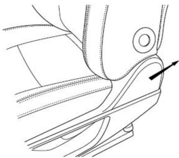
4). 推出固定外侧饰板的卡扣，向后上方拉，拆下饰板。
