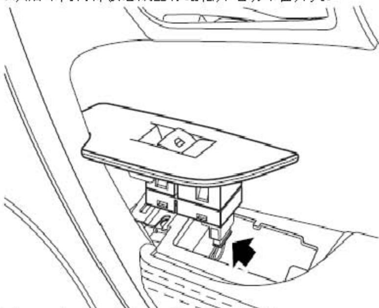
3). 断开后车门电动车窗开关连接器的连接。
