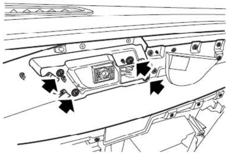
2). 拧开把前车门内拉手总成固定到内饰板总成上的4个自攻螺钉。
