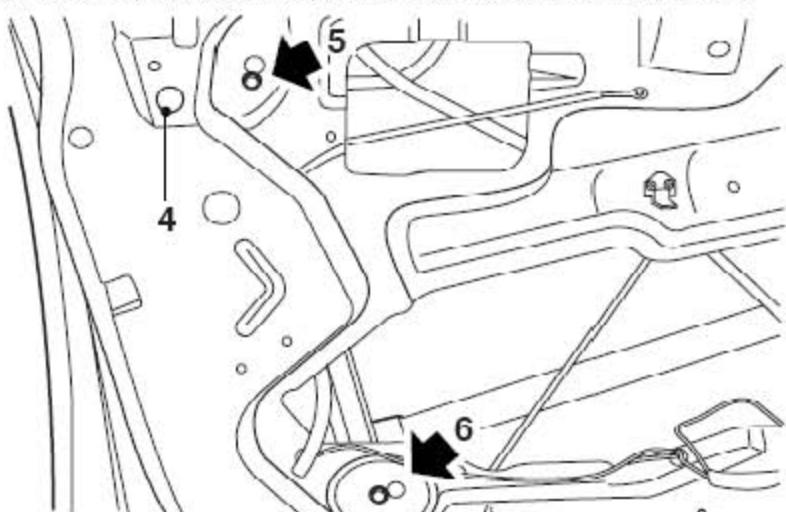
4). 提升玻璃直到电动玻璃升降器橡胶夹固定螺栓对准门孔处，松开螺栓，把玻璃从电动玻璃升降器上松开。
