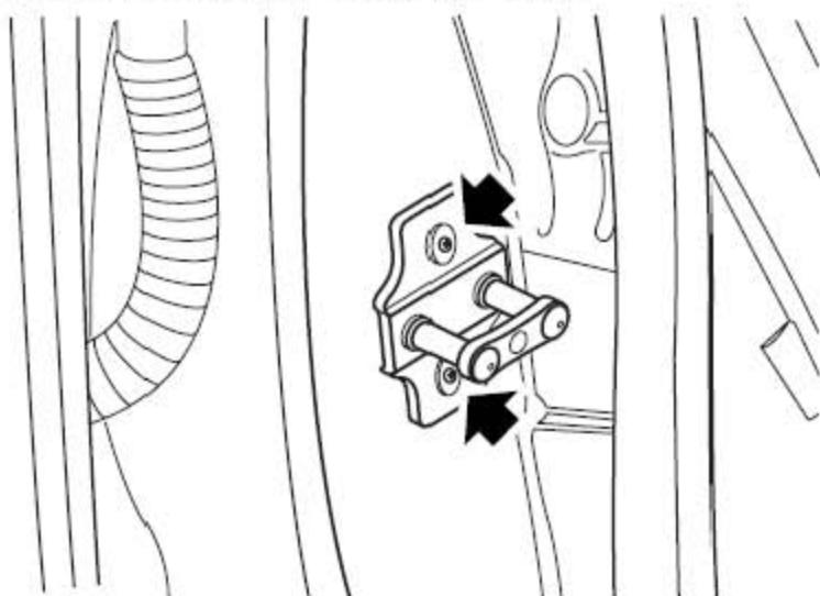
4). 松开2个固定车门锁扣的螺钉。
