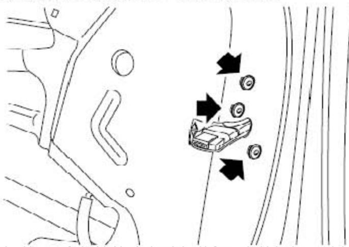
4). 拧开3个把锁体总成固定到车门上的螺钉，并把锁体总成移开到车门门孔处。
