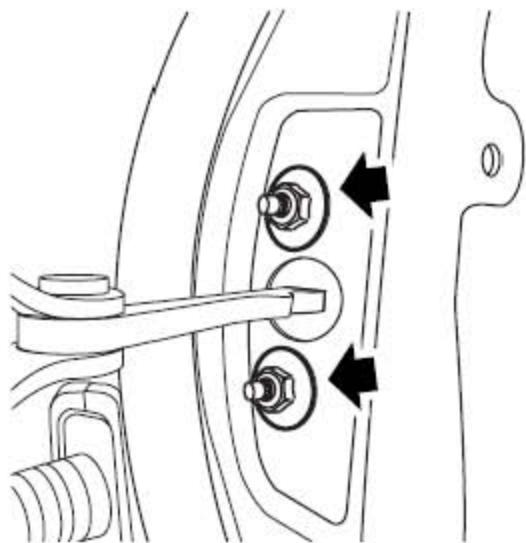
3). 从前车门上拆卸2个带垫圈螺母。
