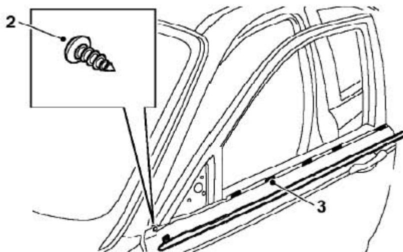
2). 拧开把前车门窗台外侧密封条总成固定到车门上的自攻螺钉。
