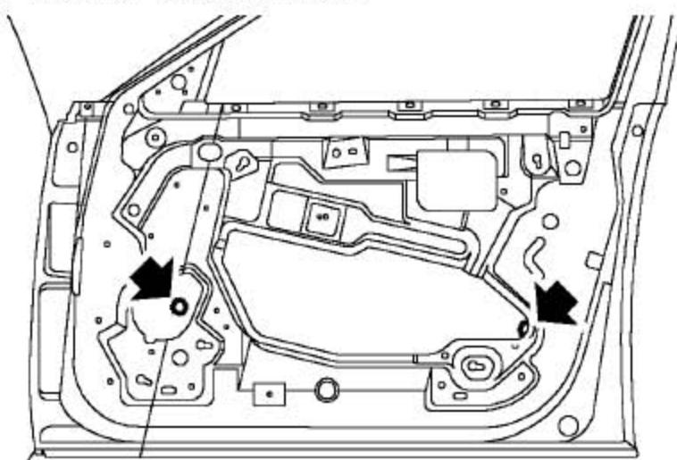
3). 降低玻璃并松开电动玻璃升降器橡胶夹固定螺栓。
