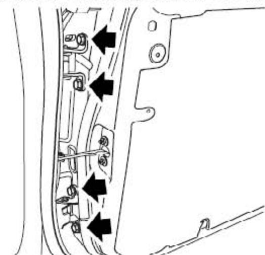
2). 拧开把铰链总成固定到后车门的螺栓。
