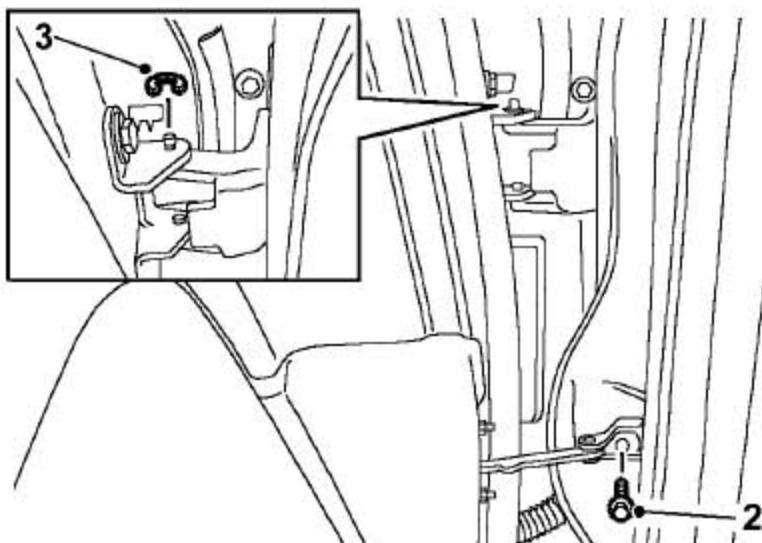
2). 拧开把前车门限位器总成固定到A柱上的螺钉。
