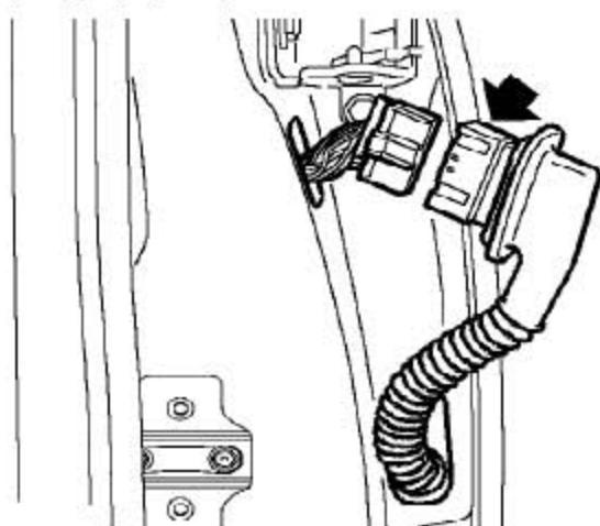
5). 松开线束套筒，断开连接器的连接。
