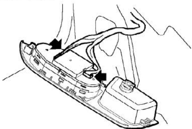
2). 连接电动车窗开关的连接器。
