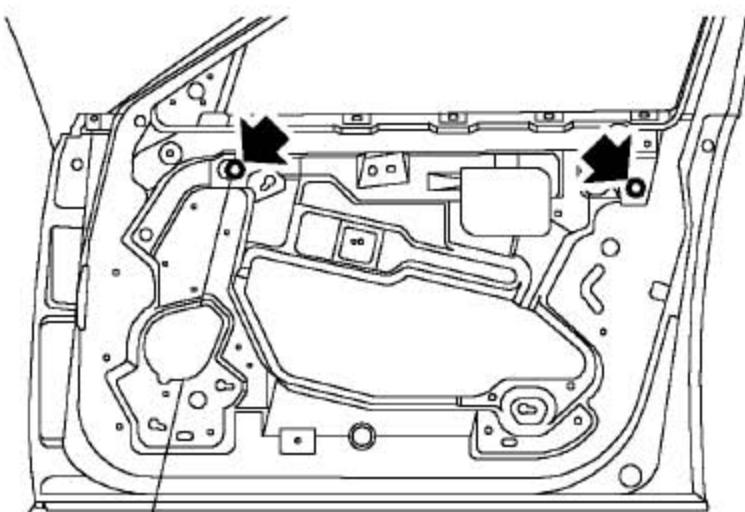
7). 拧紧玻璃升降器橡胶夹固定螺栓至6.5-7.5Nm。
