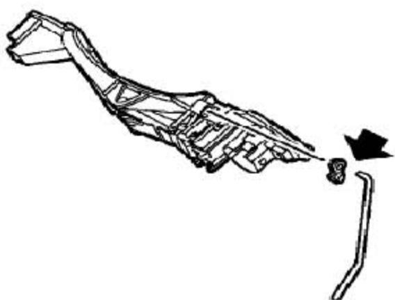
10). 从后车门外手柄衬板总成上松开后车门外手柄释放连杆。
