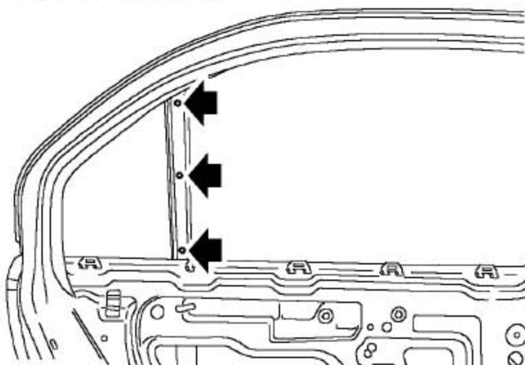
3). 拧开3个把后车门玻璃侧轨外饰条总成固定到车门上的螺钉。
