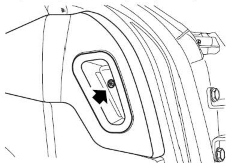
3). 拧开把前车门除雾风口密封件安装到车门上的自攻螺钉。
