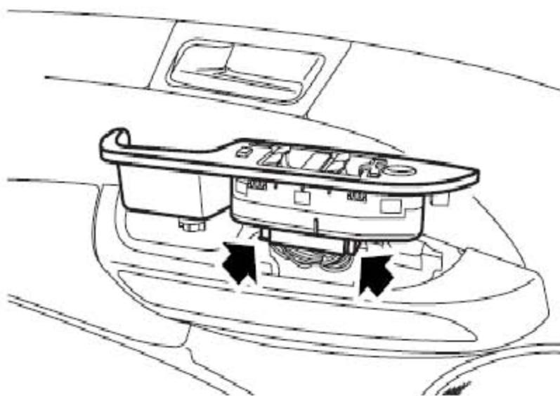
5). 断开驾驶员侧门组合开关连接器的连接。
