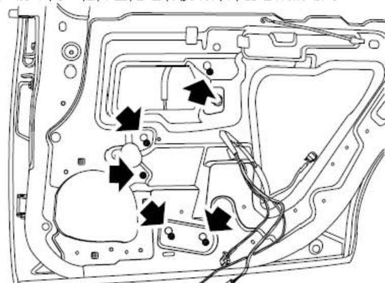
5). 后车门：松开固定电动玻璃升降器总成的螺钉。
