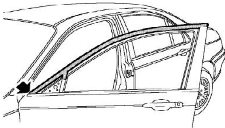
4). 松开把前车门玻璃窗滑槽密封条固定到前车门窗台外侧密封条总成上的自攻螺钉。
