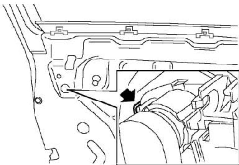
2). 拨动驾驶员侧门外手柄衬板总成上的夹箍，松开驾驶员侧门外手柄闷盖。
