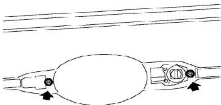
7). 松开把驾驶员侧门外手柄衬板总成固定到车门上的2个螺栓。
