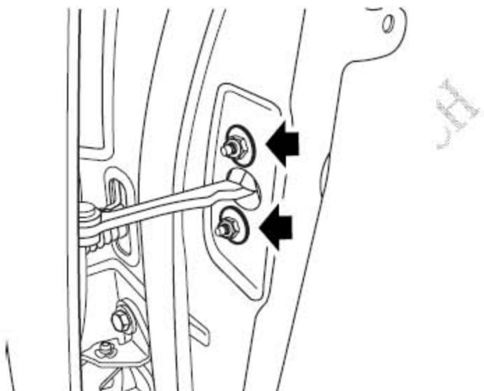
3). 从后车门上拆卸2个带垫圈螺母。
