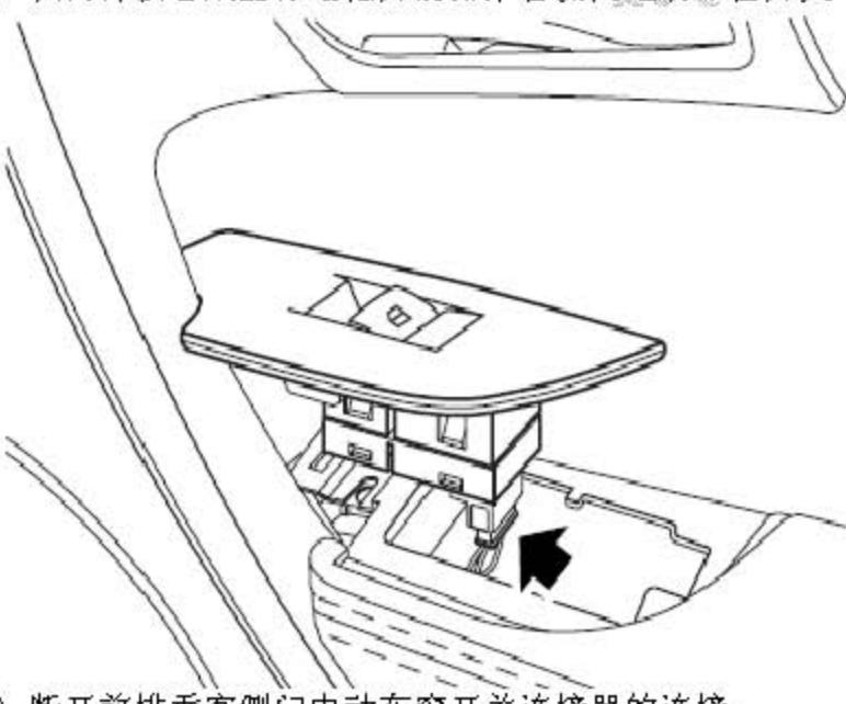
3). 断开前排乘客侧门电动车窗开关连接器的连接。
