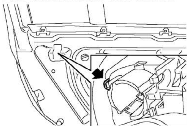
3). 拨动后车门外手柄衬板总成上的夹箍，松开后车门外手柄闷盖。
