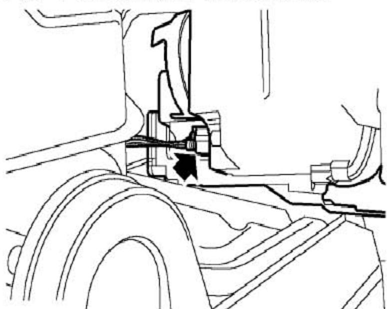
4). 松开前照灯，断开连接器，取下前照灯总成。
