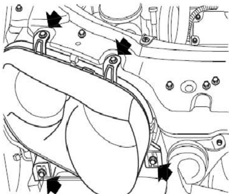
3). 拆下4个把前照灯固定到水箱上横梁上的螺栓。
