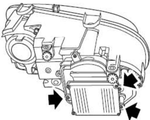
2). 拆下将整流器连接到前照灯总成上的螺钉。
