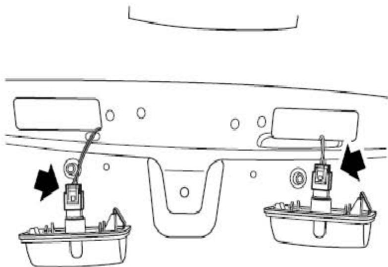
3). 断开连接器，并从后牌照饰板上松开后牌照板灯总成。
