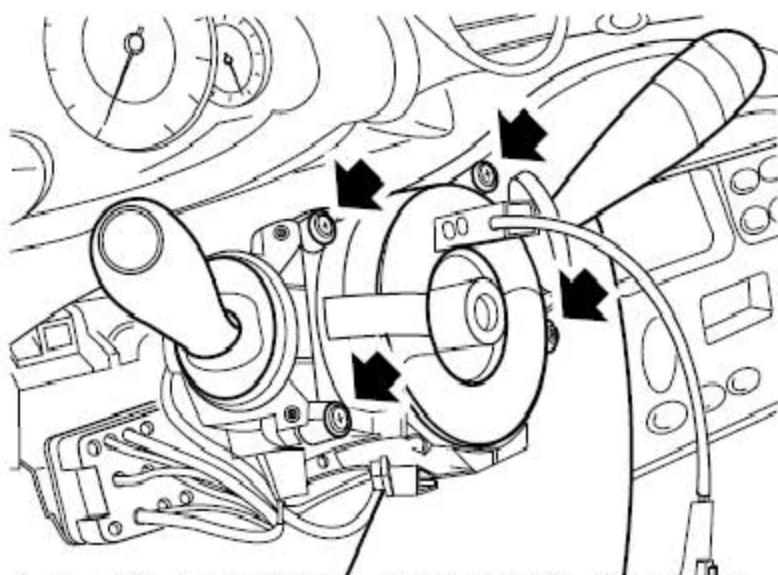
3). 拆下转向柱拨杆把组合开关固定到转向管柱的4个自攻螺钉。
