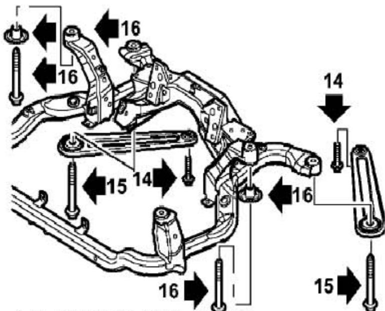
14). 用千斤顶支撑起前副车架的后部。
