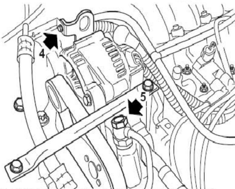
4). 拆下动力转向机进油管固定到支撑支架上的螺栓。
