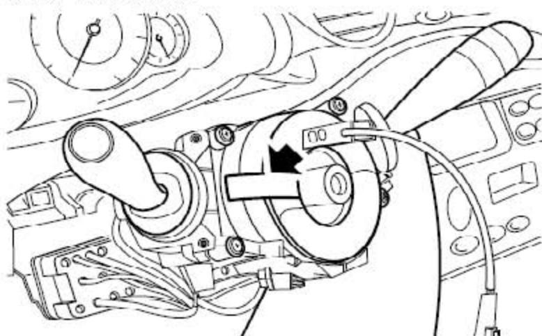
7). 在转向管柱拨杆组合开关上贴上粘合带并保持正确的位置。
