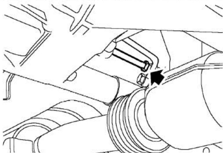
22). 拆下动力转向机供油管的连接并废弃密封垫圈。
