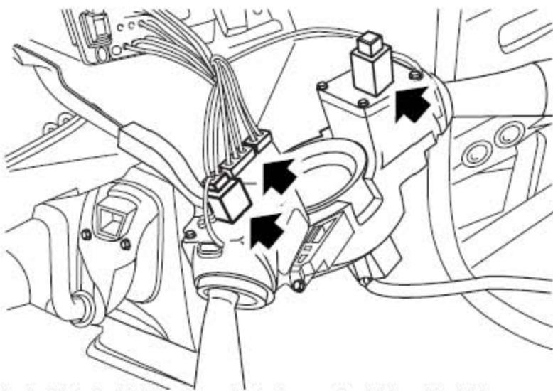
4). 从转向柱拨杆组合开关上断下4个连接器的连接。
