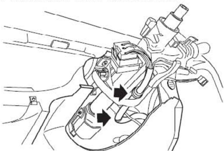
6). 断开2个把连接器线束固定到转向管柱上的扎带。
