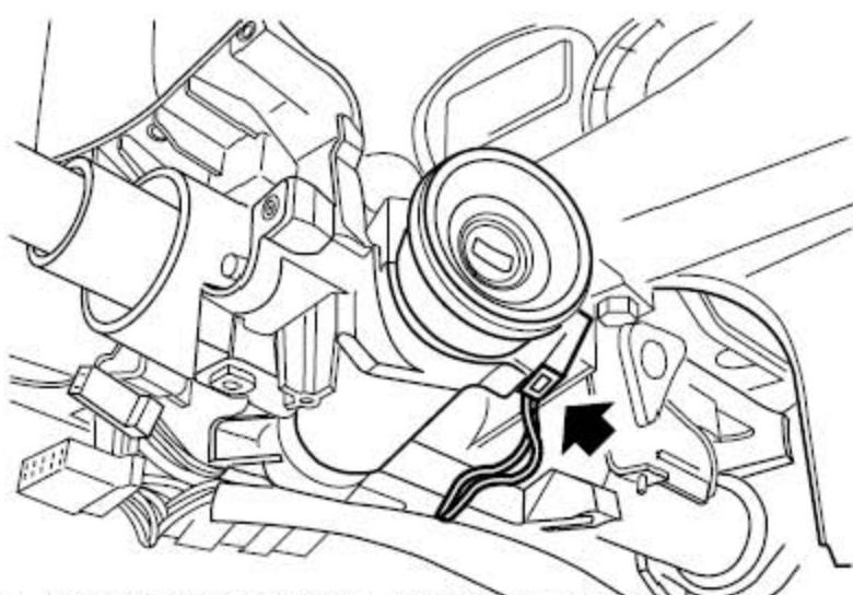
2). 从钥匙密码识别线圈上断开连接器的连接。
