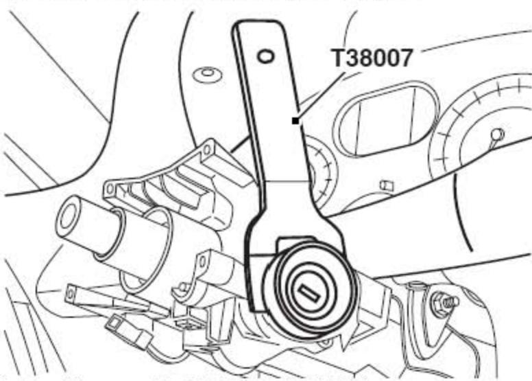
3). 用工具T38007拆下钥匙密码识别线圈。
