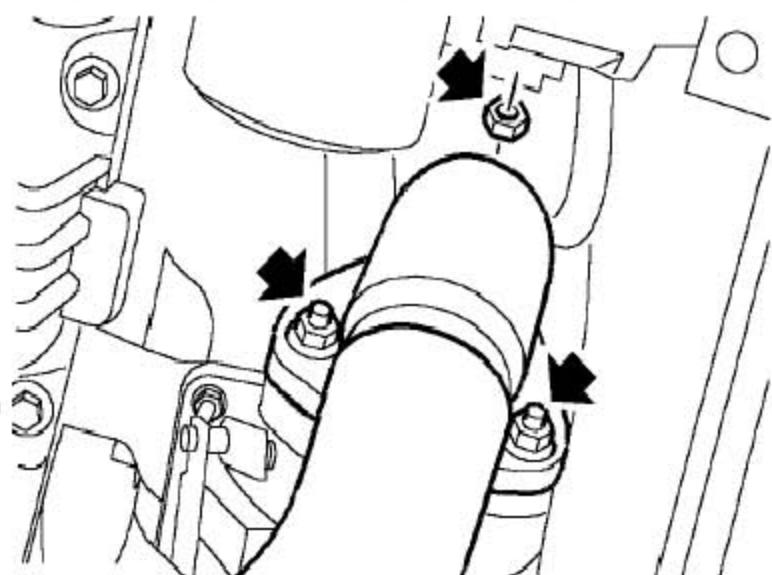
13). 针对1.8T车型：拆下把排气管固定到涡轮增压器上的3个螺母和螺栓。
