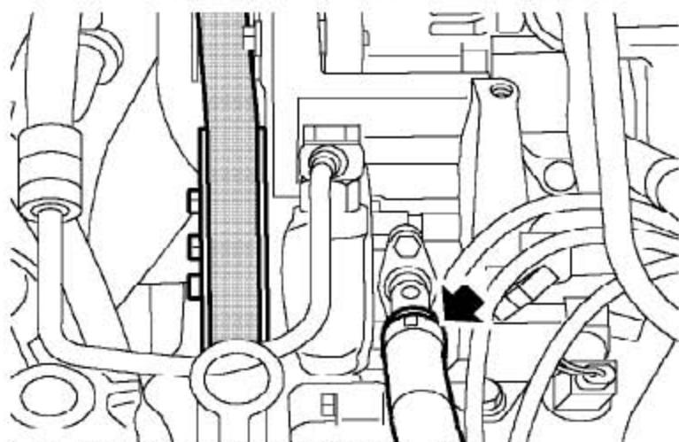
5). 松开动力转向泵进油软管的夹箍。
