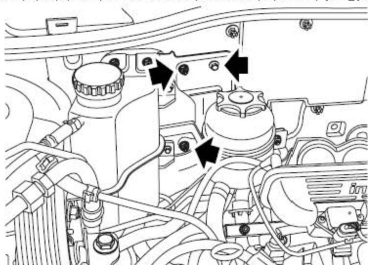
4). 针对1.8T车型：拧下把动力转向储液罐固定到支架上的2个螺母和1个螺栓，松开固定动力转向储液罐出油管和回油管的2个夹箍。
