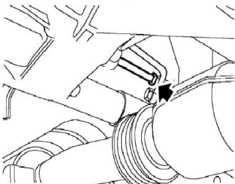
3). 拆下把动力转向机进油管固定到动力转向机上的对接螺栓，拆下密封垫圈并废弃。
