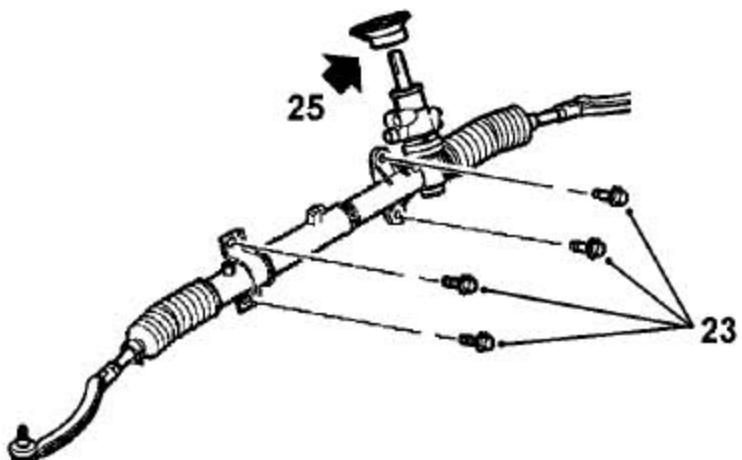
24). 拆下4个把动力转向机总成固定到前副车架总成上的螺栓。
