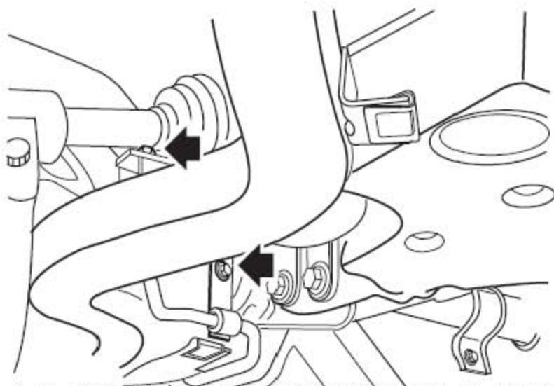
21). 拆下把动力转向机回油管固定到前副车架上的2个螺栓。
