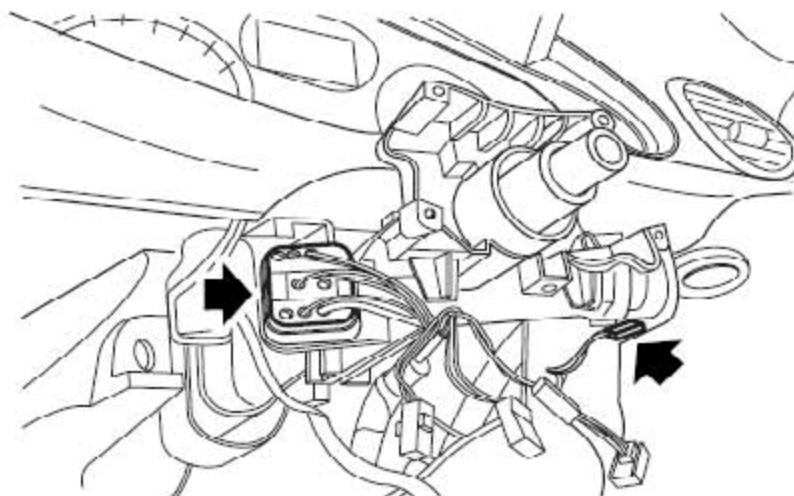
5). 断开点火开关和钥匙密码识别线圈的连接器。
