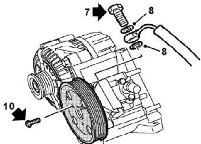
7). 从动力转向泵上拆下对接螺栓断开动力转向泵出油软管。
