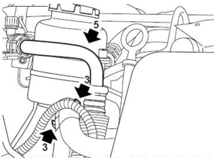
3). 松开动力转向储油罐出油管和回油软管的2个夹箍并废弃。
