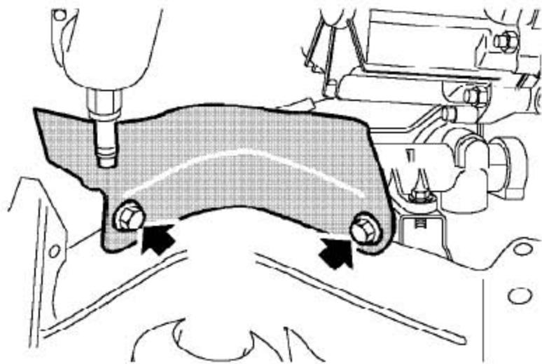
12). 拆下2个固定转向机隔热板的螺栓并拆下转向机隔热板。
