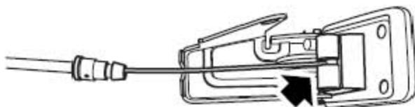
3). 松开连接到发动机罩开启拉手总成上的拉索总成。
