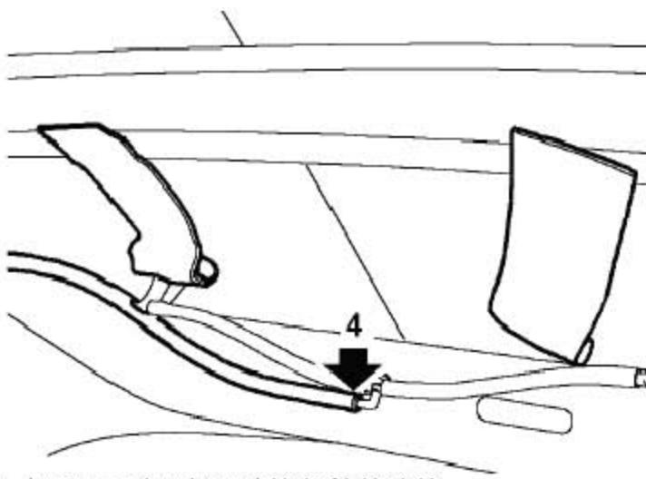
3). 从T形三通处断开洗涤软管的连接。
