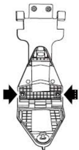
3). 拧开把三角警告牌塑料支架固定到三角警告牌金属支架总成的螺钉，拿开三角警告牌塑料支架。
