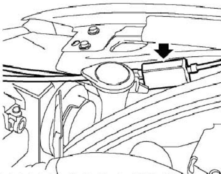
1). 从车身上拆下发动机罩开启连接块壳体。
