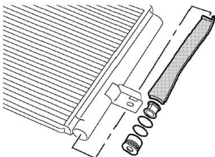
7). 从冷凝器上拆下螺塞。拆下并废弃掉O形圈。
