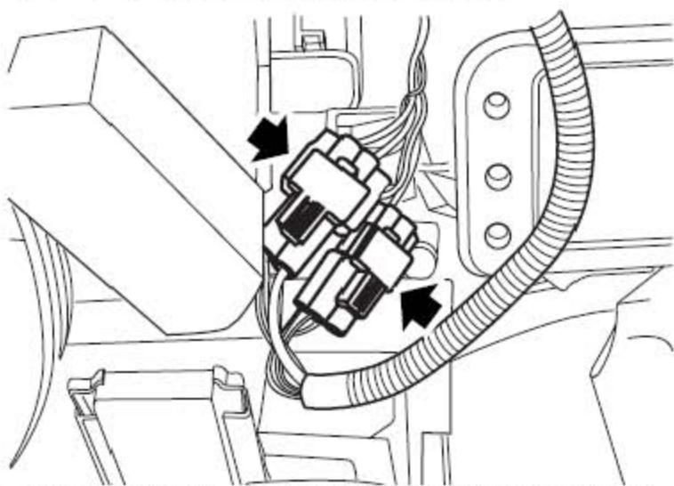
9). 在散热器的左端，断开2个冷却风扇的连接器的连接。
