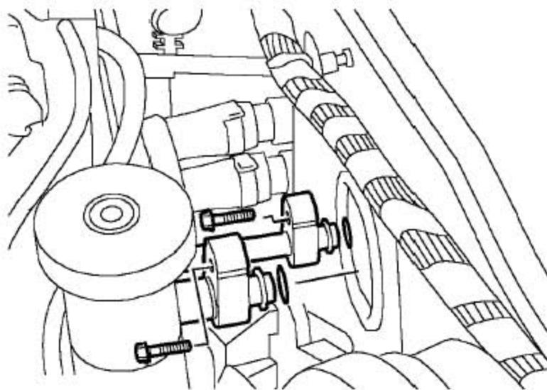
8). 拆下1个把空调管固定到蒸发器连接管总成上的螺栓，取下蒸发器到压缩机空调管A。
