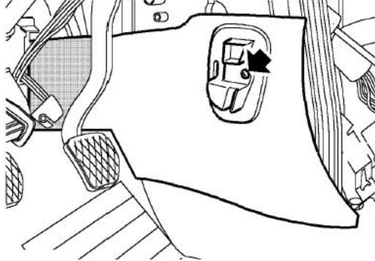
6). 拆下将前排出风口固定到暖风机上的螺钉。
