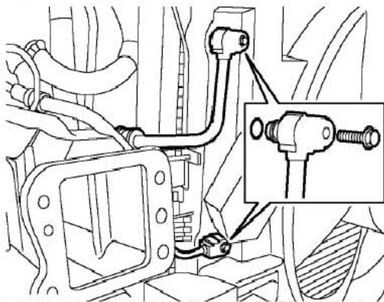
4). 拆下2个将空调管固定到冷凝器上的螺栓，从冷凝器上拆下两个空调管。
