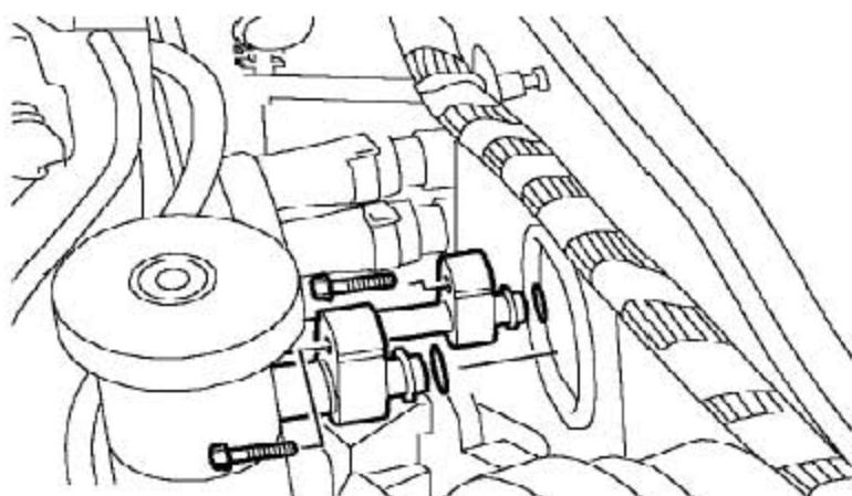
9). 拆下1个把空调管固定到蒸发器连接管总成上的螺栓，取下冷凝器到蒸发器管B。
