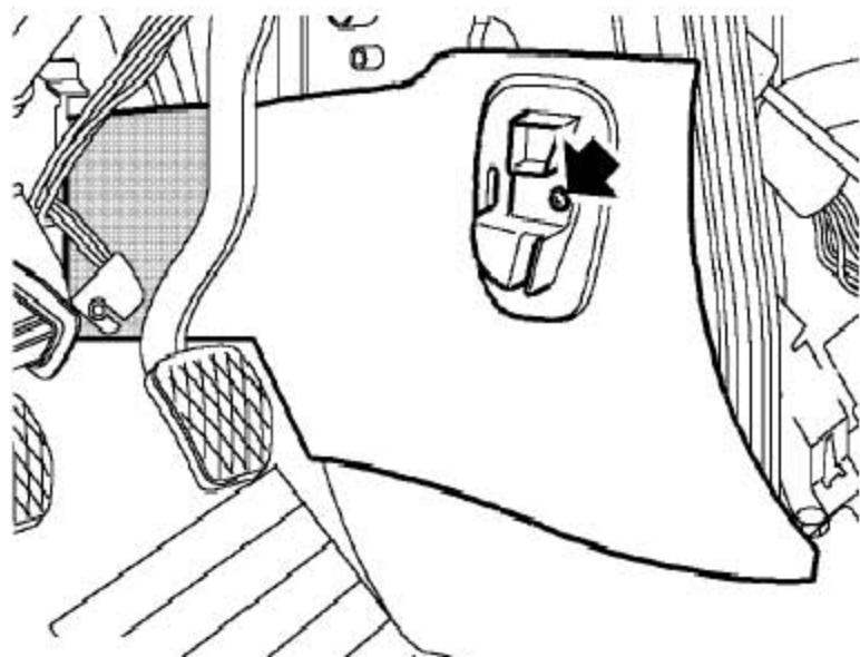
6). 拆下将前排出风口固定到暖风机上的螺钉。
