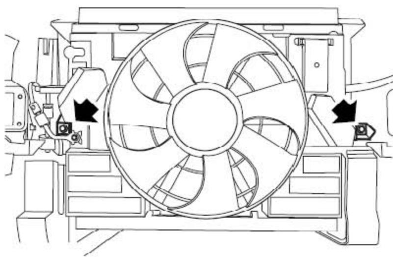
5). 拆下2个将风扇罩固定到散热器上的螺栓。
