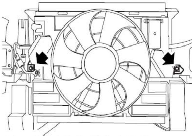
10). 拆下2个将风扇罩固定到散热器上的螺栓。
