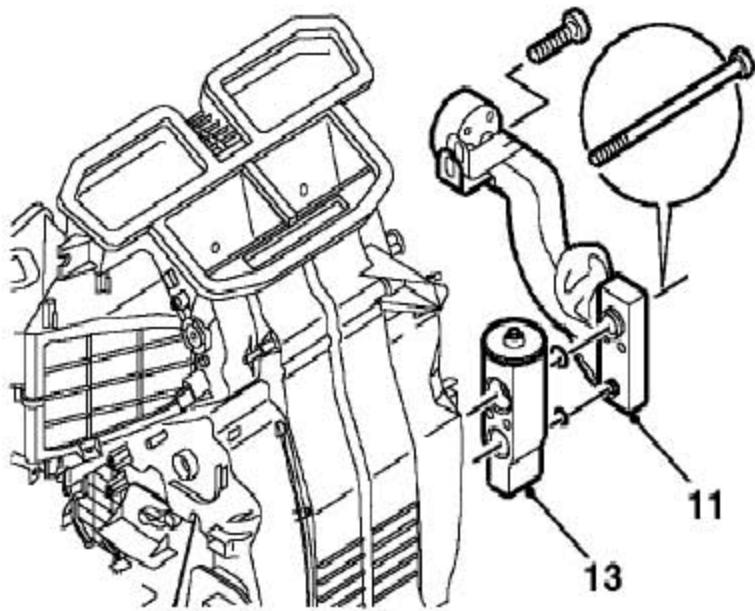
9). 拆下将蒸发器连接管固定到暖风机上的螺钉。
