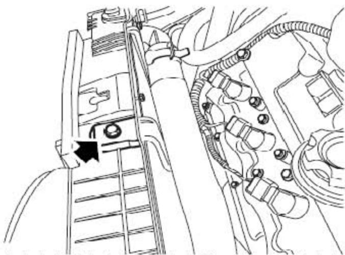
3). 从保持支架上松开顶部软管。拆下螺栓和保持支架。
