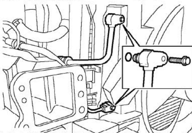
4). 拆下1个将空调管固定到冷凝器下侧管口的螺栓，从冷凝器上拆下空调管。
