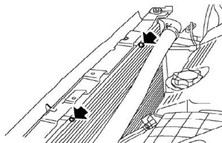
4). 拆下2个将冷凝器固定到散热器上的螺栓。
