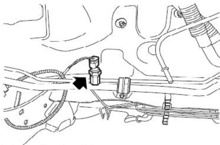
3). 断开压力传感器连接器。
