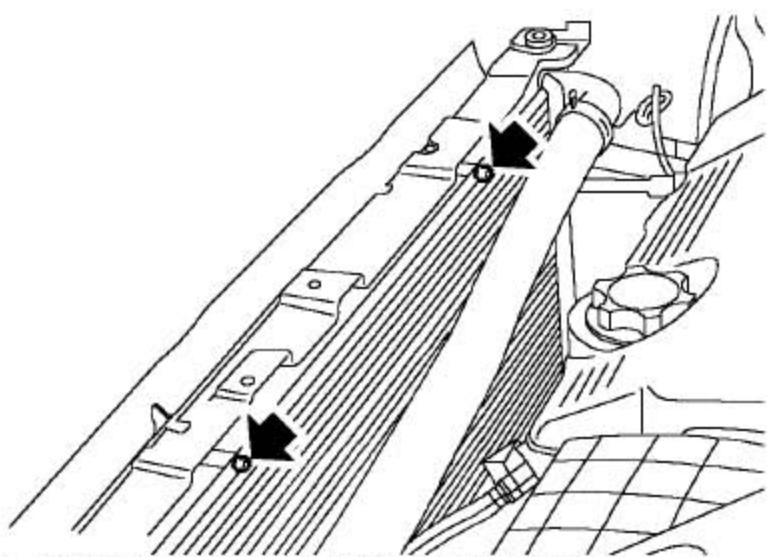
8). 拆下2个将冷凝器固定到散热器上的螺栓。
