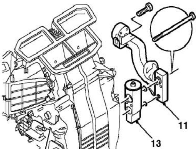
9). 拆下将蒸发器连接管固定到暖风机上的螺钉。
