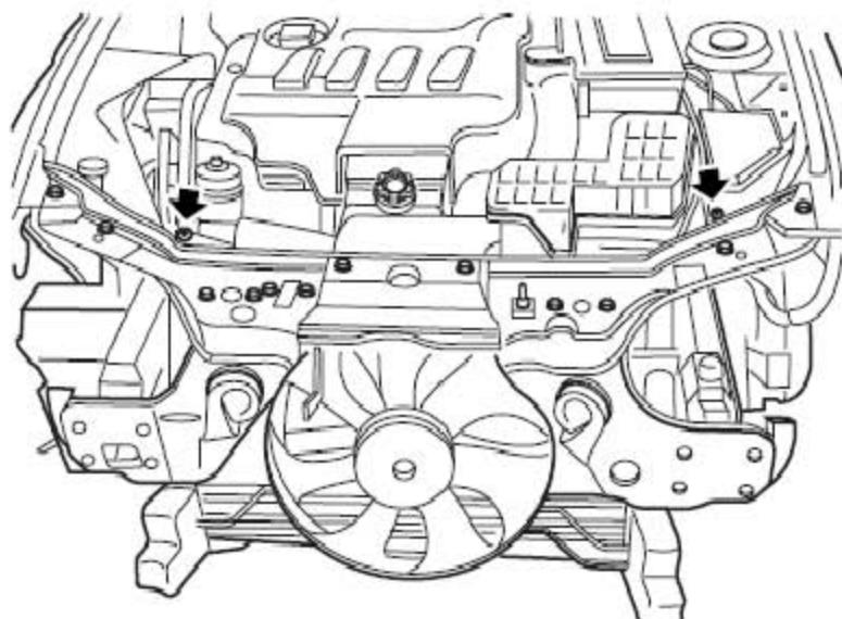
6). 拆下2个将风扇罩固定到散热器上的螺栓。
