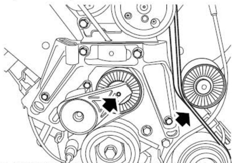
6). 松开辅助驱动皮带的张紧轮，从压缩机皮带轮上拆下驱动皮带。
