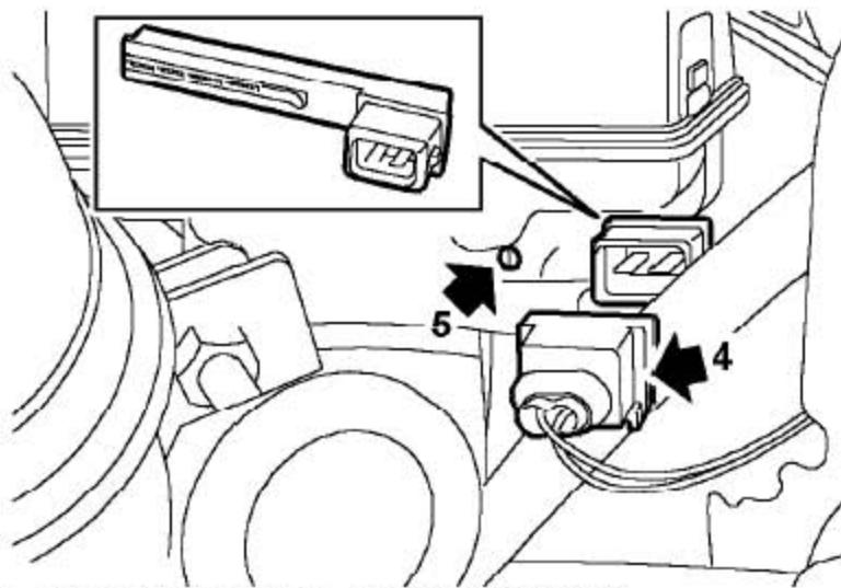
4). 从制动液液面开关上断开连接器的连接。
