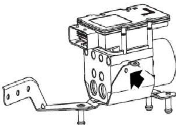
7). 拆下把DSC控制器模块固定到DSC调节器上支架上的3个螺栓。
