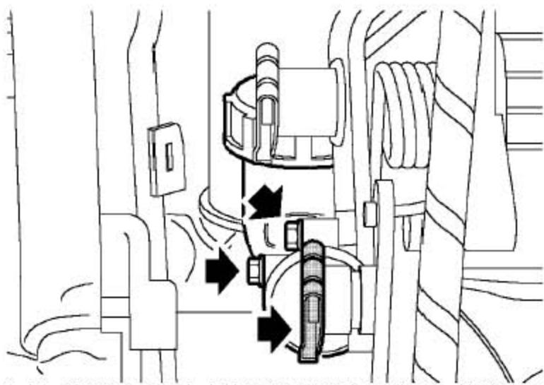
5). 拧下把离合器主缸推杆固定到离合器踏板上的簧片螺母。
