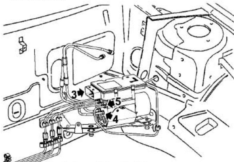
3). 从ABS调节器上断开连接器的连接。
