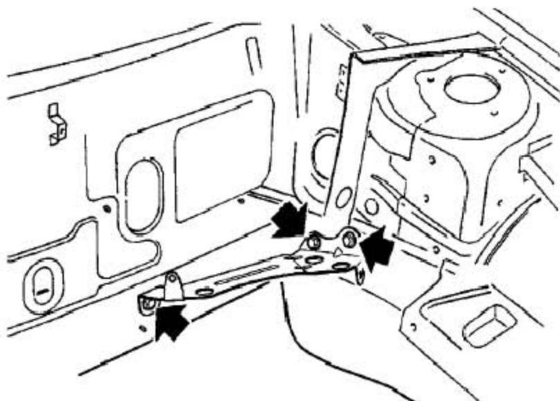
9). 拆下3个固定DSC调节器下安装支架到车身上的螺栓并取下DSC调节器下支架。
