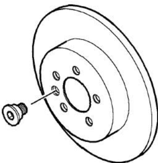
5). 拆下把后制动盘固定到后轮毂上的沉头螺钉。
