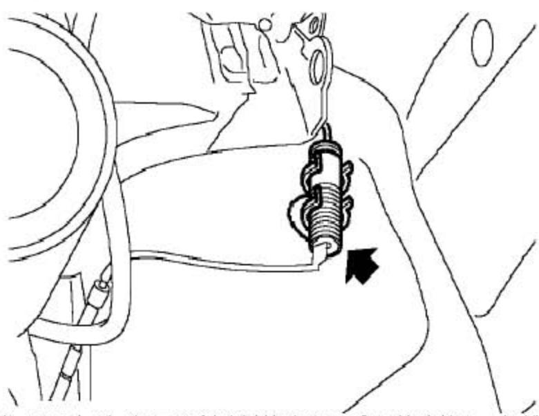
3). 只对右侧：断开后制动衬块磨损传感器的连接器。从排气螺钉帽、后轮ABS传感器导线上的夹子和后轮罩衬垫上松开后制动衬块磨损传感器导线。
