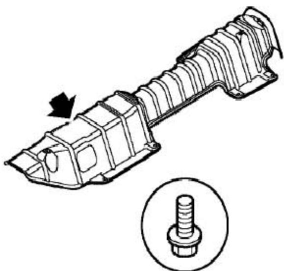
6). 拆下固定中央通道隔热罩的9个螺栓。
