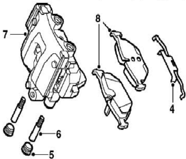
4). 从后制动钳壳体上拆下后制动钳止动弹簧。
