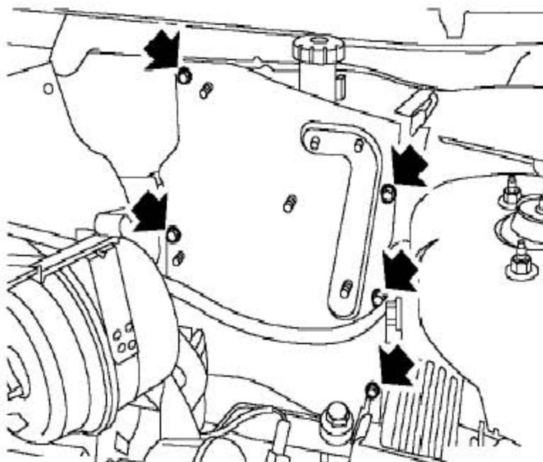
5). 拆下5个把驾驶员侧的辅助隔板固定到车身上的螺栓，取下辅助隔板。
