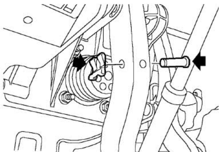
5). 拆下把真空助力推杆固定到制动踏板上的簧片螺母和杆销。
