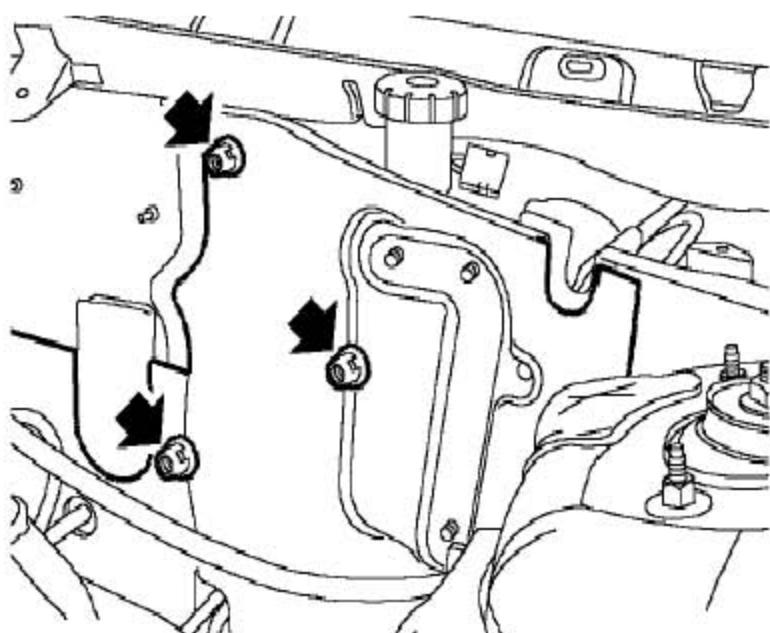
4). 拆下3个把隔音材料固定到驾驶员侧的辅助面板的螺母，取下隔音材料。
