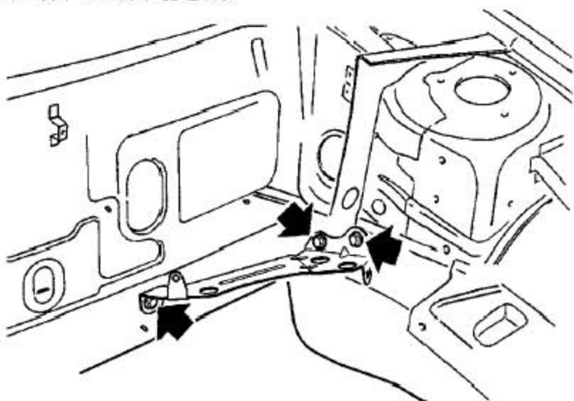
9). 拆下3个固定ABS调节器下安装支架到车身上的螺栓并取下ABS调节器下支架。
