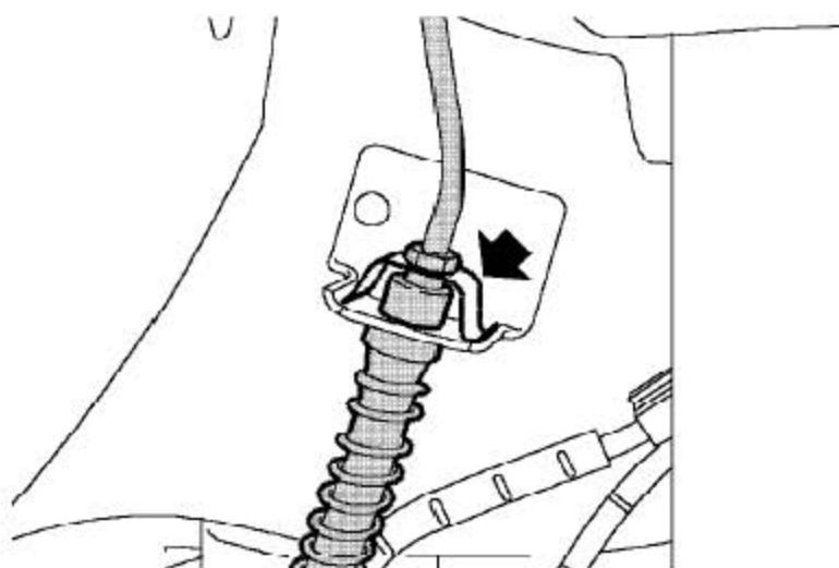
4). 断开翼子板内支架上的前制动管接头。从支架上拆下夹子并松开前制动软管。
