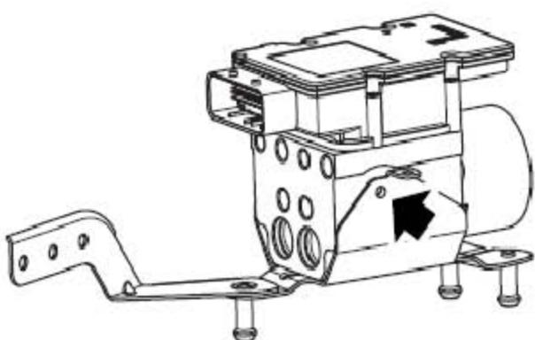
7). 拆下把ABS控制器模块固定到ABS调节器上支架上的3个螺栓。
