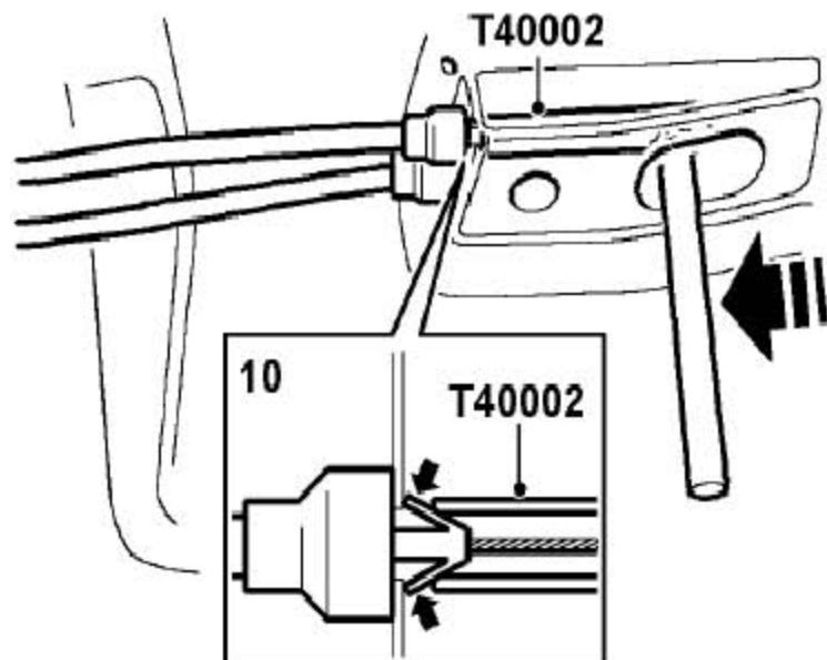
5). 用T40002压手制动后拉索卡扣，从地板上松开手制动后拉索总成。
