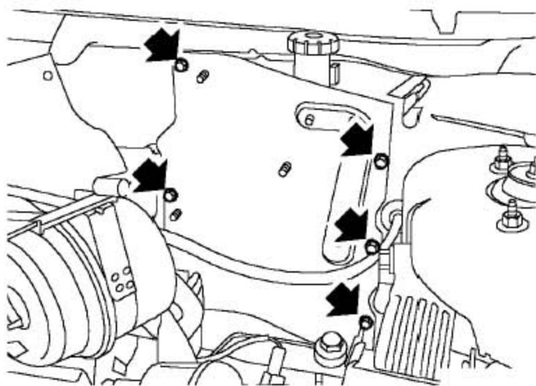
3). 拆下把驾驶员侧辅助隔板固定到车身上的5个螺栓，取下驾驶员侧辅助隔板。
