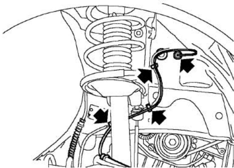
4). 只对右侧：从前轮罩护板上松开密封环，然后从夹子和减振器跨接支架松开前制动衬块磨损传感器的导线，拧下排空螺钉防尘帽。
