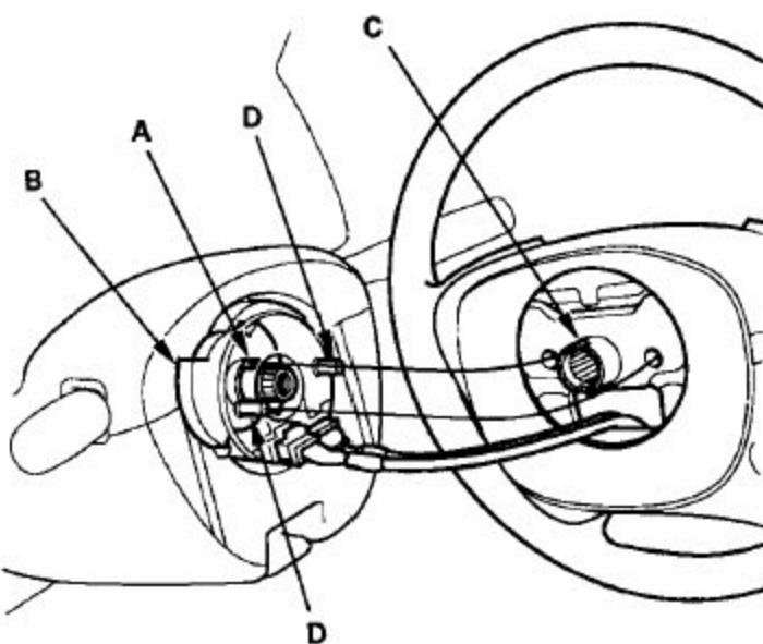
3). 安装方向盘螺栓（A），将其锁紧至规定扭矩。插接音响遥控开关插接器和巡航控制设置 / 恢复开关插接器（如有配备）。确认线束的布置和固定适当。
