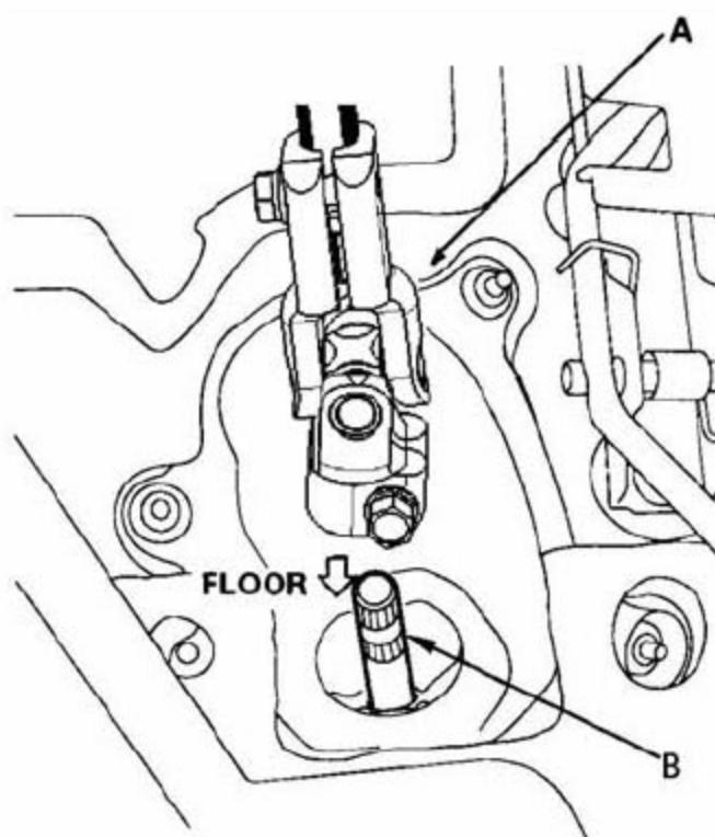
4).使齿条位于笔直向前的行驶位置，切断金属线，将转向球头的下端滑到小齿轮轴（B）上。
