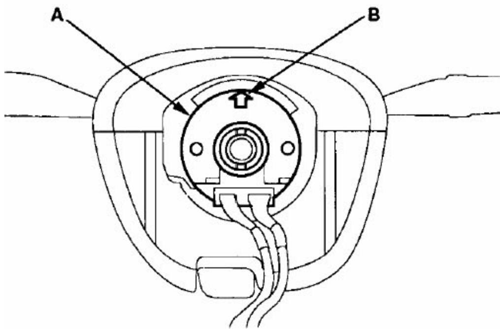
2). 如图所示，定位转向信号取消套筒（B）的两个凸耳（A）。将方向盘安装到转向柱轴上，确保方向盘毂（C）与转向线盘上的销（D）和取消套筒上的凸耳啮合。安装方向盘时，不要击打方向盘和转向柱轴。
