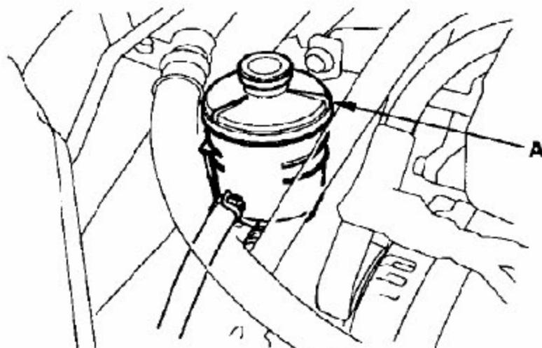
1).抬高储油罐，拆除回油软管（A），排空储油罐。注意不要使油液溅到车体或零件上。应立即擦去溅出的油。
