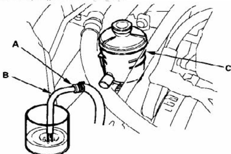
2).用一根直径相配的软管（B）来连接回油软管，然后，将软管的另一头放入一个合适的容器内。
