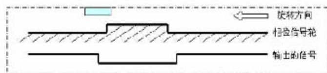
图 3-34 相位传感器工作示意图(一)
