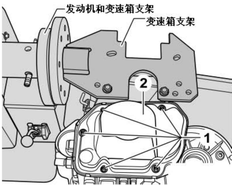
14). 沿(图中箭头所示)方向拉出 5 挡换挡拨叉(图中 2 所示)的支撑销(图中 1 所示), 取下 5 挡换挡拨叉(图中 2 所示)。
