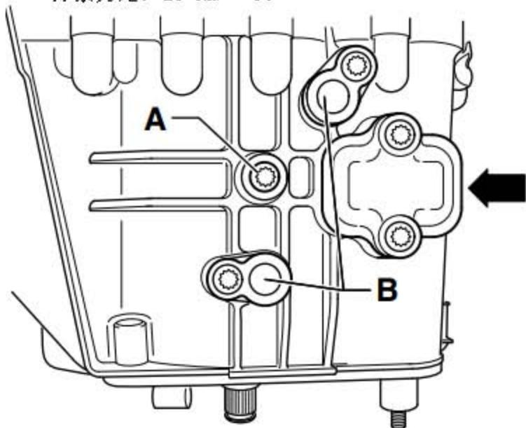
14). 将换挡机构的支撑销(图中B所示)安装在变速箱壳体上。
