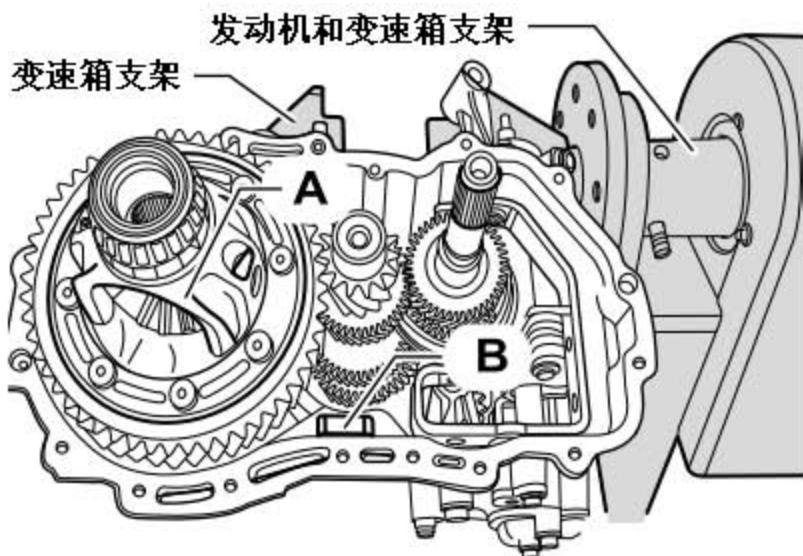
25). 将换挡轴置于空挡位置，旋出换挡轴的固定螺栓(图中箭头所示)，从变速箱壳体上向外拉出带盖板的换挡轴(图中 A 所示)。
