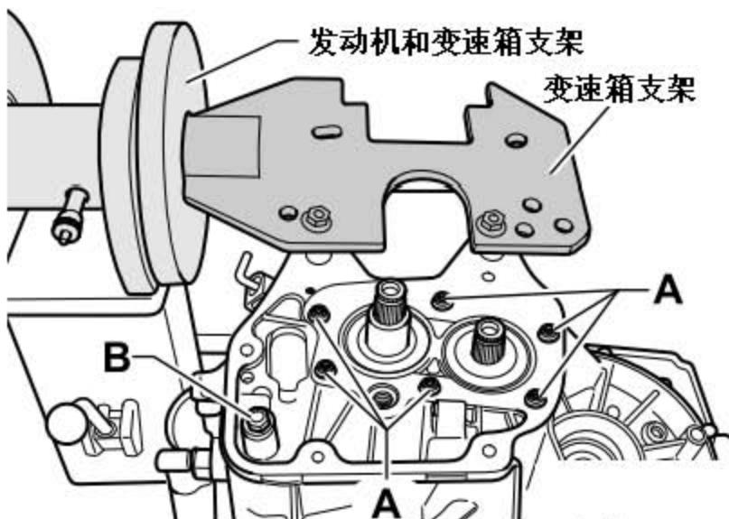
20). 拧紧换挡机构(换挡拨叉)六角凸缘螺母(图中 B 所示)。
