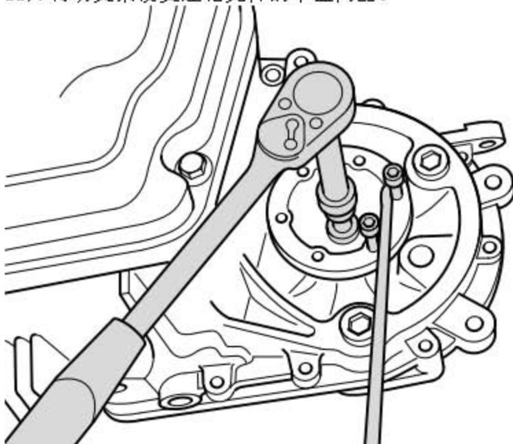
12). 旋出变速箱壳体罩盖的固定螺栓(图中 1 所示)。
