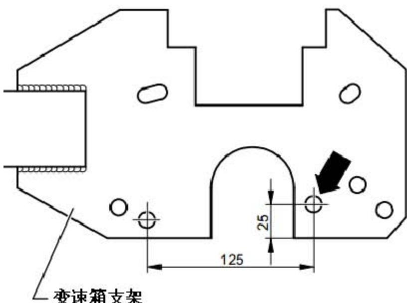
3). 将变速箱用螺栓(图中箭头所示)固定到变速箱支架上。
