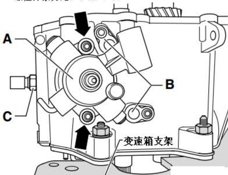
19). 用新螺栓(图中 A 所示)拧紧输入轴和输出轴的轴承座及深沟球轴承。
