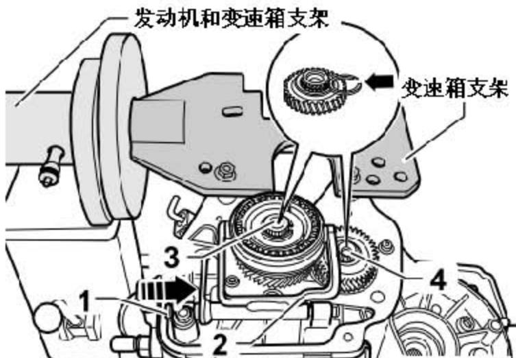
8). 安装变速箱壳体罩盖(图中 2 所示), 拧紧固定螺栓(图中 1 所示)。
