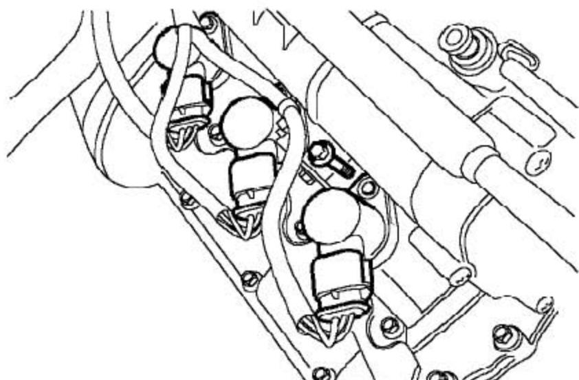
3). 拿开把线圈固定到右凸轮轴盖上的螺栓并拔出线圈。
