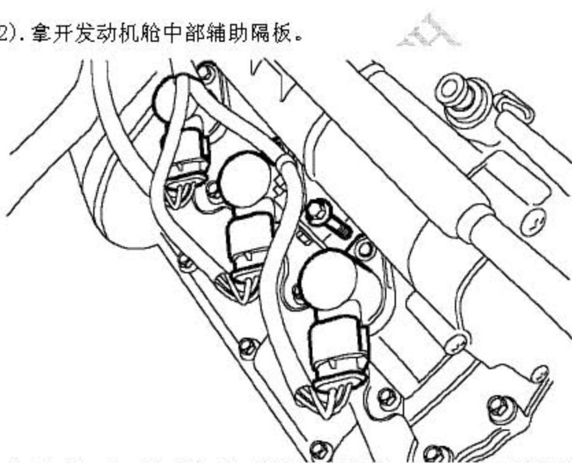
3). 只对右列：松开锁止夹并从点火线圈上断开连接器的连接。
