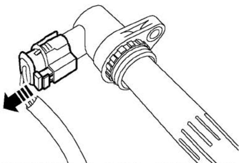
4). 滑开背部黄色的锁止夹，推下标签，从线圈上断开多用塞的连接。
