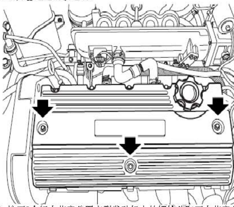
2). 拧下3个把火花塞盖固定到发动机上的螺栓并取下火花塞盖。
