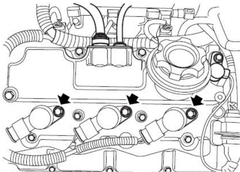
3). 拿开把线圈固定到左凸轮轴盖上的螺栓并拔出线圈。
