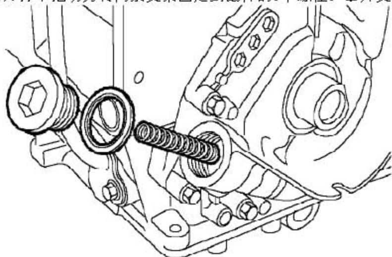
4). 取下释放阀的塞子和密封垫圈，废弃掉垫圈。
