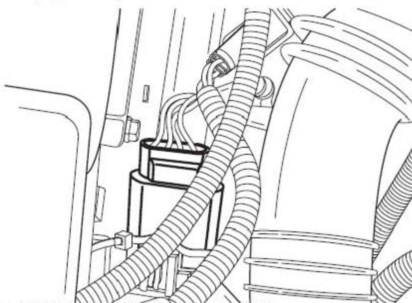
2). 松开并断开热氧传感器连接器的连接。
