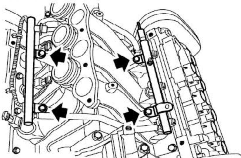
4). 拧下固定燃油轨到进气歧管的4个螺栓。
