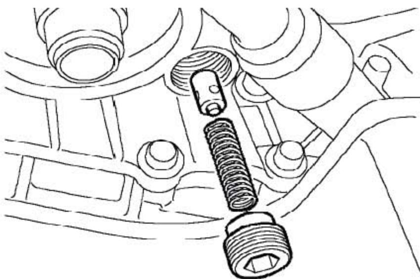
6). 拧下机油压力阀螺塞。
