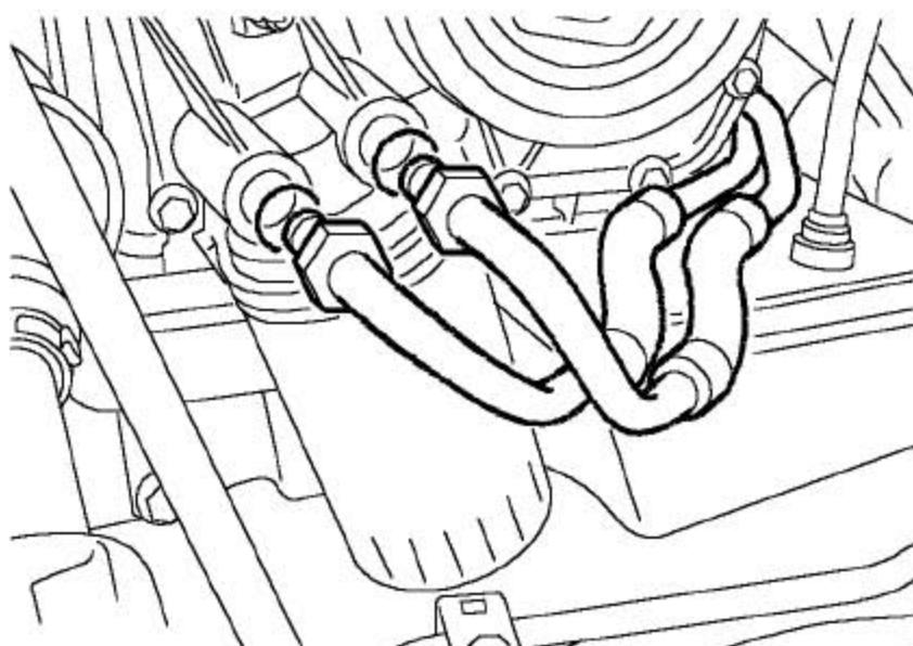
5). 从机油冷却管上拿开2个O形圈，并废弃。
