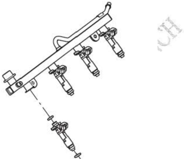
7). 从喷油器上断开连接器的连接。
