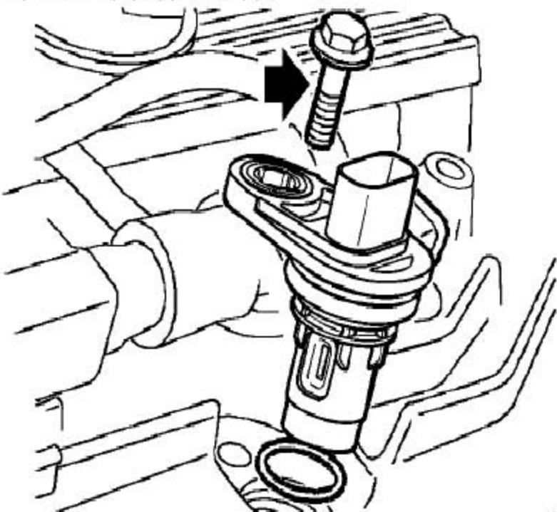
5). 拧下固定CMP传感器的螺栓并取下传感器。
