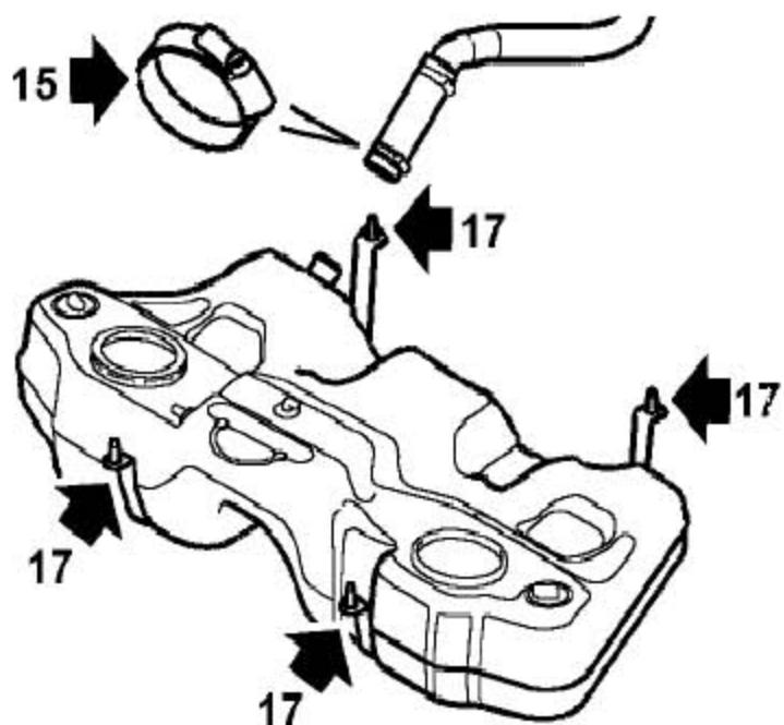
15). 松开把加油软管固定到燃油箱上的夹箍。从油箱上拿开软管。
