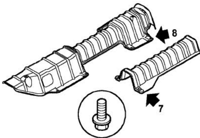
7). 拿开4个固定燃油箱隔热板的螺栓并拿开隔热板。
