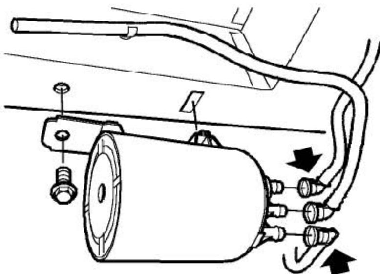
3). 拿开把炭罐固定到底盘上的螺栓并拿开炭罐。
