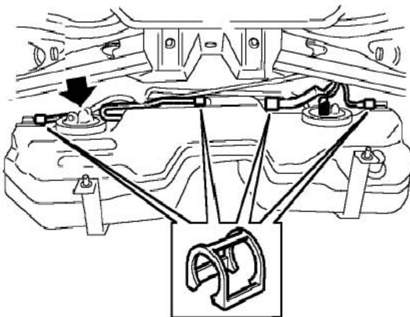
18). 从燃油泵上断开连接器的连接。
