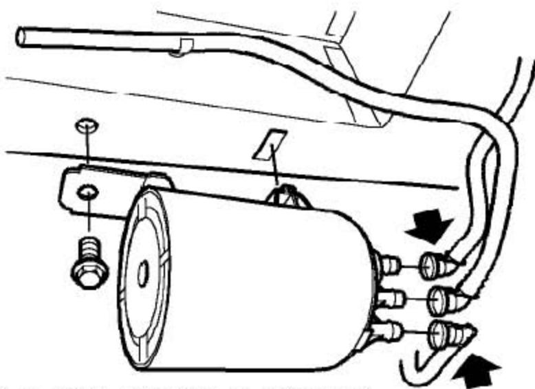
7). 拆开地板下燃油管总成与炭罐的连接。
