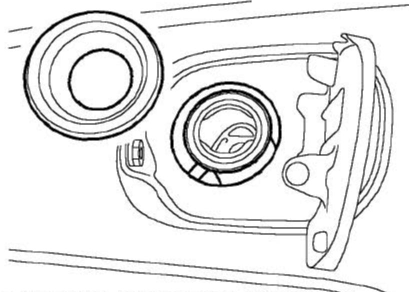
5). 拿开把燃油加油管注口固定到加注帽空隙的索环。
