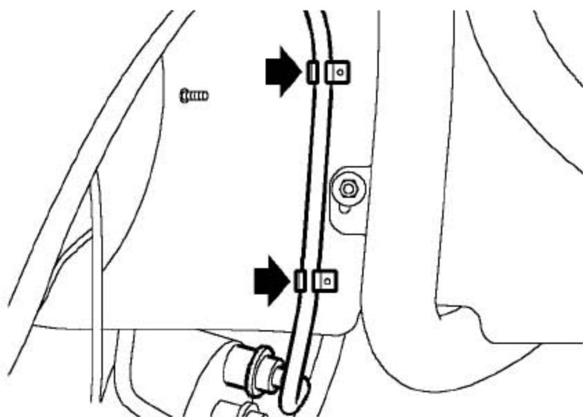
3). 断开炭罐管的连接，从2个卡扣上松开管子。
