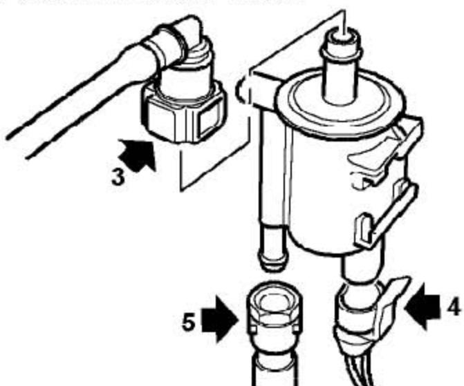
3). 从炭罐控制阀上断开真空软管的连接。
