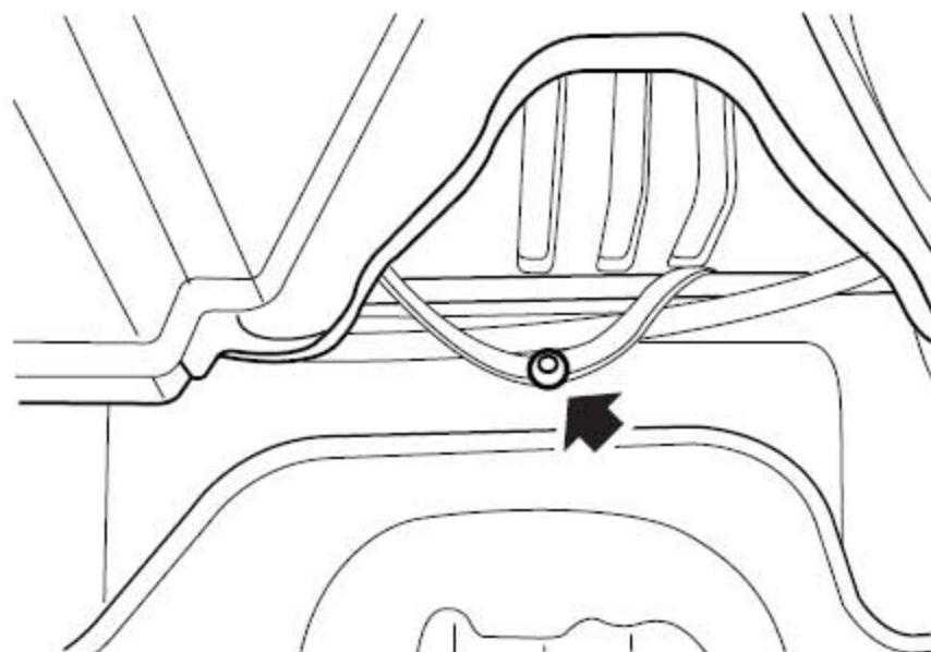
21). 松开把燃油管固定到油箱上的卡子并把管子固定到旁边。
