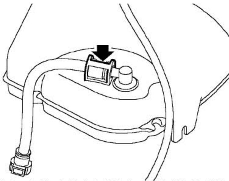
7). 拿开卡箍，从燃油膨胀箱上断开细燃油箱通气管的连接。
