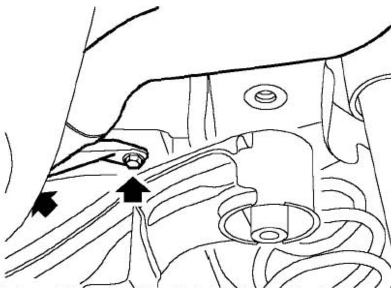
10). 拿开2个把加油管固定到车身上的螺栓并松开加油管。
