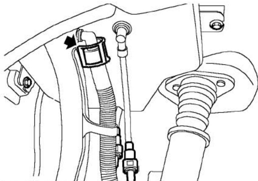
3). 拆下燃油箱通气管。
