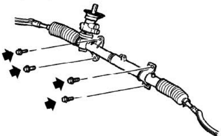
6). 拆下4个把转向机总成固定到前副车架总成上的螺栓并取下动力转向机总成。
