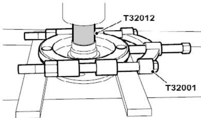
6). 用T32001和T32012，从驱动法兰上拆卸轴承内圈。
