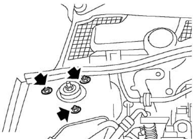
14). 拆卸3个把前减振器总成固定到车身上的螺母。
