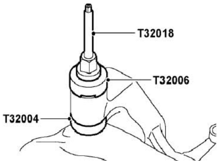
2). 用T32018, T32004和T32006装上新的前副车架橡胶衬套。
