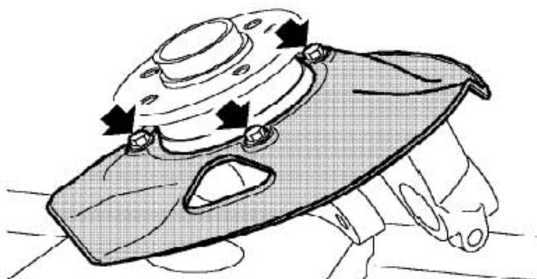
2). 拆下3个固定前制动盘护板的螺栓。
