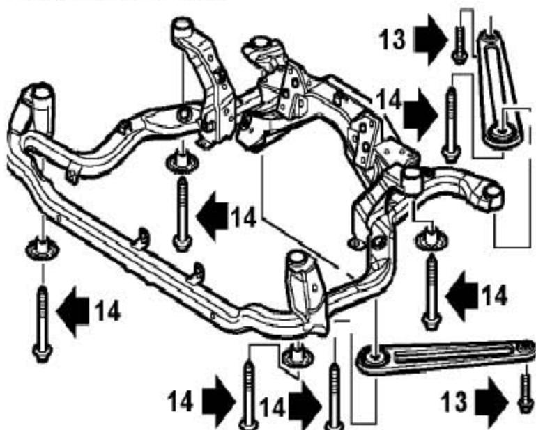
13). 拆卸2个把前副车架支撑杆固定到车身上的螺栓并废弃。
