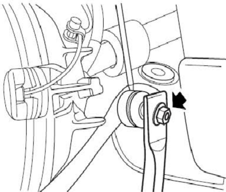
4). 用一开口扳手卡住前横向稳定杆连接杆，以防止前横向稳定杆连接杆球节转动。拆卸固定在前横向稳定杆连接杆上的螺母，并从前横向稳定杆上松开前横向稳定杆连接杆。
