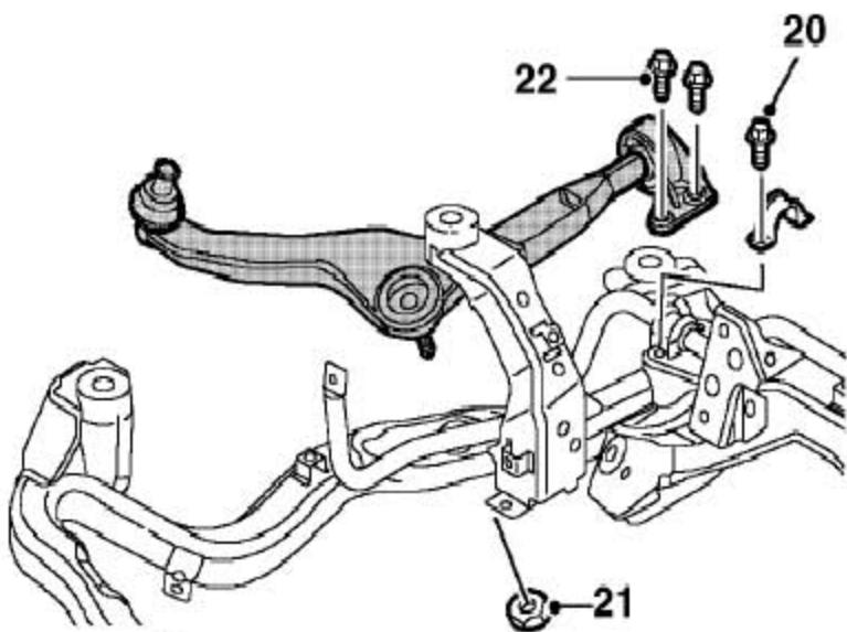
20). 拆卸4个固定前横向稳定杆固定支架螺栓，拆下前横向稳定杆总成。
