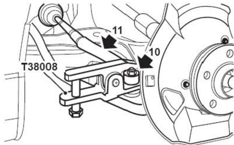
10). 拆下把转向横拉杆固定到转向臂上的螺母，给转向横拉杆球节装上一个M10的螺母，与转向横拉杆球节端头平齐。
