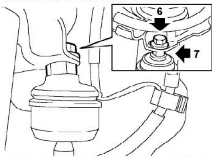
6). 用开口扳手卡住横向稳定杆连接杆，以防止前横向稳定杆连接杆转动，拆下把前横向稳定杆连接杆固定到前减振器柱上的螺母。
