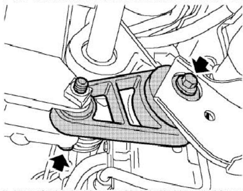
8). 拆下2个固定发动机下后系杆的螺栓并拆下发动机下后系杆。
