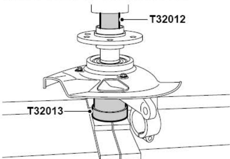
5). 在工具T32013上支撑住前轮毂轴承，用T32012把驱动法兰压进前轮毂轴承。
