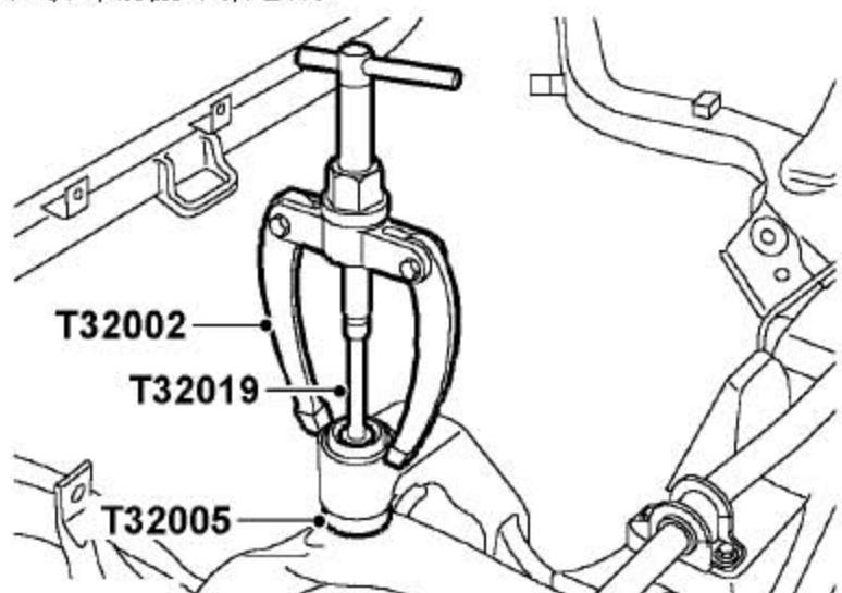
2). 把T32019装到T32002上，用T32005拆下前副车架橡胶衬套。
