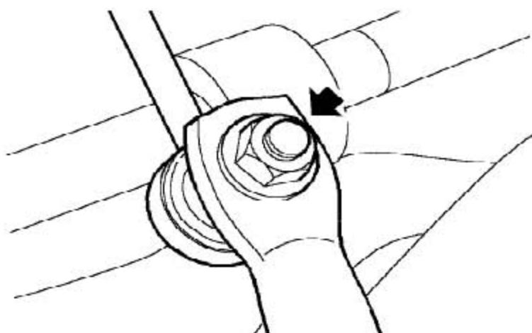
4). 拆下固定前横向稳定杆连接杆到前稳定杆的螺母。
