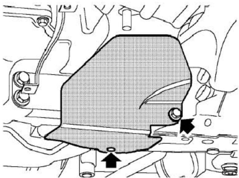
7). 拆下螺栓并松开把转向横拉杆隔热板固定到前副车架总成的夹子。
