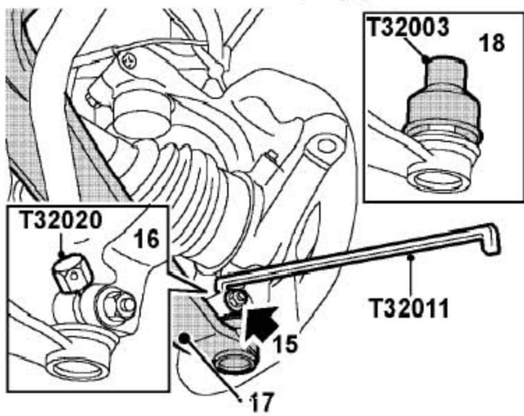
15). 拆下把前下摆臂外球节固定到前轮毂上的螺母和螺栓。
