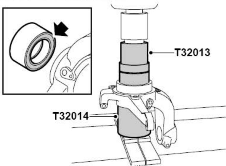
2). 在工具T32013上支撑起前轮毂，用T32014压进新的轴承。
