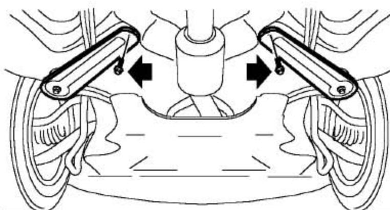
8). 拆下2个把前副车架支撑杆固定到车身上的螺栓并废弃。
