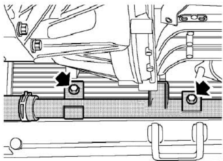
6). 拆下2个把底部软管的连接管固定到前副车架总成上的螺栓。
