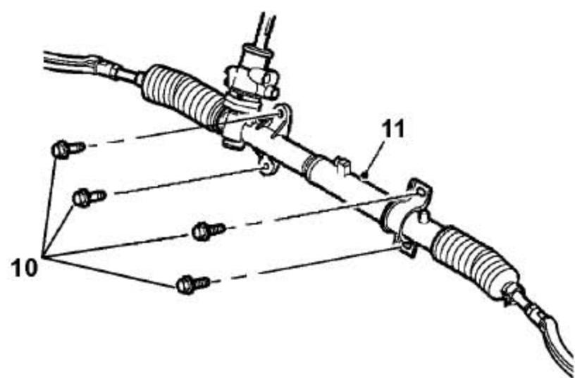
10). 拆下4个把动力转向机固定到前副车架总成上的螺栓。
