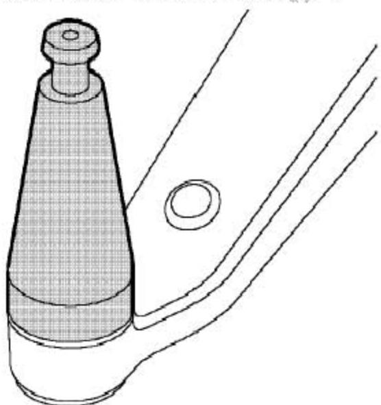
5). 穿过新的前下摆臂外球节护套安装下弹簧卡环导向工具并固定。
