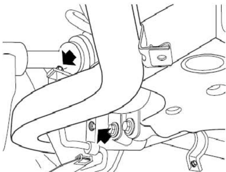
5). 拆下把动力转向机回油管支架固定到前副车架总成上的2个螺栓。
