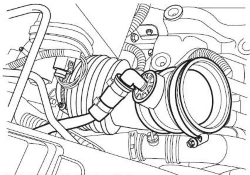
1). 从节气门进气管上断开发动机呼吸管。
