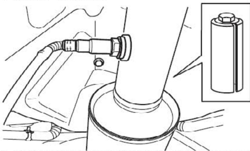
5). 松开并断开热氧传感器连接器的连接，用T16001取下热氧传感器。
