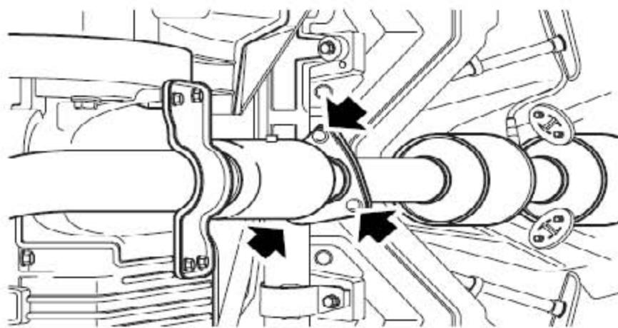
5). 拧下3个把前排气管固定到排气系统上的螺母。
