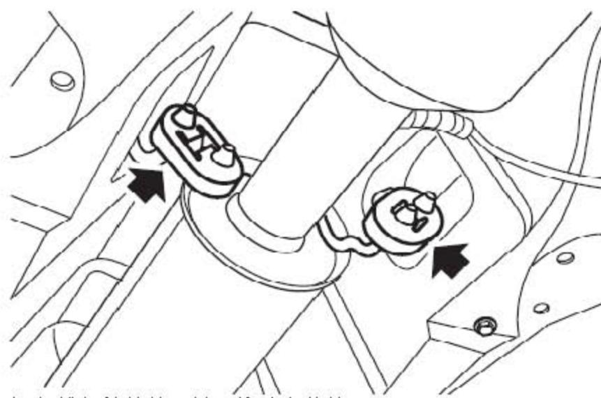
7). 从排气管的前面松开橡胶安装件。
