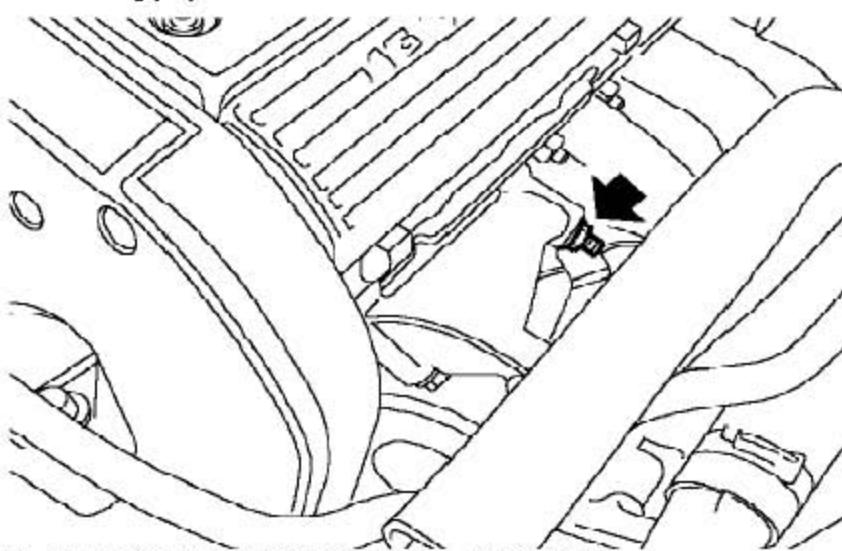
1). 拧下把隔热板固定到发电机上支架的螺母。
