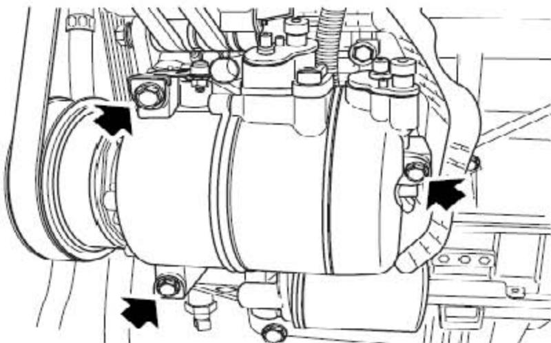
4). 拧下把空调压缩机固定到发动机上的3个螺栓。
