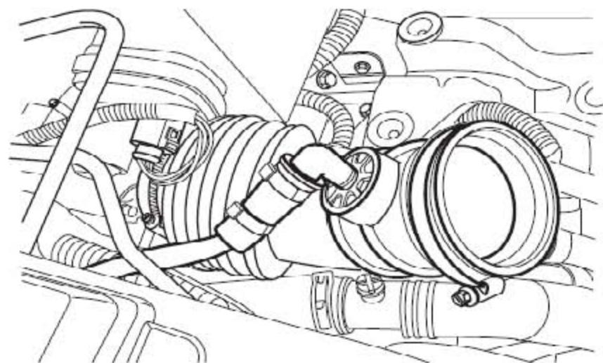
2). 松开把空气进气软管固定到空气滤清器总成上的夹箍。
