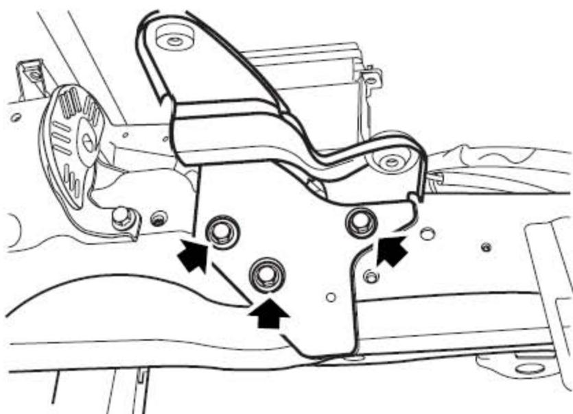
2). 拧下固定空气滤清器支架的3个螺钉，并拿开支架。
