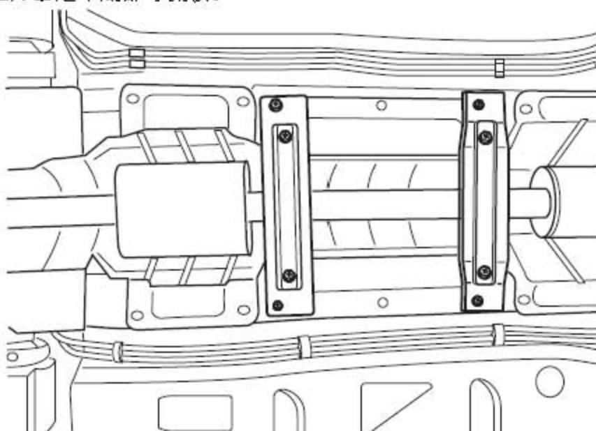
3). 拿开固定2个中央通道板的8个螺栓并拿开跨接支架。
