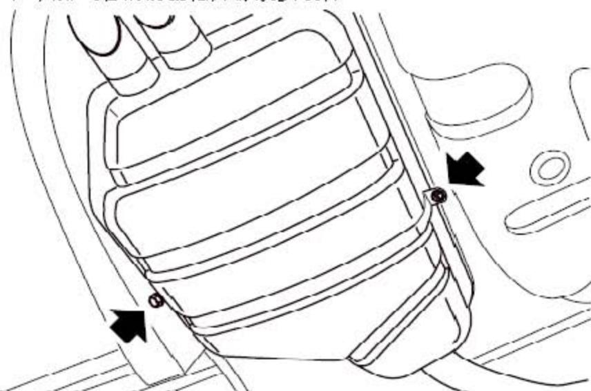
8). 从后消音器安装支架上拧下螺栓，收集好安装支架。
