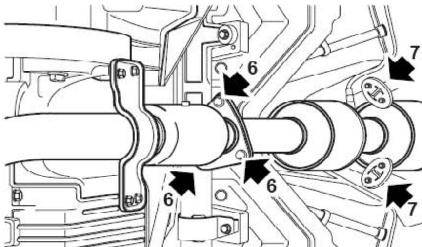
6). 拧下3个把前排气管法兰固定到排气系统上的螺母。
