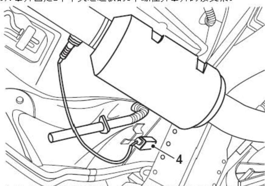
4). 松开并断开催化转化器后面的后热氧传感器连接器的连接。
