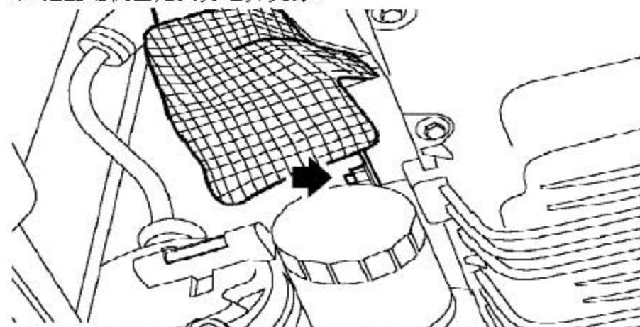
6). 从隔热板上拧下固定到发电机下支架的螺栓并拿开隔热板。
