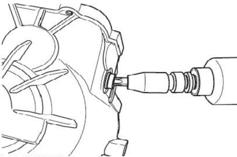
2). 拆下倒档螺栓。
