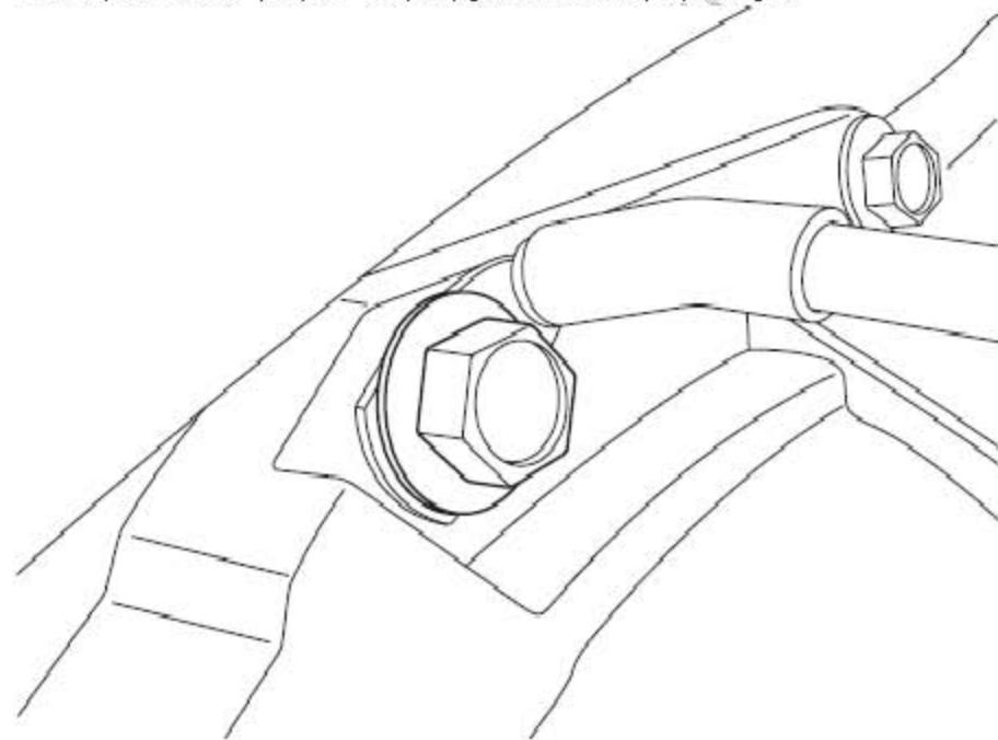
19). 拆下固定蓄电池接地线的变速器壳体螺栓，松开接地线并放在旁边。
