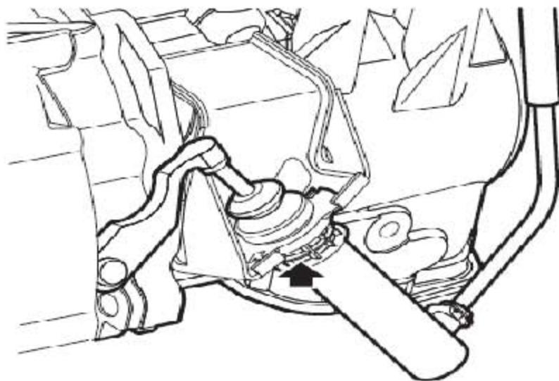
16). 松开将离合器从动缸固定到支架上的卡扣，松开从动缸并废弃剩余的扎带。
