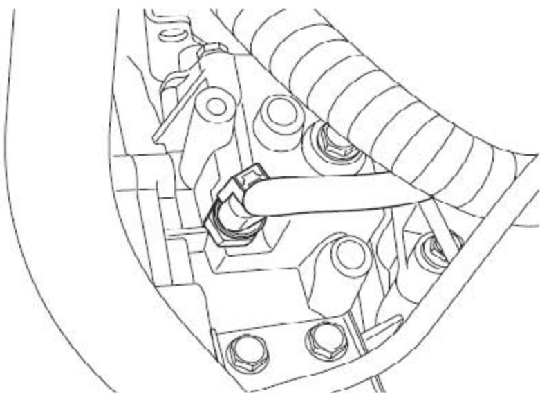
4). 断开倒车灯开关连接器
