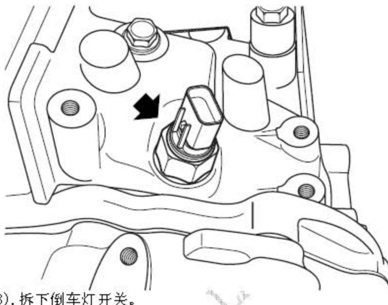
3). 拆下倒车灯开关。
