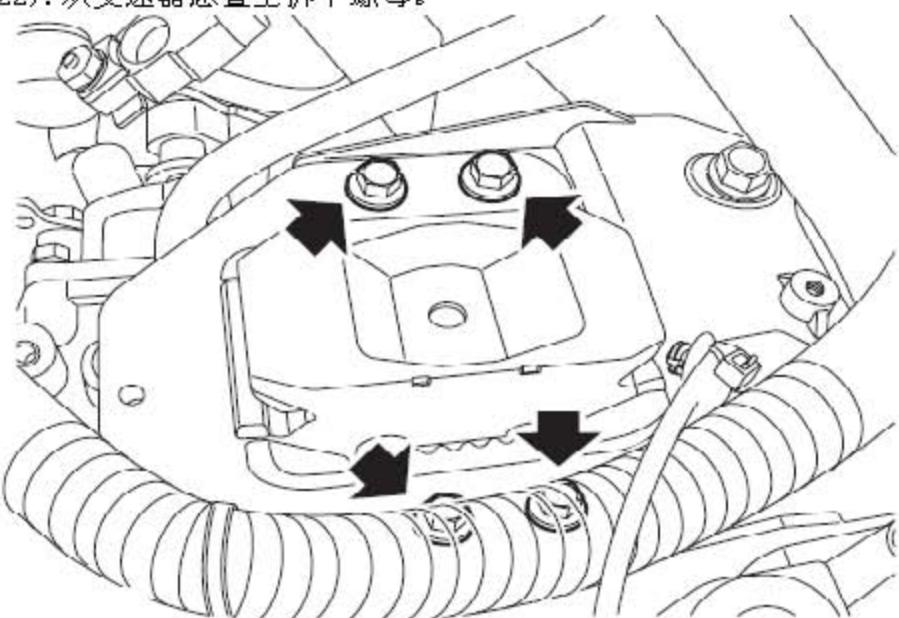
23). 拆下4个螺栓和变速器悬置安装支架。
