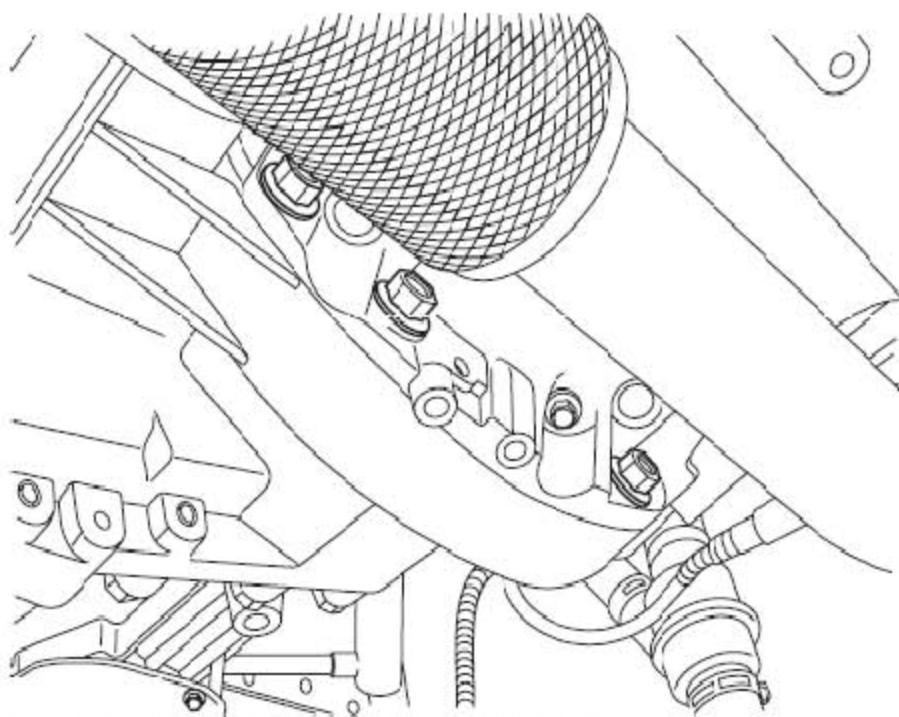
17). 从变速器壳体底部上拆下3个法兰螺栓。
