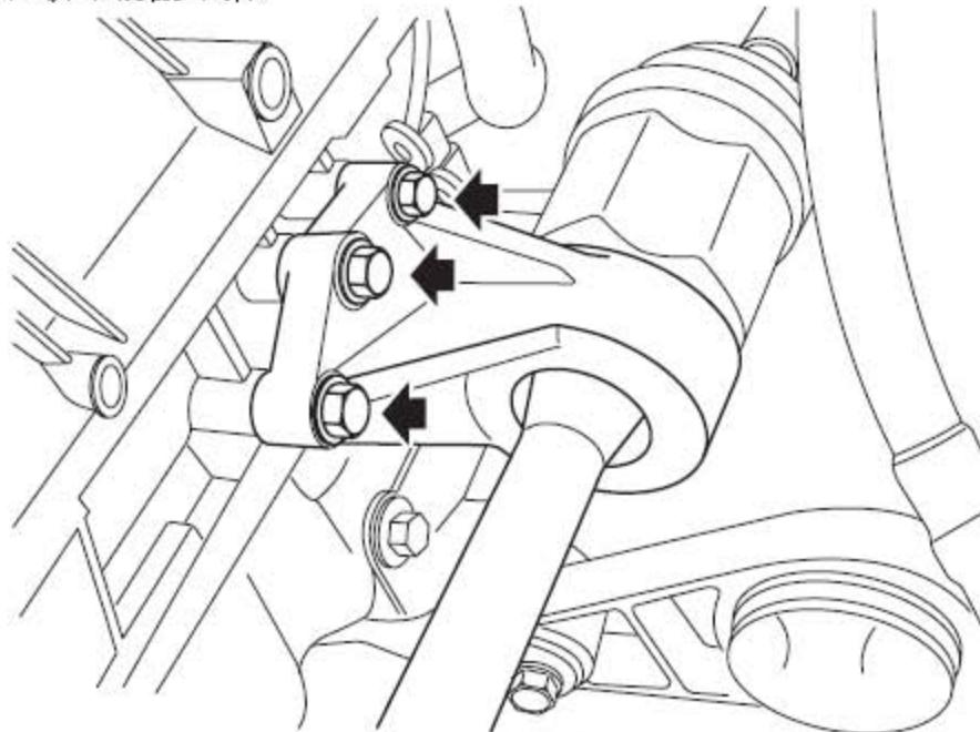
10). 拆下将右侧驱动轴支架固定到缸体上的3个螺栓。
