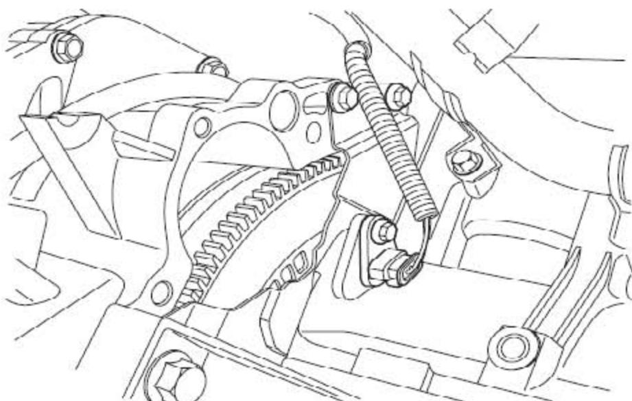
14). 从变速器后部封闭板上拆下2个螺栓并拿开后封闭板。
