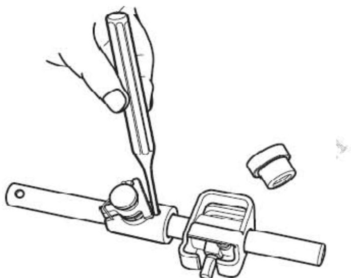
7). 取下5/R档复位弹簧，互锁环，选换档拨头，倒档保险块总成，1/2档复位弹簧，弹簧档片，滚针轴承，油封，换档摇臂总成，尼龙块，通气塞等。
