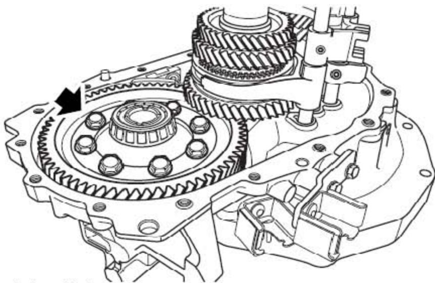
10). 拆下差速器总成。
