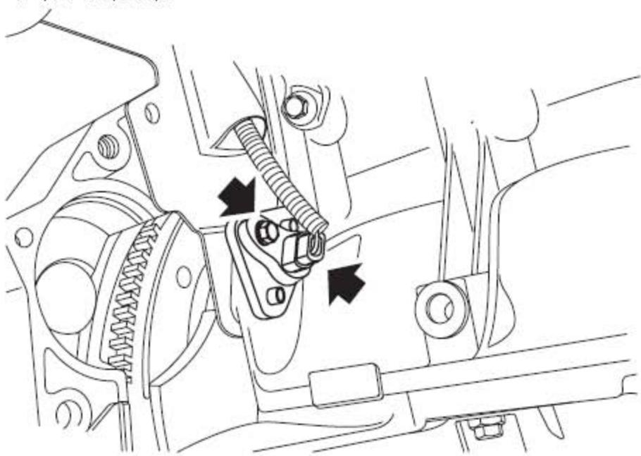
13). 拆下固定曲轴位置 (CKP) 传感器的螺栓并将传感器放在旁边。
