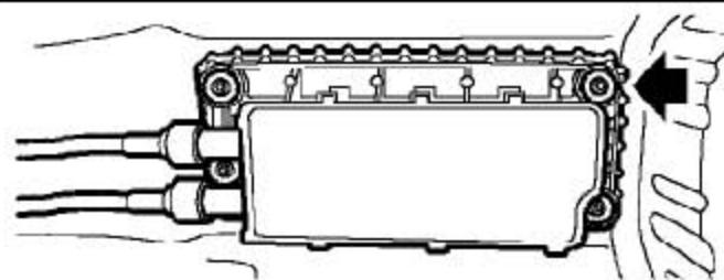
7). 拆下4个把换档机构固定到车身上的螺栓组合件，从地板上拆下换档机构。
