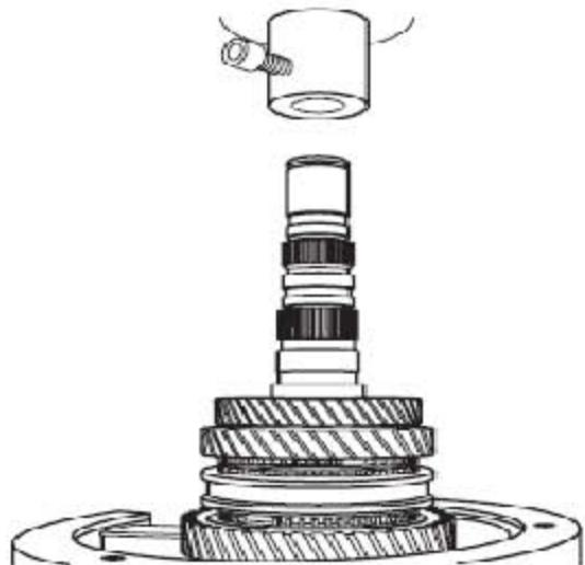
9). 压机压下从动轴1档齿总成，同步器总成，2档齿总成及3档齿总成等。
