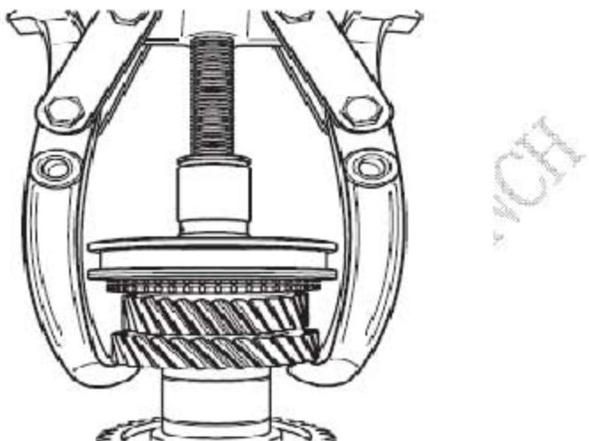
7). 用T32001同时拉出四档齿、五档齿滚针轴承内圈和同步器等。
