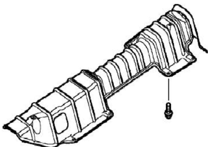
6). 拆下固定排气通道隔热板的螺栓。
