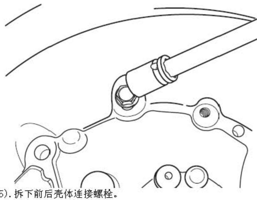
5). 拆下前后壳体连接螺栓。
