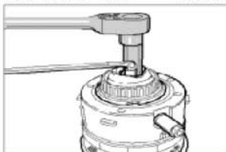
拆卸/安装减震器支座
