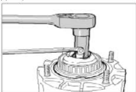
拆卸/安装减震器支座
