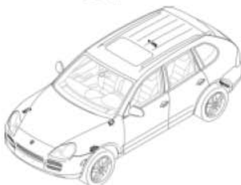
轮胎压力监测系统控制单元概图
