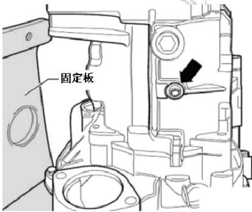
29). 将换档轴调节到怠速位置，拆下换档轴及其换档杆盖。接着旋出螺栓（图中箭头所示）并将换档轴从变速箱壳中拉出。
