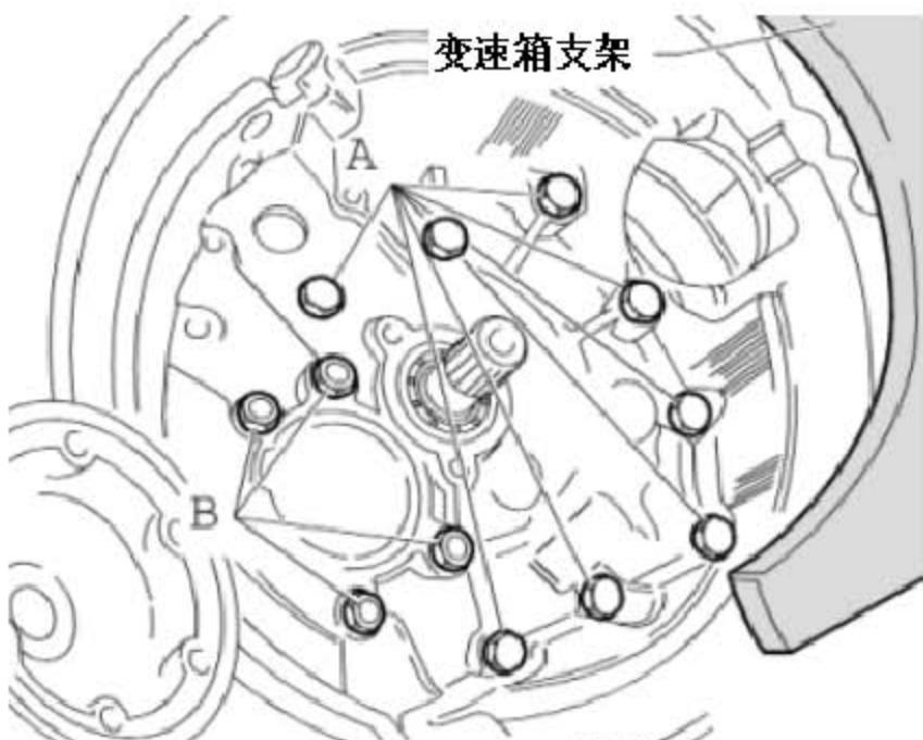
32). 拆卸差速器区域内的变速箱上表面的轴颈（图中 A 所示）以及离合器壳上的变速箱壳体固定螺栓（图中 B 所示）。
