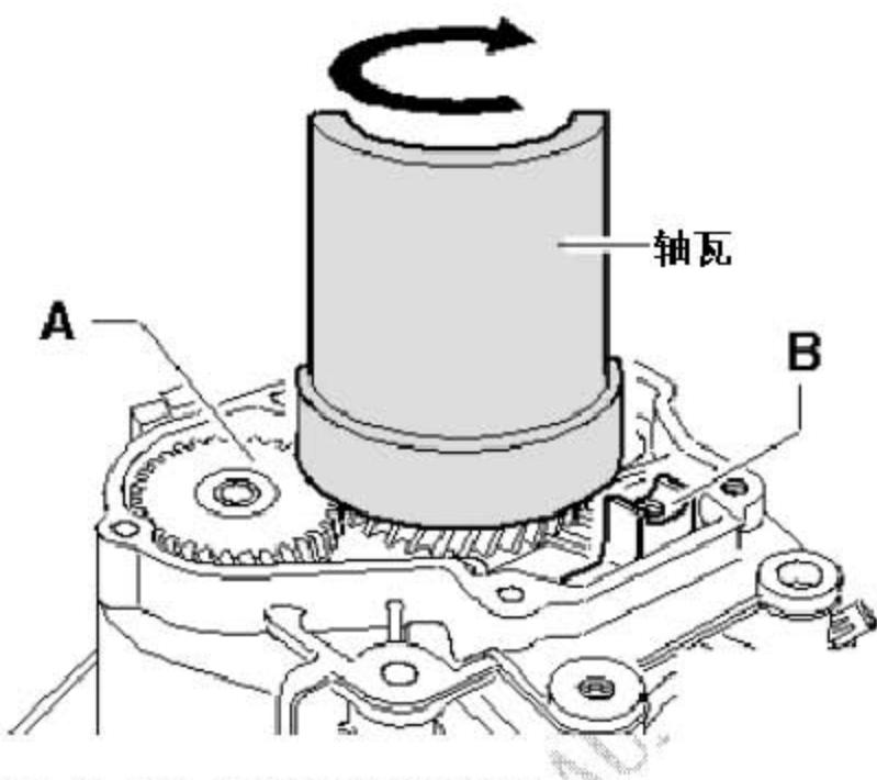
18). 将 内嵌式螺纹件放置到轴瓦中。
