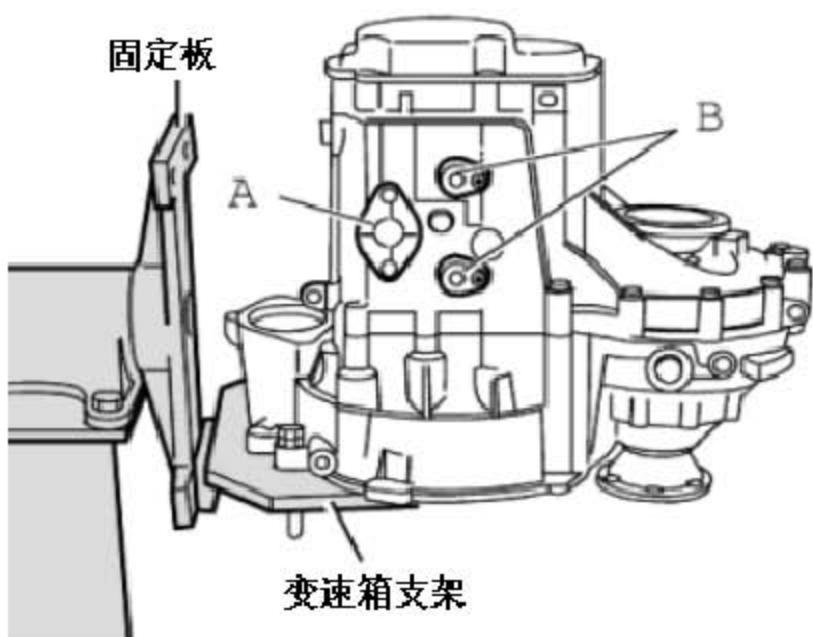
31). 拧下离合器壳上用于固定变速箱壳体的螺栓（图中 A 所示）。
