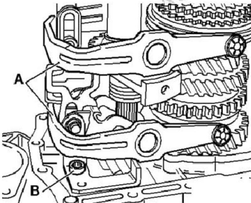
36). 拧下轴承托架/从动轴的螺母 (图中 B 所示)
