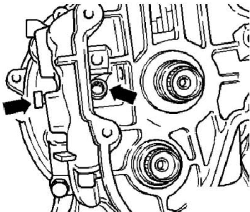
28). 现在拆下支座 / 倒车齿轮轴的第 3 个螺栓 (图中箭头所示)。
