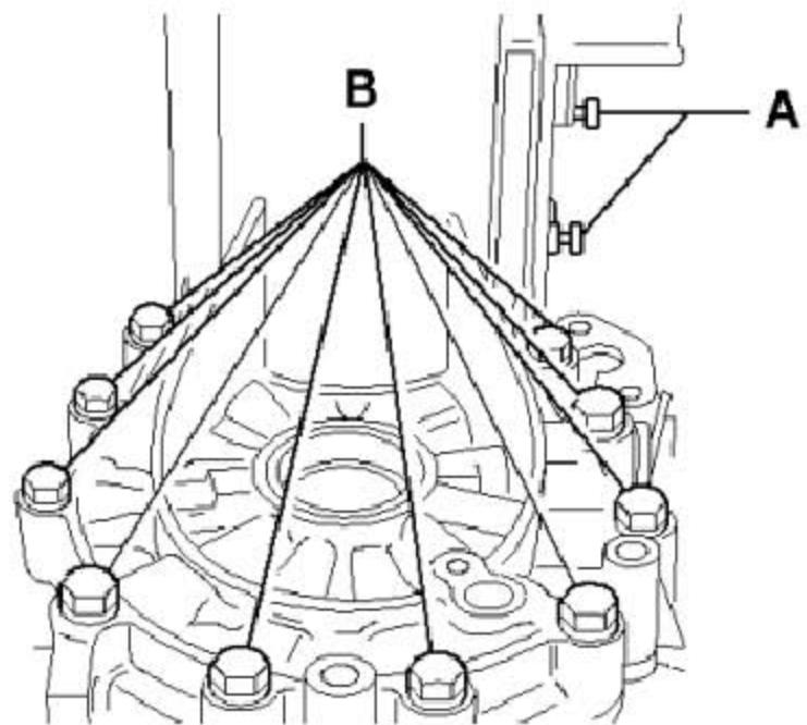
33). 取下变速箱壳体, 必要时小心地交替撬动四周突出的壳体凸台(图中箭头所示), 同时注意不要损坏密封面。
