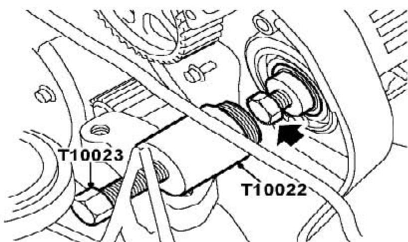
6). 把固定凸轮轴带轮的螺栓装到凸轮轴上。
