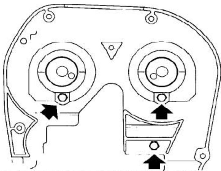
15). 拧下把正时带后上盖固定到发动机上的螺栓。
