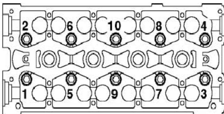
7). 按所示的顺序，充分松开缸盖上的螺栓1至6，拿开螺栓并按安装顺序放好。
