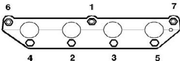
29). 固定进气歧管，装上7个螺母，按所示的顺序拧紧至 $17\text{Nm}$ 。
