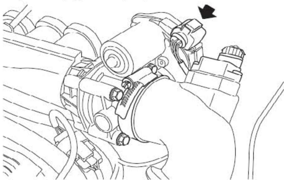
14). 从电子节气门传感器上断开连接器的连接。
