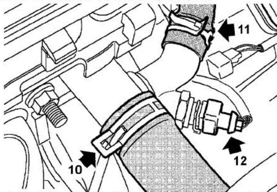
10). 松开夹箍，并从冷却液出口弯管接头处断开散热器顶部软管。
