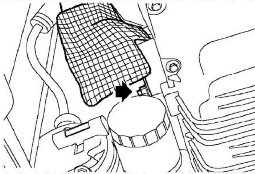
6). 拧下把发电机隔热板固定到发电机下支架上的螺栓并取下隔热板。
