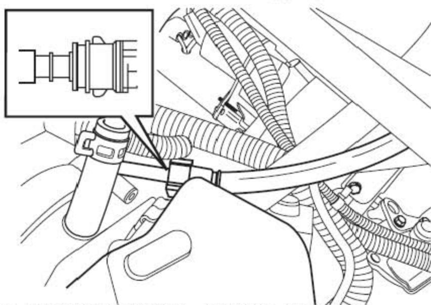
18). 压下供油管的塑料边圈，从燃油轨上松开供油管。
