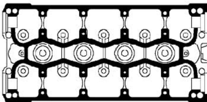
22). 在如图所示的凸轮轴支架路径上涂上的密封剂，部件号为FLM90017A，然后用滚轮把密封剂涂成均匀薄膜。
