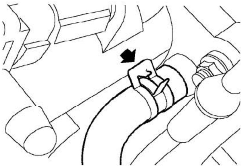
21). 松开夹箍并从进气歧管上断开膨胀水箱软管。
