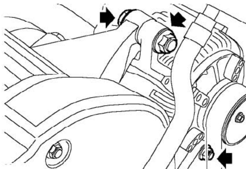
3). 拧下发电机的上下螺栓，并取下发电机。
