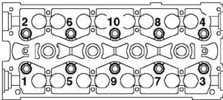
24). 按所示的顺序，渐次松开缸盖上的螺栓1至6，拿下螺栓并按安装顺序放好。
