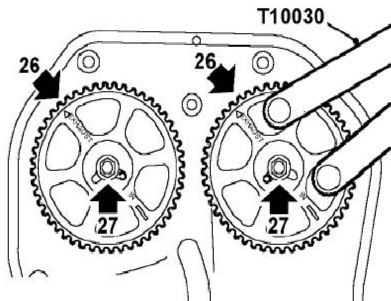
26). 把凸轮轴带轮装到相应的凸轮轴上，确保驱动销定位在带轮的正确的切槽中。
