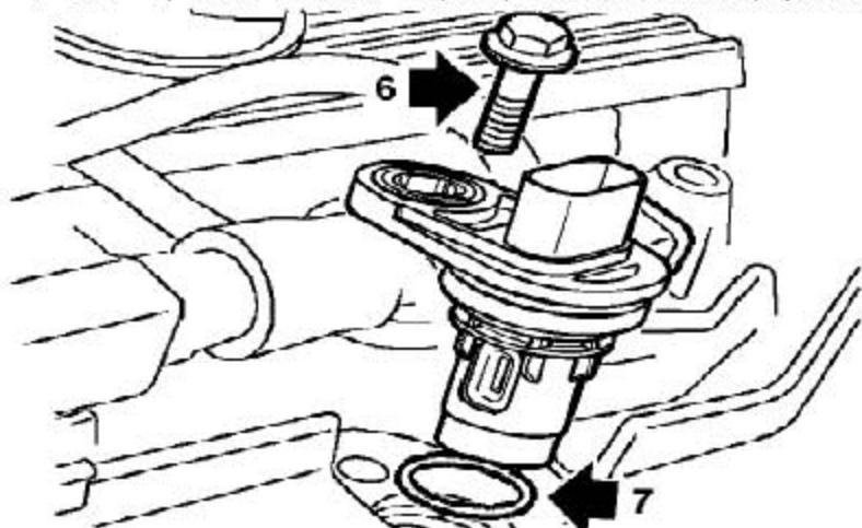
6). 拧下把CMP传感器固定到缸盖上的螺栓并放到一边。
