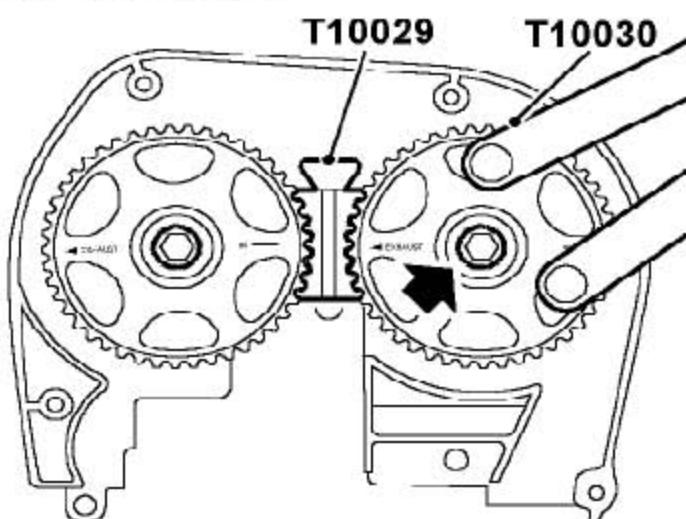
3). 拆下凸轮轴带轮锁止工具T10029。
