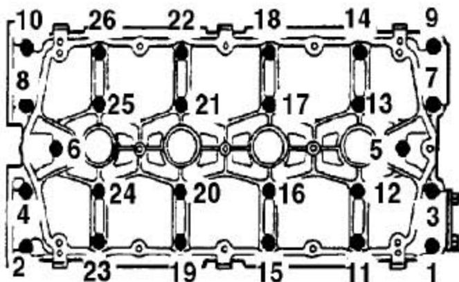
23). 装上凸轮轴支架，并把凸轮轴支架固定到缸盖上的螺栓逐渐按所示的顺序，依次拧紧到  $10\text{Nm}$ 。
