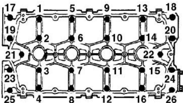
8). 按图所示的顺序，依次松开把凸轮轴支架固定到气缸盖上的26个螺栓，直到气门弹簧压力不再作用到凸轮轴上。
