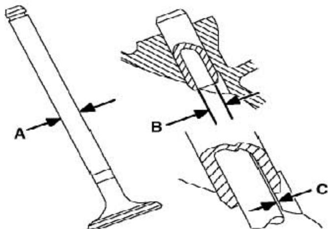
2). 检查现有的气门杆的直径。用新的气门检查气门导管的间隙。(参照“规格”)
