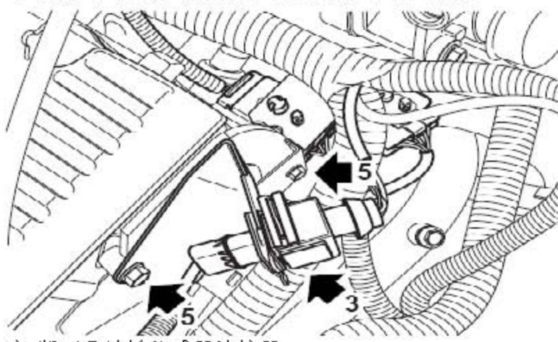
3). 断开凸轮轴传感器连接器。
