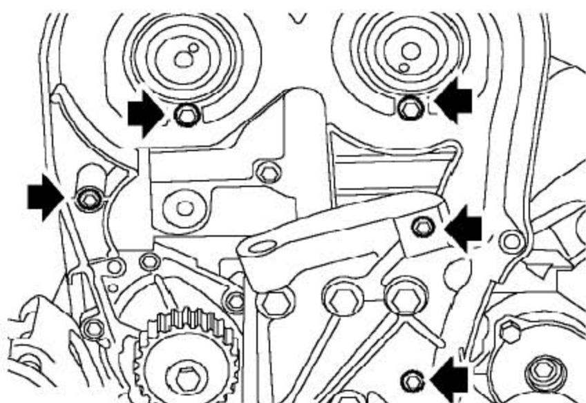
6). 注意最长的螺钉的安装位置，拧下把正时带后上盖固定到气缸盖上和水泵上的螺钉。
