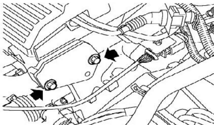
3). 拧下2个把油封盖盘固定到缸盖上的螺栓并拿开盖盘。
