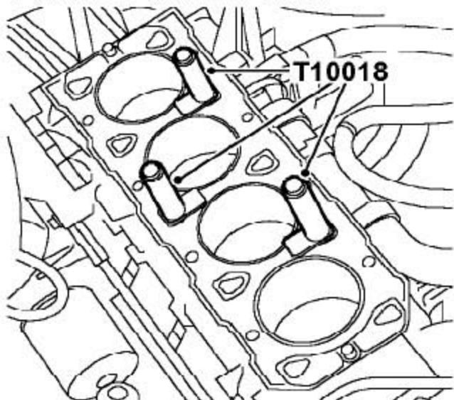
19). 把平缸夹T10018装到缸体上，用缸盖螺栓固定，要保证夹子的边缘不会突出到缸套的内径。
