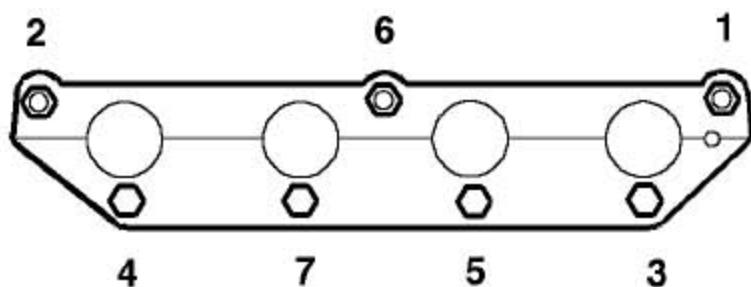
7). 按所示的顺序，渐次松开把进气歧管固定到缸盖上的7个螺母。
