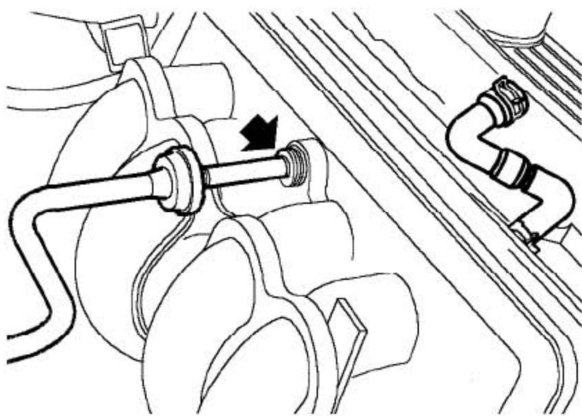
20). 松开快松接头上的塑料边圈，从进气歧管上断开制动伺服真空软管。
