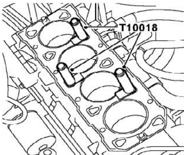
35). 把平缸夹T10018装到缸体上并用缸盖螺栓固定。确保平缸夹的底部没有突到缸套口的内径。
