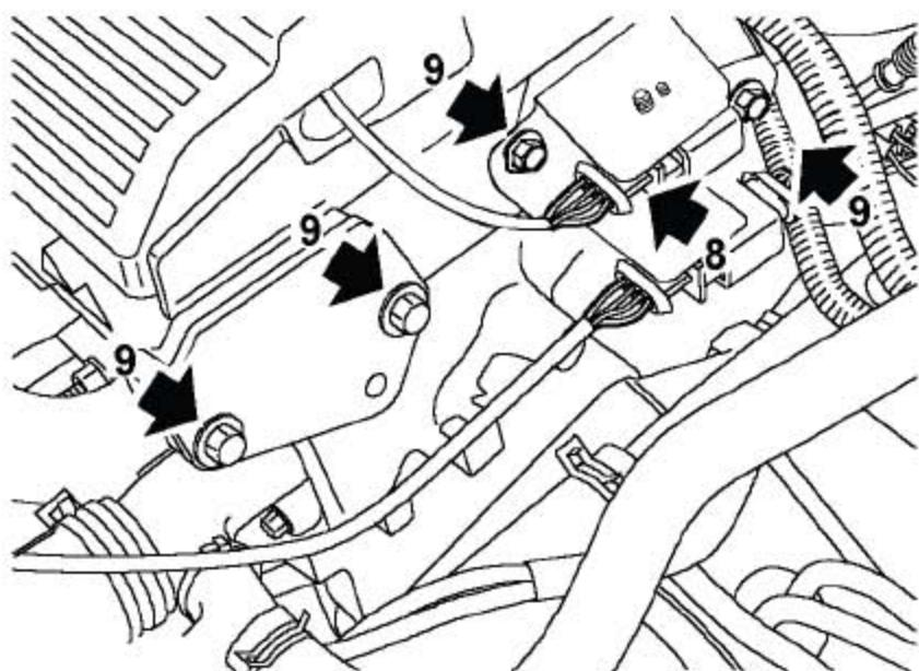
8). 从发动机线束上断开凸轮轴传感器的连接器。
