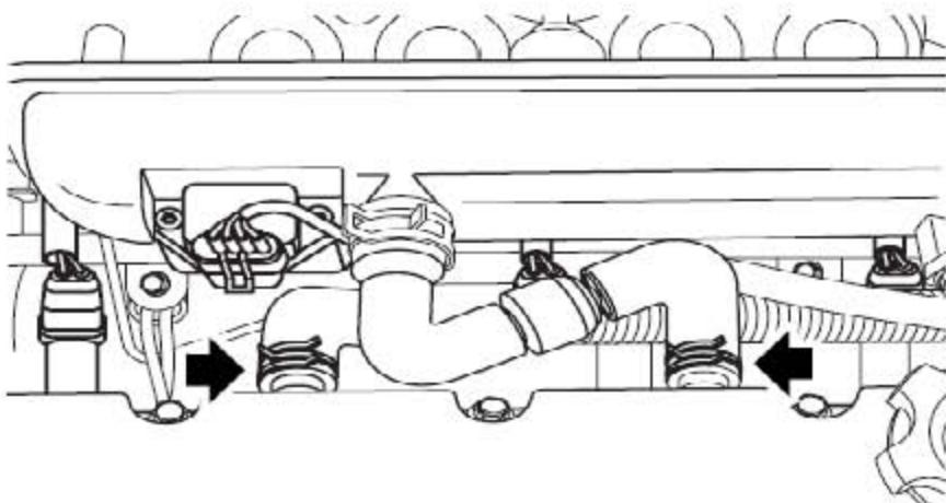
2). 松开2个夹箍，从凸轮轴盖上断开2个通气软管。
