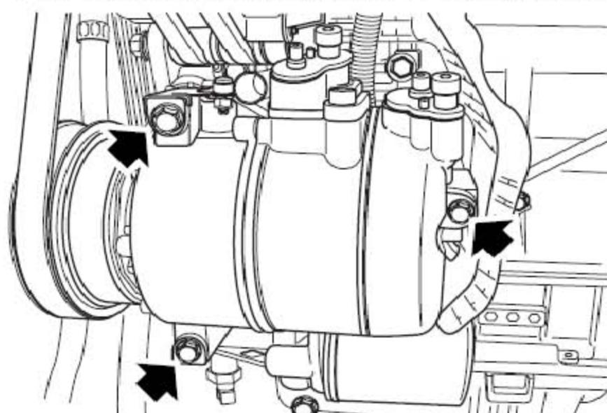
5). 拧下把空调压缩机固定到发电机下支架的3个螺栓，并拆下压缩机。
