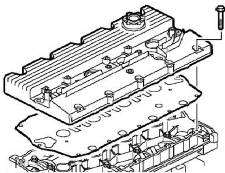
8). 慢慢松开固定凸轮轴盖的15个螺栓并取下。
