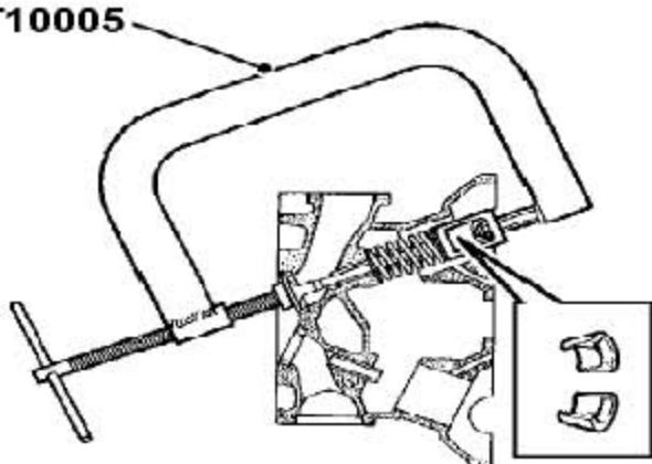
13). 用工具T10005压缩气门弹簧。
