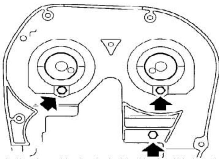
32). 拧下把正时带轮后上盖固定到缸盖上的螺钉，拿开盖子。
