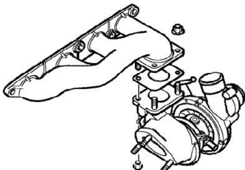
6). 拧下4个把排气歧管固定到涡轮增压器上的螺母。
