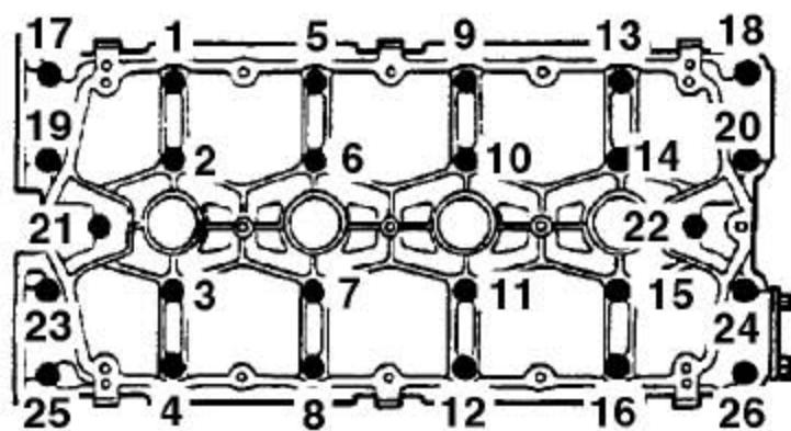
9). 按所示的顺序，渐次松开把凸轮轴架固定到缸盖上的26个螺栓，直到气门弹簧的压力全部释放。
