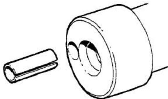
24). 从旧的凸轮轴上拿开驱动销，装上新的销，注意缺口朝凸轮轴的中心。
