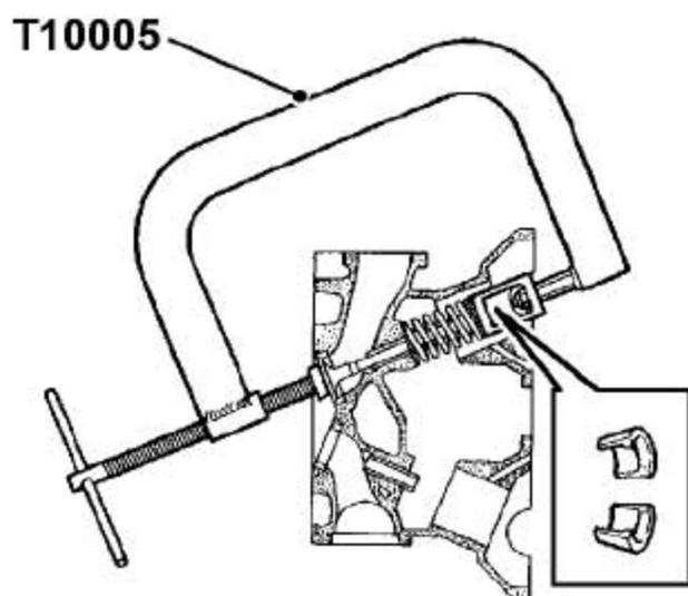
26). 用工具T10005压缩气门弹簧。
