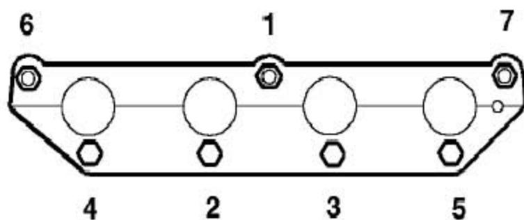
17). 把进气歧管装到缸盖上，装上7个螺母并拧紧，按所示的顺序拧紧至17Nm。
