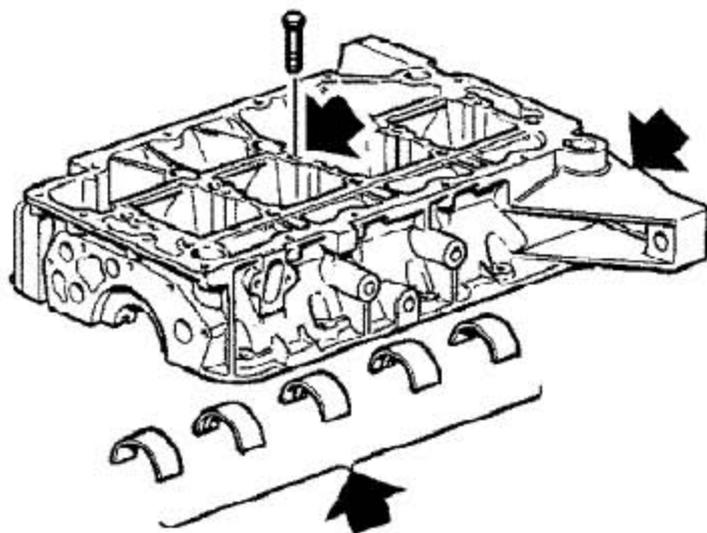
33). 拧下10个把轴承座固定到缸体上的螺栓，拿开轴承座，并从轴承座上取下主轴瓦。
