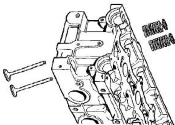
30). 取下剩下的气门弹簧，弹簧盖和气门。按原来的安装顺序，把气门和弹簧放好。
