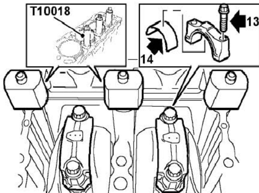
13). 按安装要求保持住把螺栓和连杆大头盖，拧下把连杆大头盖固定到连杆上的螺栓，并拿开连杆大头盖。
