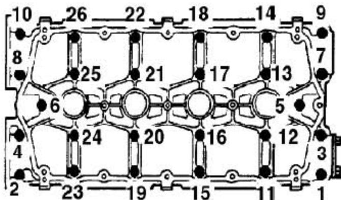
20). 再装上凸轮轴架，按顺序把螺栓拧紧到10Nm。不要转动凸轮轴。
