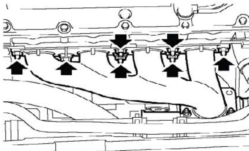
1). 按所示的顺序，拧下7个把排气歧管固定到缸盖上的螺母，并拿开歧管。
