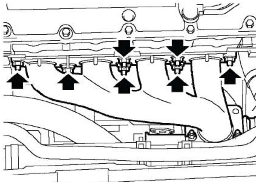
19). 把新的排气歧管衬垫装到缸盖上，装上歧管，装上螺母并按所示的顺序拧紧到45Nm。
