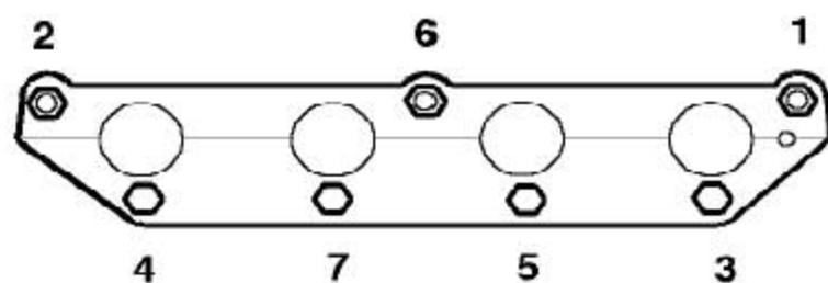
3). 按所示的顺序，渐次拧下把进气歧管固定到缸盖上的7个螺母。
