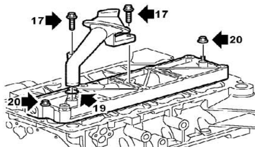
17). 拧下2 个把机油集滤器固定到机油轨上的螺栓。
