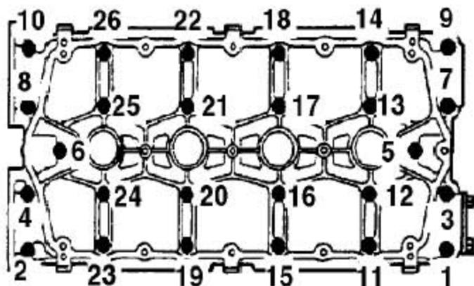
9). 装上凸轮轴架，按顺序渐次把螺栓拧紧到10Nm。
