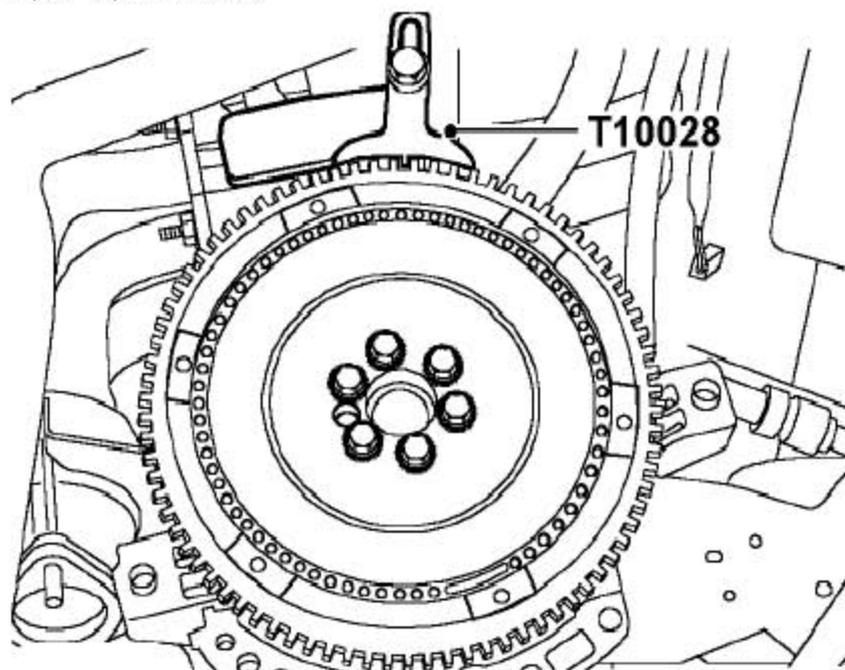
2). 把飞轮锁止工具T10028装到缸体上，并用螺栓固定。
