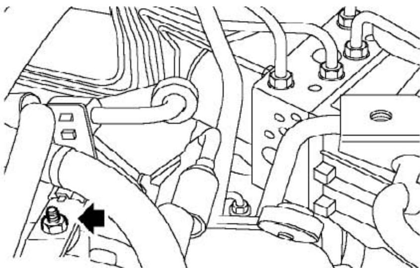
23). 拿开把PAS软管支撑支架固定到冷却导管上的螺栓。
