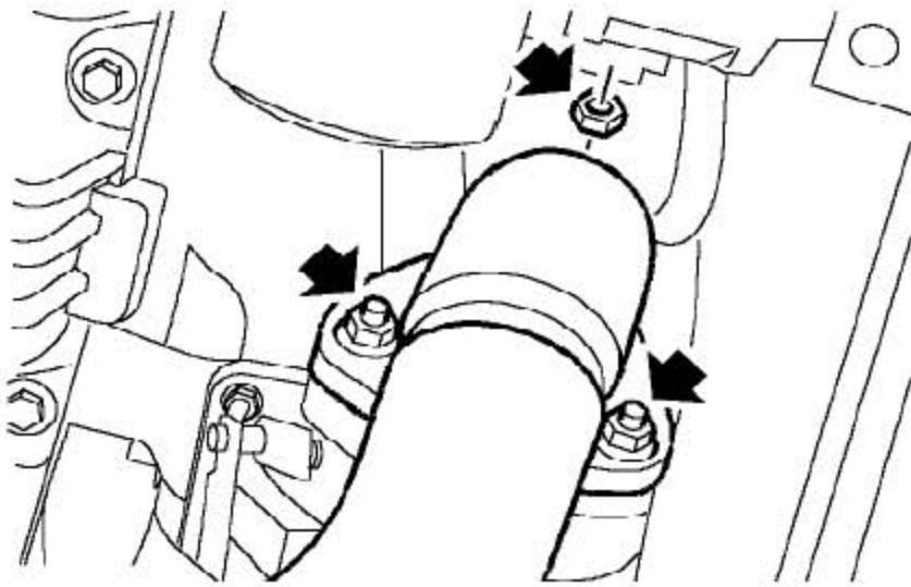
42). 拧下3个把前排气管法兰固定到涡轮增压器上的螺母，松开前排气管。
