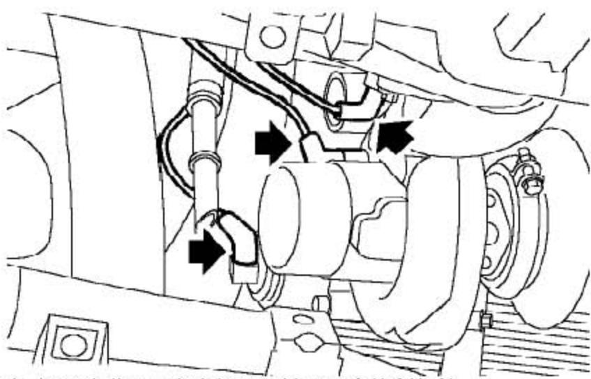
45). 从涡轮增压器和废气口处松开压力控制软管。
