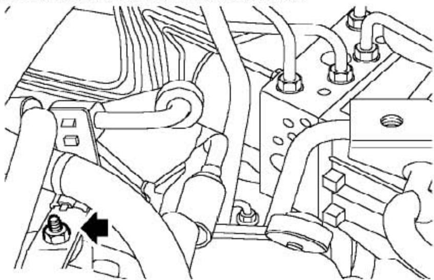
25). 拿开把PAS软管支撑支架固定到冷却导管上的螺栓。
