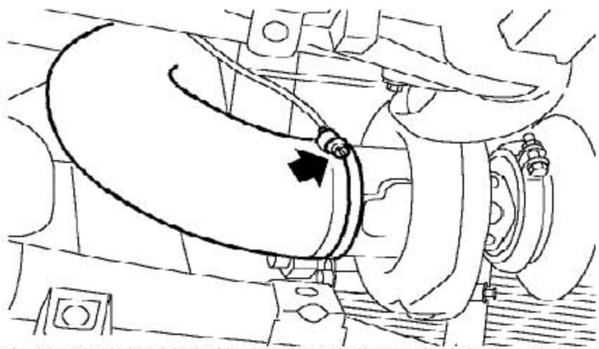
42). 松开把空气进气软管固定到涡轮增压器上的夹箍，并拿开软管。
