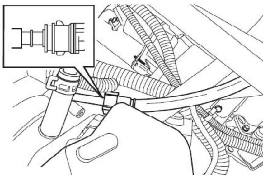
22). 松开夹箍并从燃油轨上断开软管的连接。
