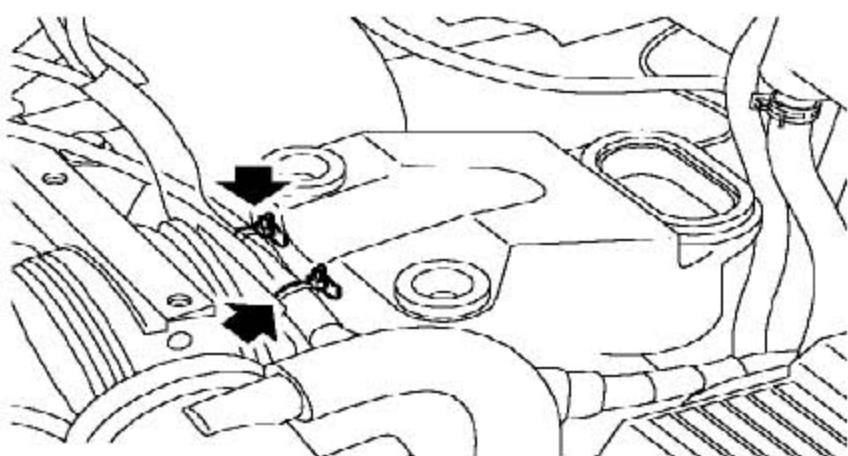
7). 把发动机线束和接地端固定到空气滤清器支撑支架上的夹子松开。
