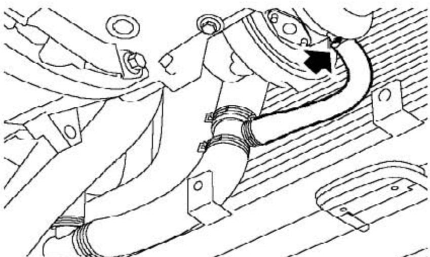
47). 松开把冷却液进液软管固定到增压器上的夹箍，并拆下软管。
