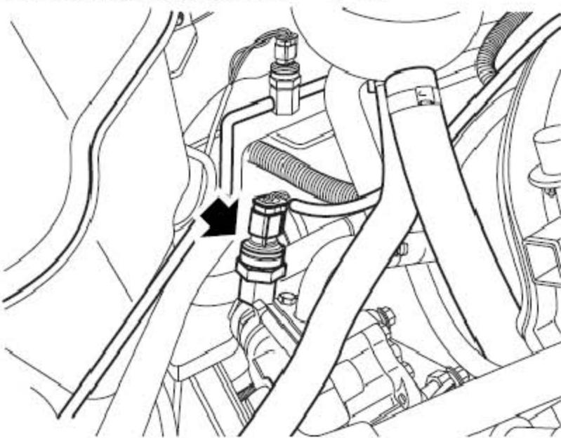
30). 断开PAS压力传感器连接器的连接。
