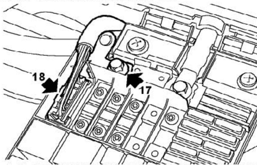
17). 拧下螺栓并从发动机舱保险丝盒上断开发动机接地导线的连接。
