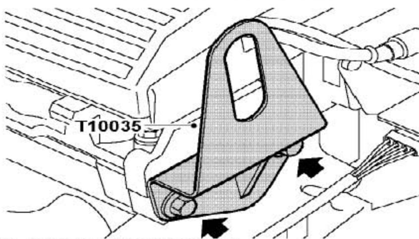
73). 拧下2个螺栓并拿开凸轮轴盖板。
