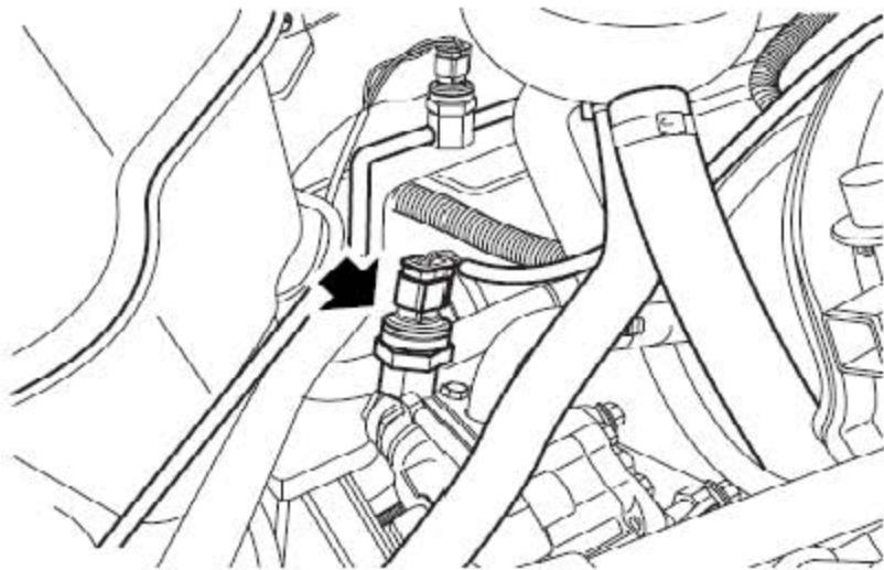
32). 断开PAS压力传感器连接器的连接。
