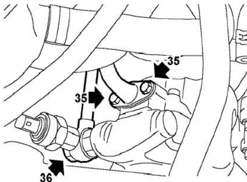
35). 拧下2个把进液软管固定到PAS泵上的螺栓，松开软管，取下O型圈并废弃。
