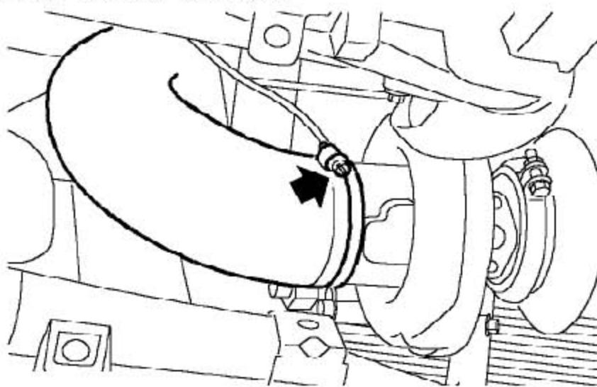
44). 松开把空气进气软管固定到涡轮增压器上的夹箍，并拿开软管。
