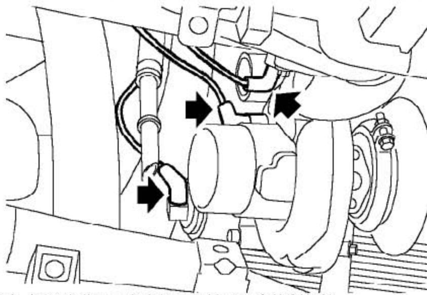
43). 从涡轮增压器和废气口处松开压力控制软管。
