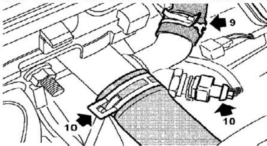
9). 松开把软管固定到冷却管出口弯管接头的夹箍，并断开软管的连接。
