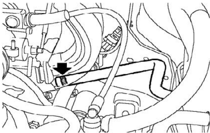
13). 松开把加热器软管固定到缸体的夹箍并断开软管的连接。
