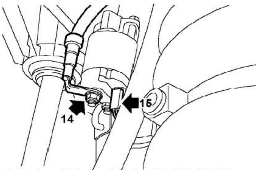
14). 拧下螺母并从起动电动机上断开蓄电池导线的连接。
