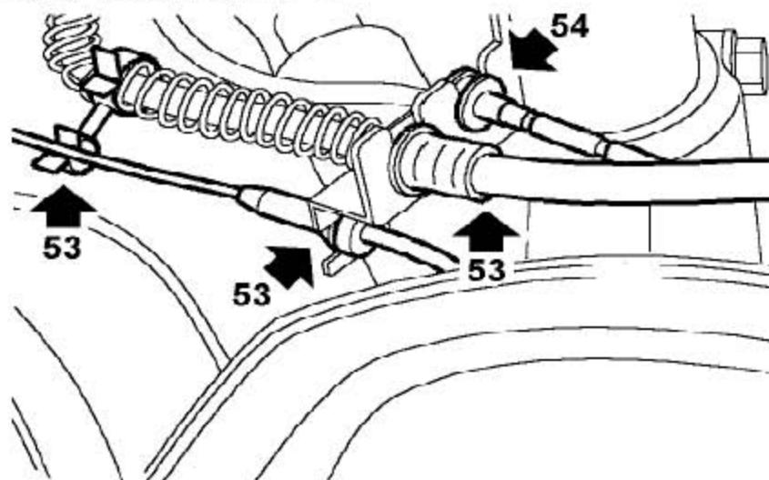
53). 取下固定右制动软管的夹子，从支撑支架上松开制动软管盒ABS 传感器线束上的夹子。松开制动蹄磨损传感器线束，从支撑支架上松开ABS 传感器线束。
