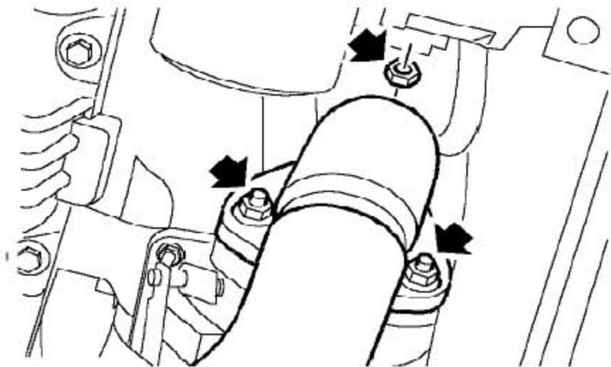
40). 拧下3个把前排气管法兰固定到涡轮增压器上的螺母，松开前排气管。
