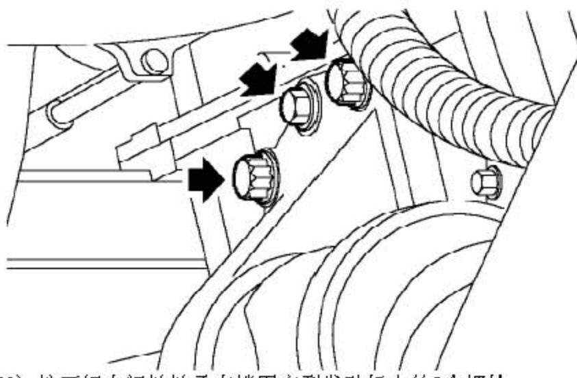
56). 拧下把中间轴轴承支撑固定到发动机上的3个螺栓。
