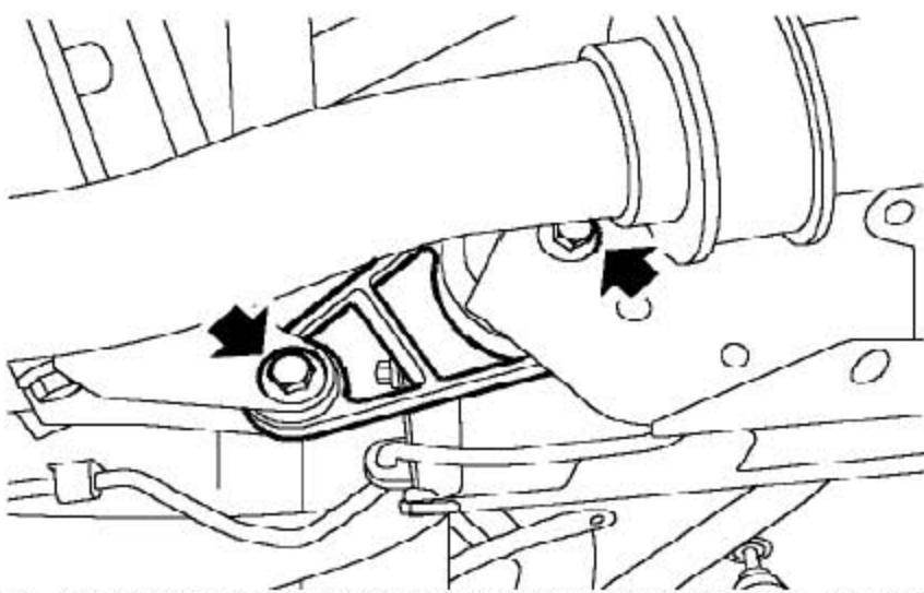
49). 拧下把发动机下后系杆固定到下前系杆和副车架上的2个螺栓，拿开下后系杆。
