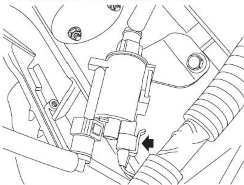
23). 断开炭罐控制阀连接器的连接。
