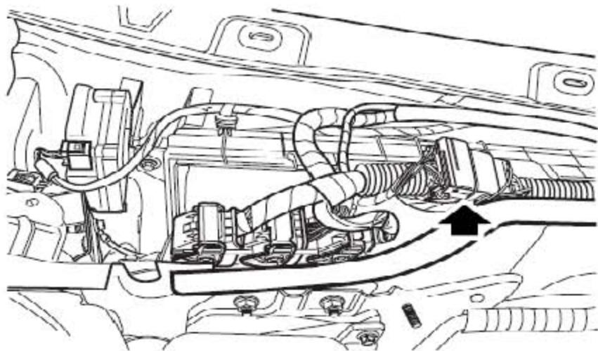
21 断开发动机线束与主线束连接器的连接。
