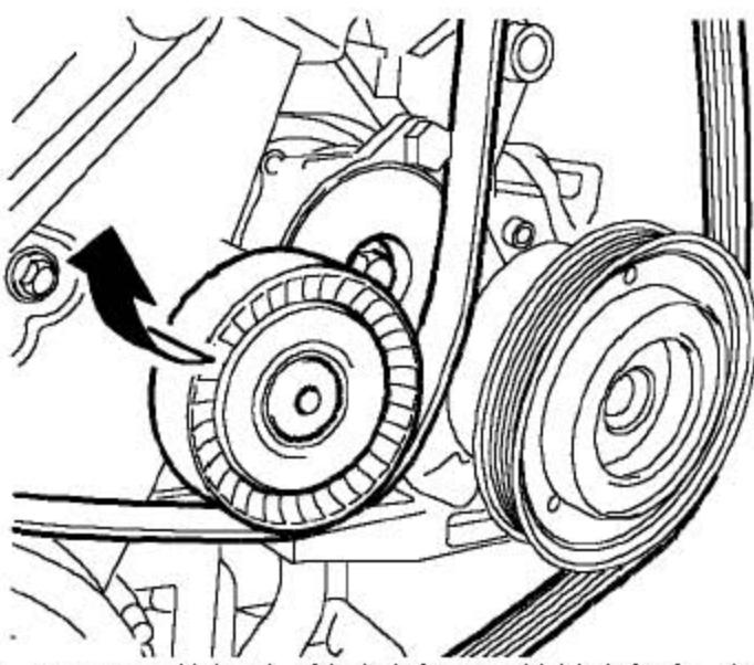
40). 用一13mm的扳手，转动张紧器以放松张紧力，把辅助传动带从空调压缩机皮带轮上拿开。
