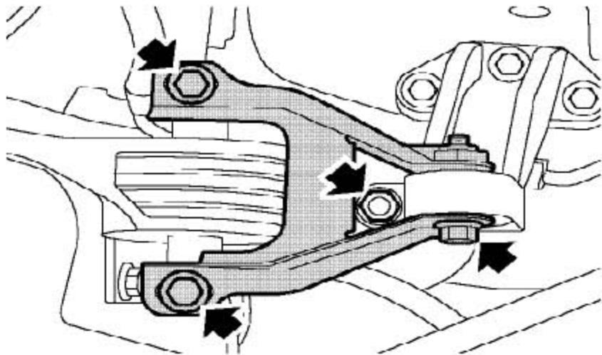
75). 拧下固定发动机右上系杆到右系杆的2个螺栓，以及到右托架的1个螺栓，拧下右托架固定到右液压悬置的螺母。
