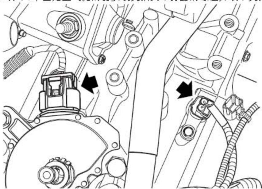
9). 松开并断开2个变速器线束的连接器的连接。
