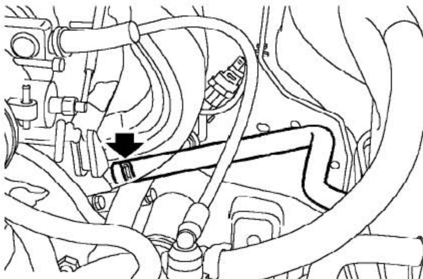
11). 松开把加热器软管固定到缸体的夹箍并断开软管的连接。
