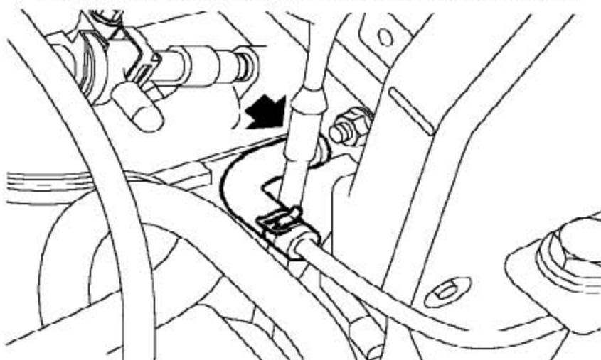
14). 松开把膨胀水箱软管连接到进气歧管上的夹箍，并断开软管的连接。
