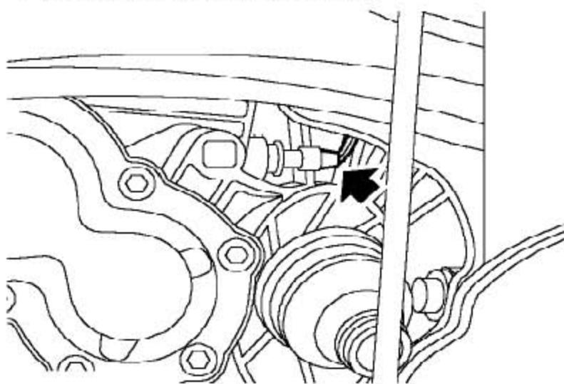
27). 松开夹子并断开倒档灯开关连接器的连接。
