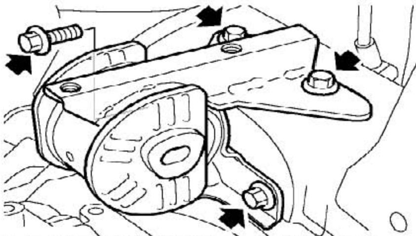
81). 拧下4个固定左液压悬置到车身上的螺栓并拿开支架。
