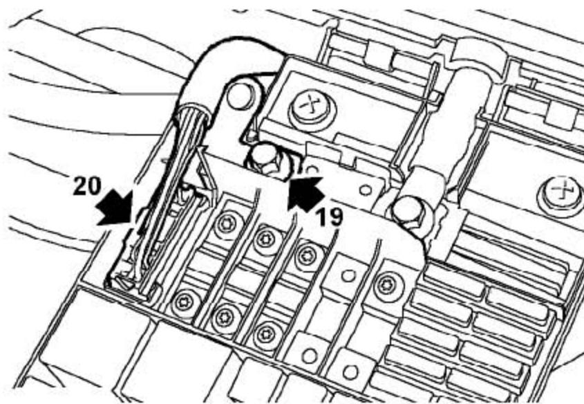
19).拧下螺栓并从发动机舱保险丝盒上断开发动机接地导线的连接。
