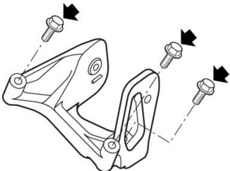
80). 拧下6个固定左安装支架到变速器上的螺栓并拿开支架。
