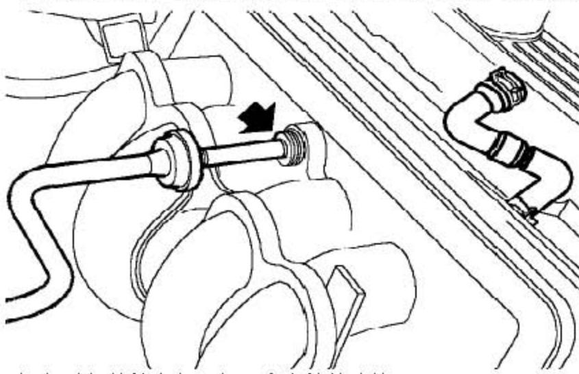
15). 从进气歧管上断开伺服真空管的连接。
