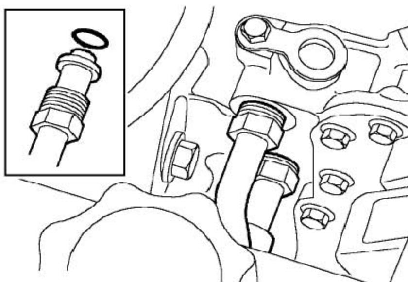
70). 松开并断开2个变速器液体冷却器软管的连接并废弃掉O型圈。
