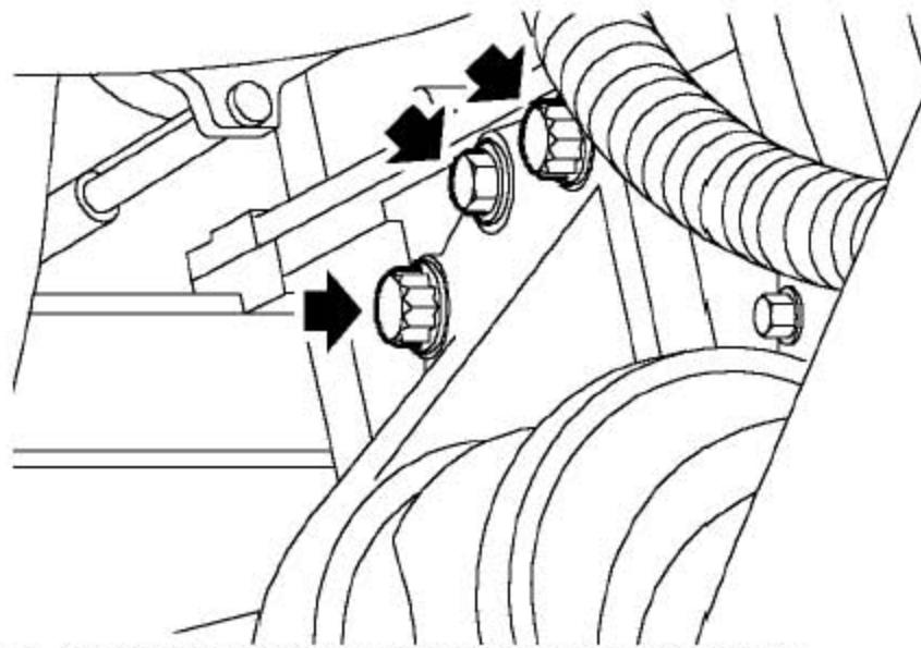
58). 拧下把中间轴轴承支撑固定到发动机上的3个螺栓。
