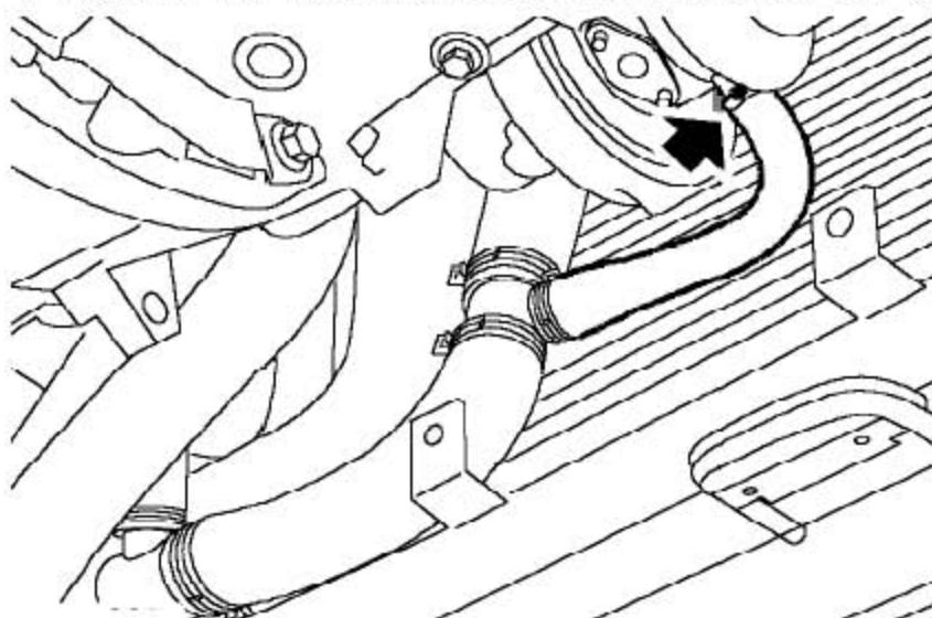
45). 松开把冷却液进液软管固定到增压器上的夹箍，并拆下软管。
