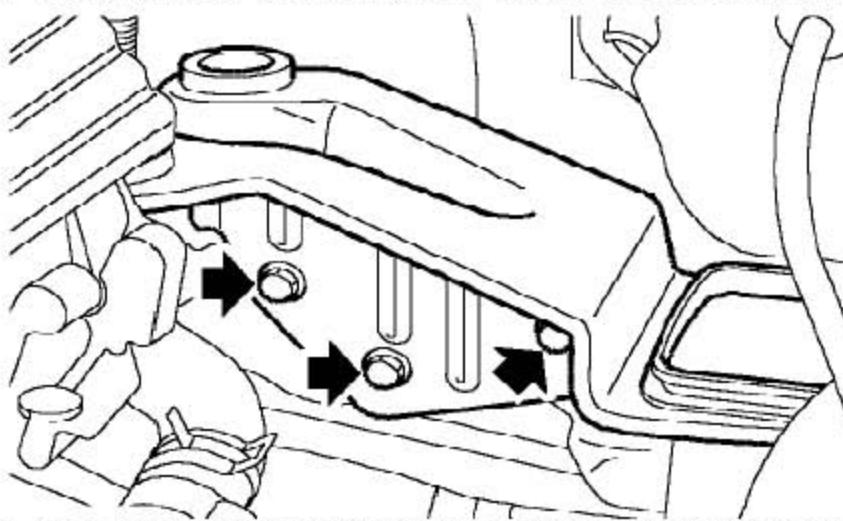
8). 拧下3个固定空气滤清器安装支架到车身上的螺栓并取下支架。
