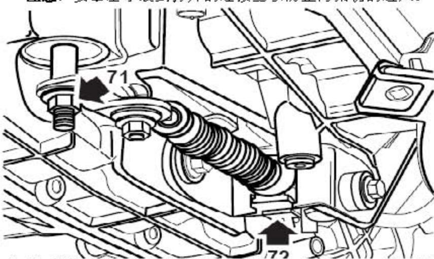
71). 拧下把换档杆固定到变速器上的螺母，从变速器上松开换档杆。
