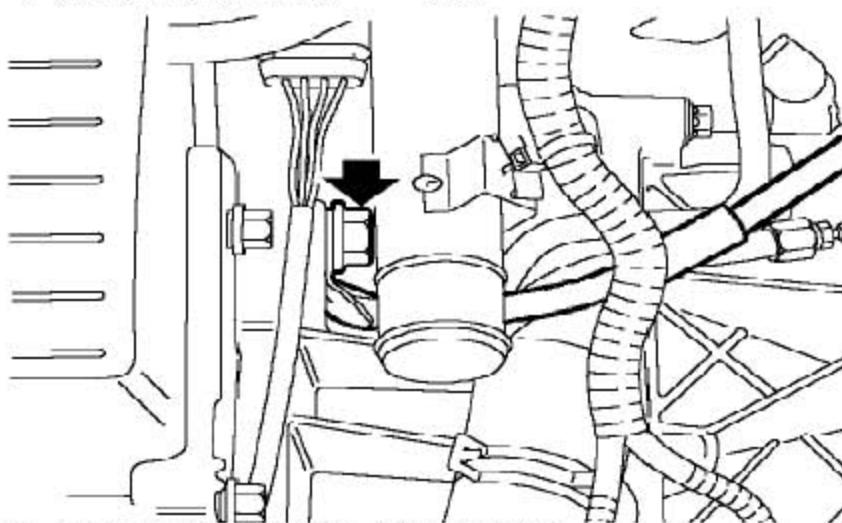
16). 拧下螺栓并从变速器上松开接地导线。
