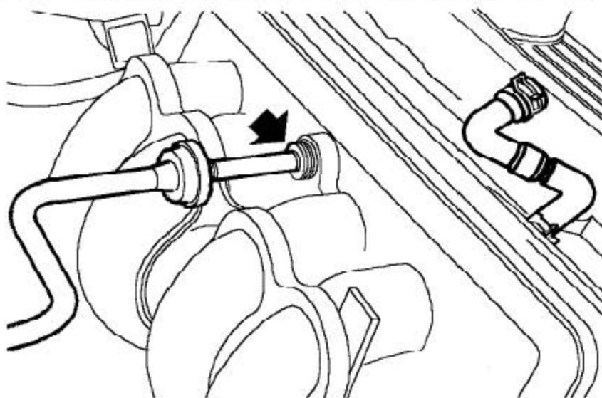
13). 从进气歧管上断开真空管的连接。
