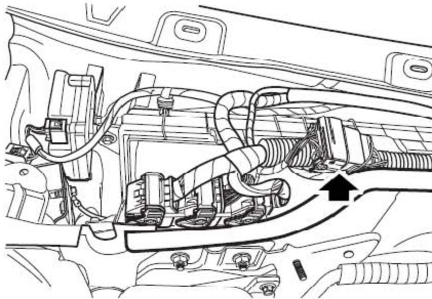
19). 从主线束连接器上断开发动机线束的连接。
