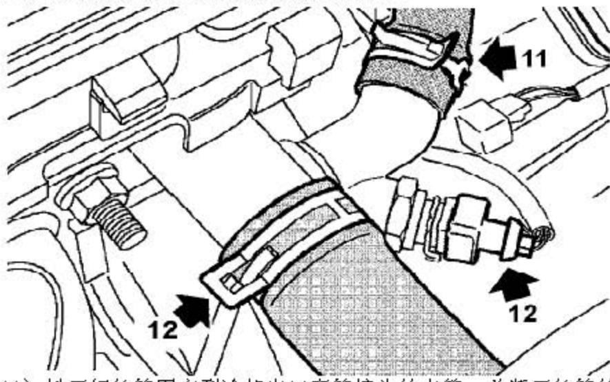
11). 松开把软管固定到冷却出口弯管接头的夹箍，并断开软管的连接。
