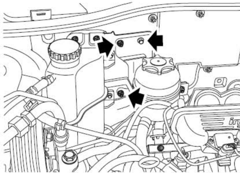
37). 拧下2个把PAS储液罐固定到防水壁上的螺母和1 个螺栓，取下储液罐并放在旁边。
