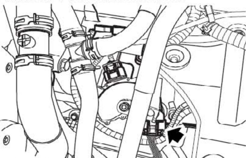
10). 断开变速器上起动电机电磁阀的连接。
