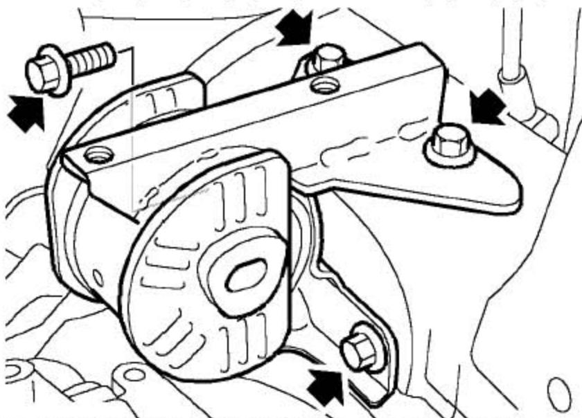
78). 拧下4个固定左液压悬置到车身上的螺栓并拿开安装。
