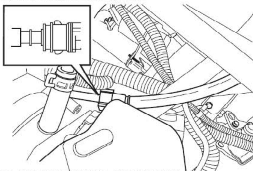
24). 松开夹箍并从燃油轨上断开软管的连接。
