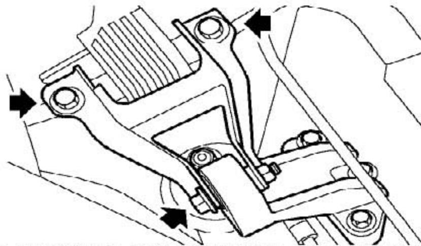
6). 拧下把发动机右托架固定到液压悬置上的螺母。拧下把发动机右托架固定到发动机上的3个螺栓。拧下右上系杆固定到右系杆的2个螺栓。拆下发动机右托架和右上系杆总成。
