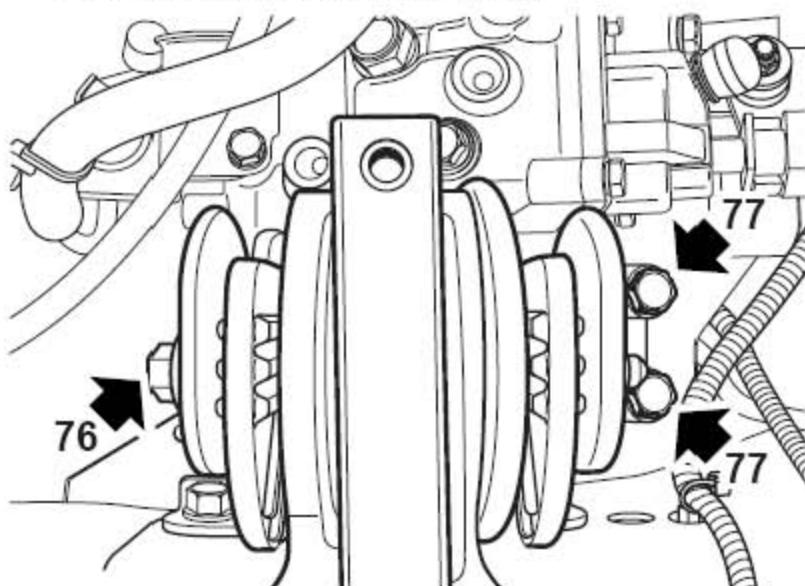
76). 拧下把变速器左安装支架到变速器左液压悬置支架的贯穿螺栓。
