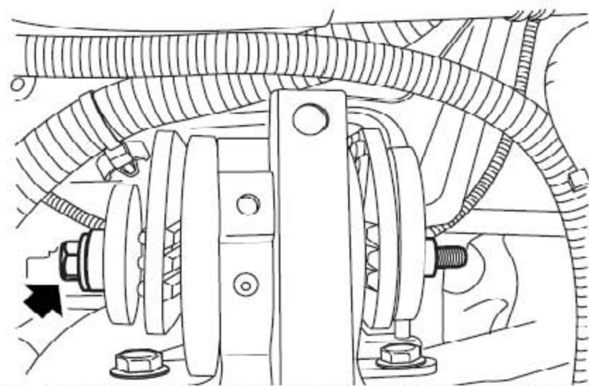
79). 拧下把发动机左安装支架到变速器左液压悬置的贯穿螺栓。
