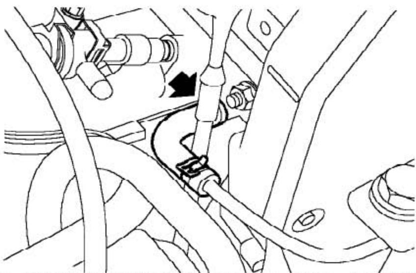
12). 松开把膨胀水箱软管连接到进气歧管上的夹箍，并断开软管的连接。
