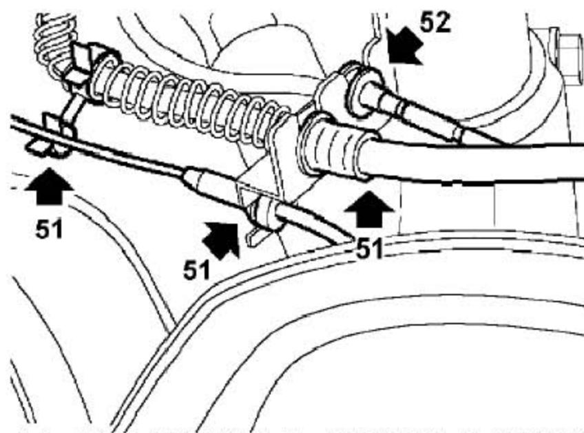
51). 取下固定右制动软管的夹子，从支撑支架上松开制动软管盒ABS传感器线束上的夹子。松开制动蹄磨损传感器线束，从支撑支架上松开ABS传感器线束。
