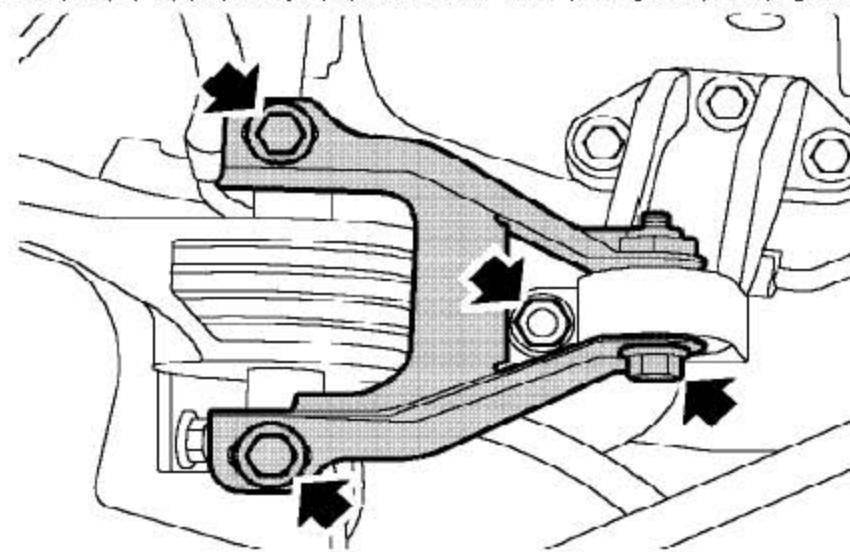
78). 拧下固定发动机右上系杆的螺母和3个螺栓并拿开支架。
