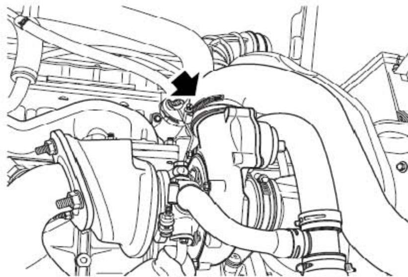
44). 松开把空气出气软管固定到涡轮增压器上的夹箍，并拿开软管。
