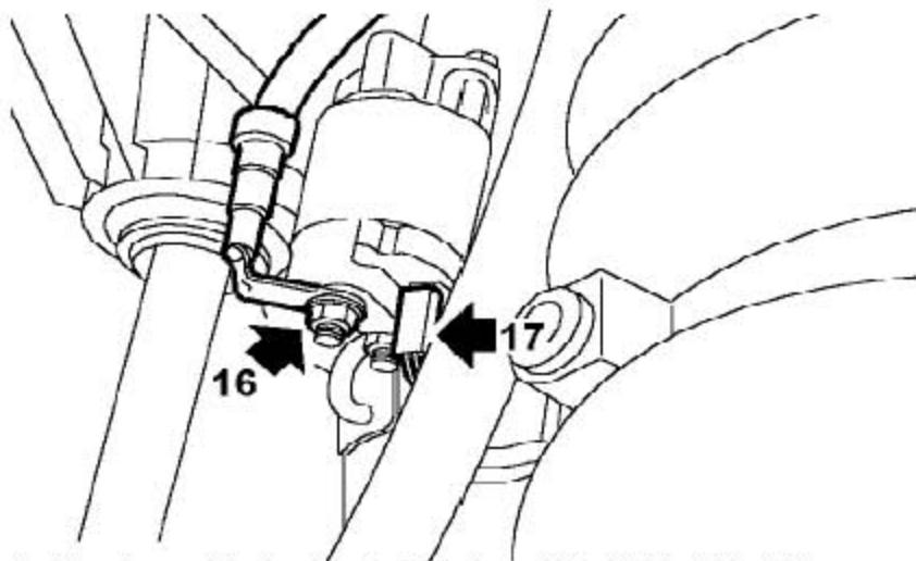
16). 拧下螺母并从起动机电机上断开蓄电池导线的连接。
