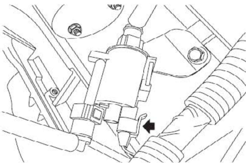
21). 断开炭罐控制阀连接器的连接。
