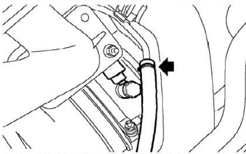
48). 松开夹箍并断开增压器冷却液回液管的连接。
