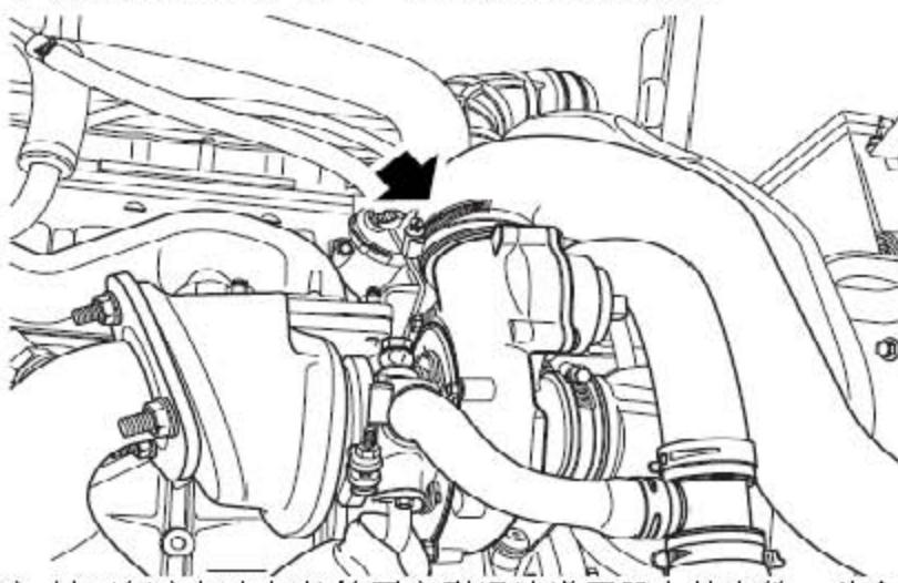
46). 松开把空气出气软管固定到涡轮增压器上的夹箍，并拿开软管。
