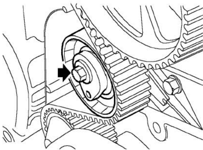
15). 拧下并废弃掉正时带张紧轮螺栓，并拆下张紧轮。如果还要装原来的皮带，标记下皮带上的转动方向。
