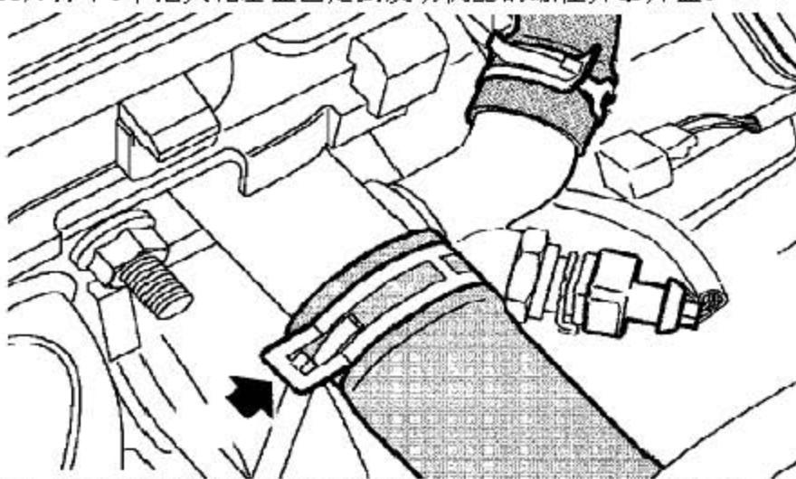
19). 松开把冷却液软管固定到发动机弯管接头上的弹簧挡圈，松开软管并固定到旁边。
