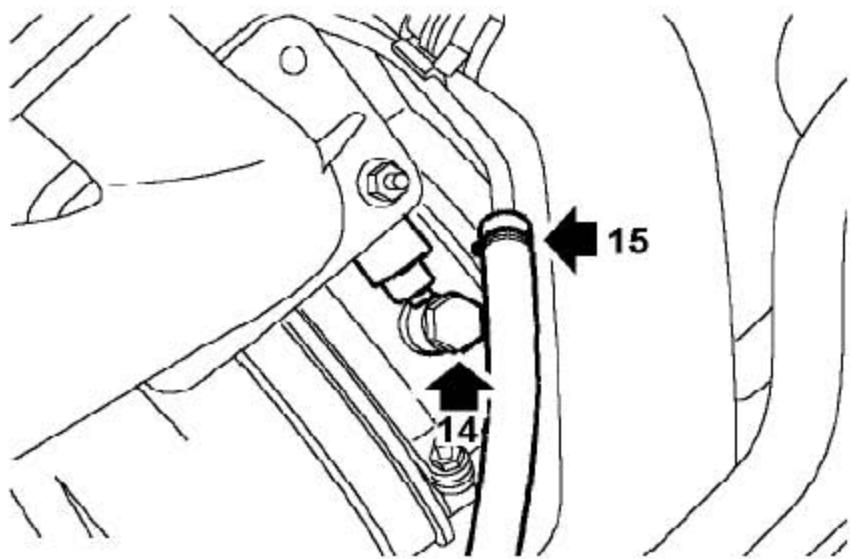
14). 取下把机油进油管固定到涡轮增压器上的螺栓和2个垫圈。
