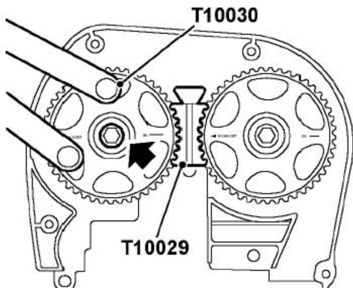
3). 从凸轮轴带轮上取下凸轮轴带轮锁止工具T10029。
