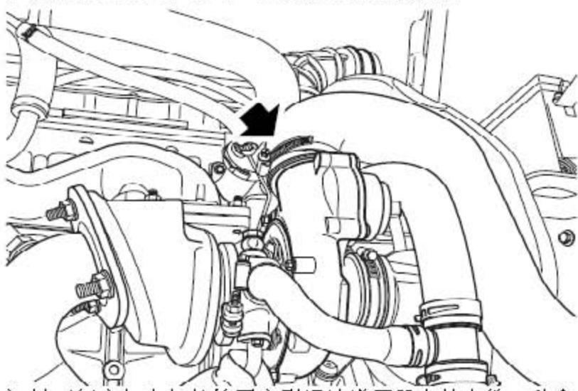
11). 松开把空气出气软管固定到涡轮增压器上的夹箍，并拿开软管。
