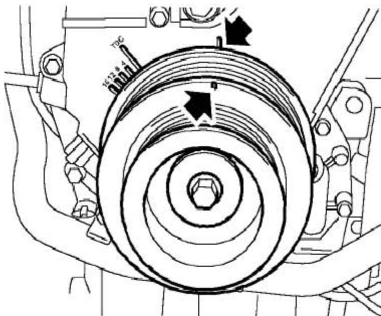
11). 检查并确保曲轴皮带轮上的正时标记和正时带下前上盖的标记对准。
