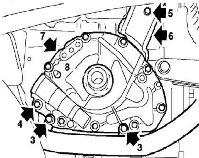
3). 拧下2个把发动机线束固定到机油泵上的螺栓并拿开线束以使机油泵可见。
