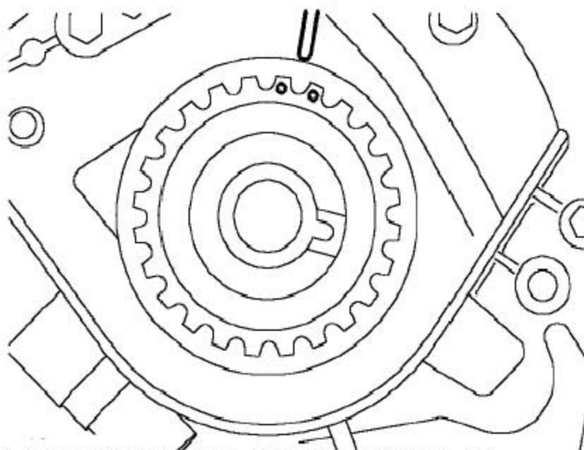
3). 检查曲轴齿轮上的孔和机油泵上的法兰是否对准。
