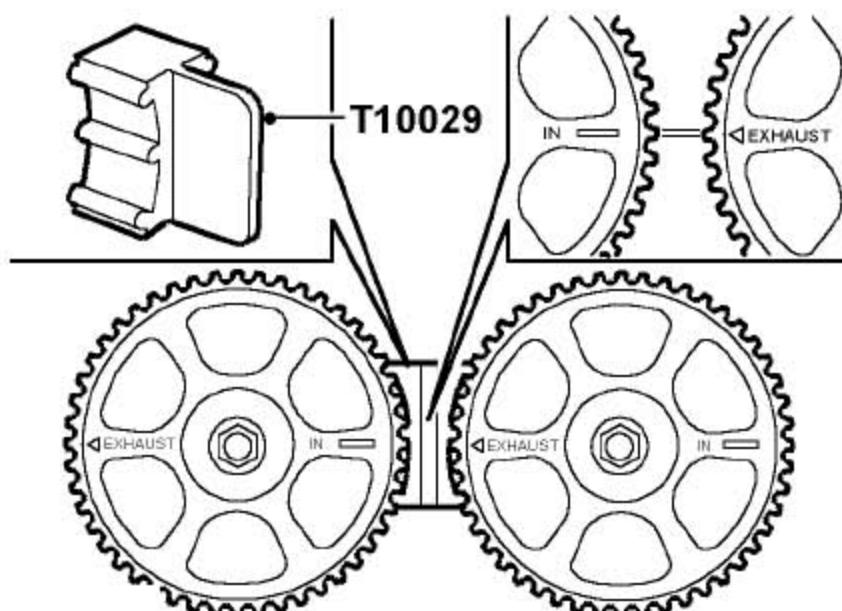
9). 顺时针转动曲轴以对准凸轮轴带轮的标记。
