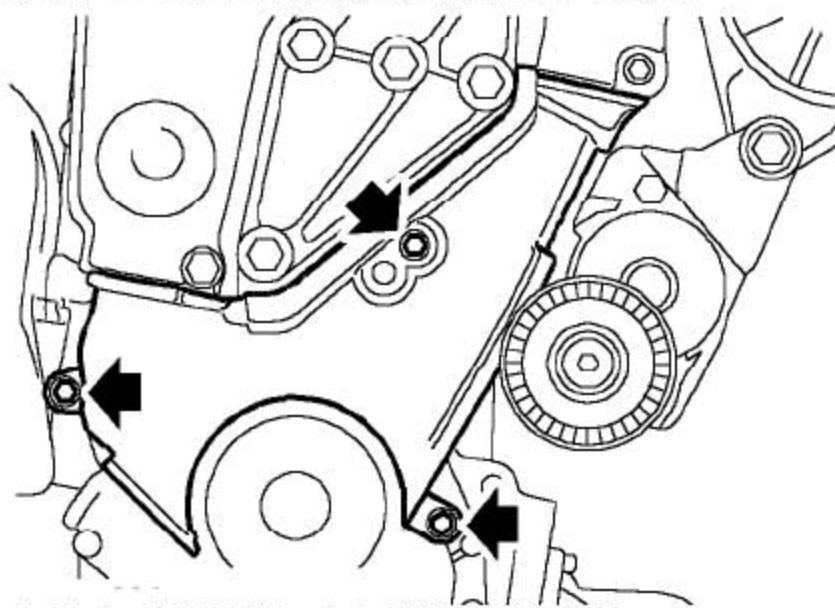
14). 拧下3个螺钉并取下正时带前下盖和密封。
