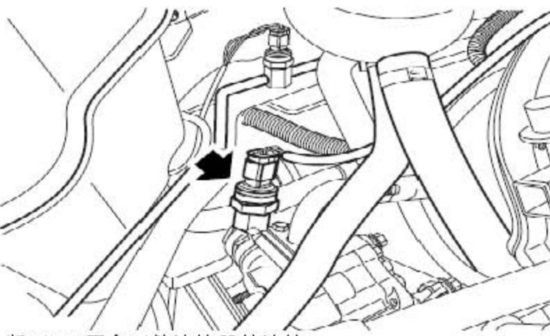
8). 断开PAS压力开关连接器的连接。
