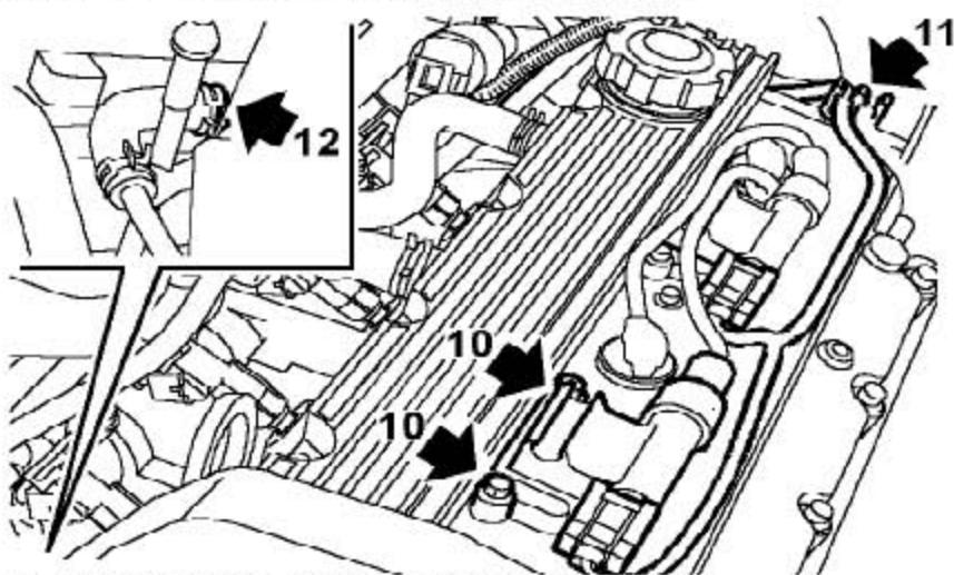
10). 拧下2个固定右线圈的螺栓并松开线圈。
