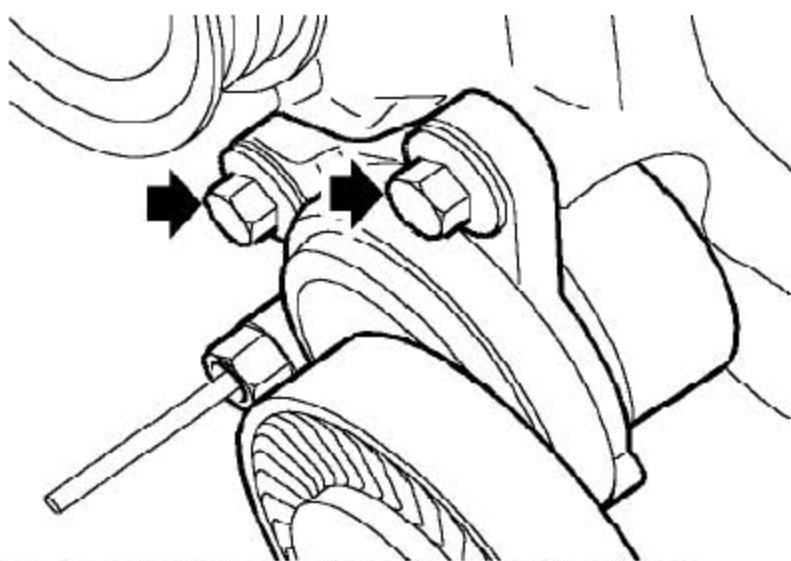
13). 拧下2个固定PAS泵张紧轮的螺栓并拆下张紧轮。
