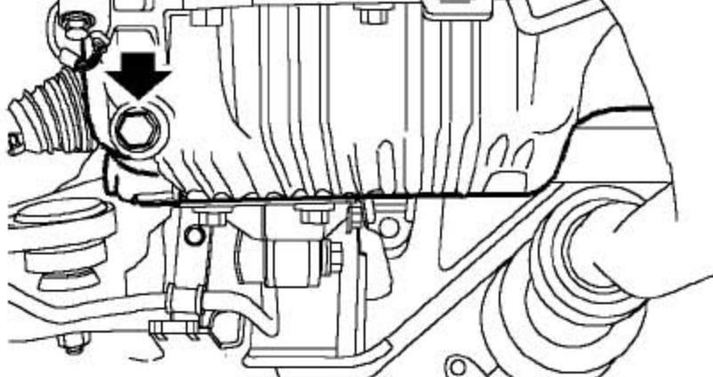
3). 把一合适的容器放在发动机油底壳的放油塞下面，拧开塞子并废弃密封垫圈。把油放掉。
