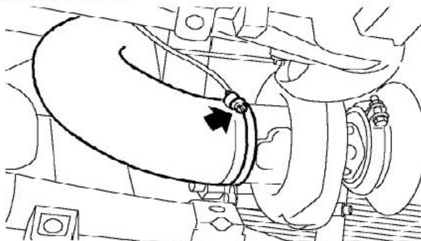
9). 松开把空气进气软管固定到涡轮增压器上的夹箍并拿开软管。
