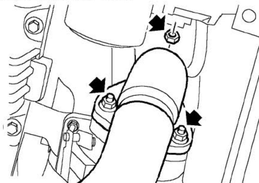
4). 拆下3个把前排气管固定到涡轮增压器上的螺母，松开前排气管并废弃掉衬垫。
