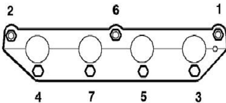
18). 按所示的顺序，渐次把进气歧管固定到缸盖的7个螺母上。
