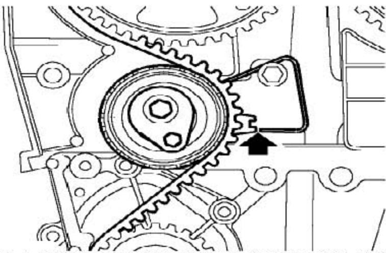
16). 如果要装原来的皮带，那么指针就必须对准好，这样指针线就靠近指针的下区域。
