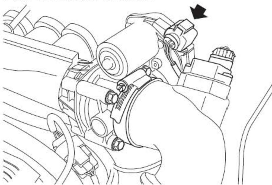
5). 从电子节气门传感器上断开连接器的连接。
