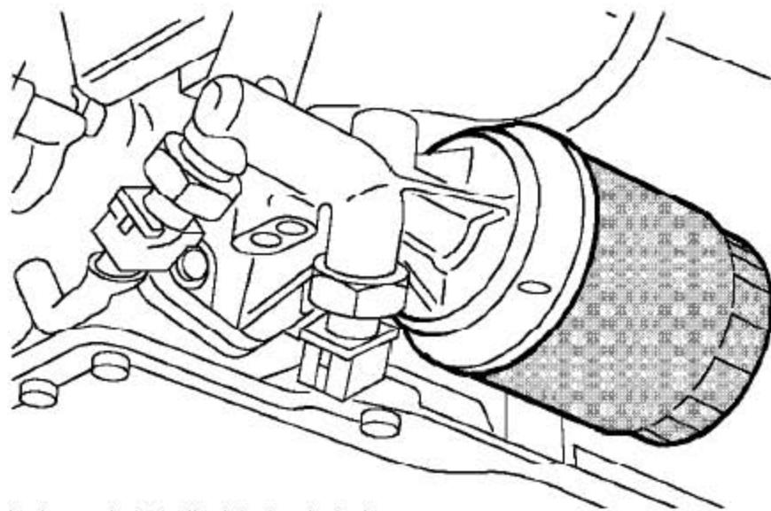
5). 拆下并废弃发动机机油滤清器。
