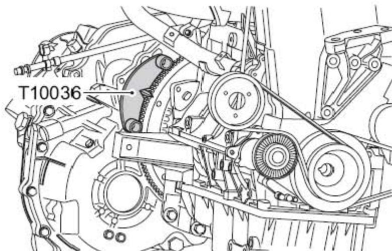
6). 把飞轮锁止工具T10036（自动变速器）、T10037（手动变速器）装到飞轮壳上的起动电机安装位置，并用螺栓固定。
