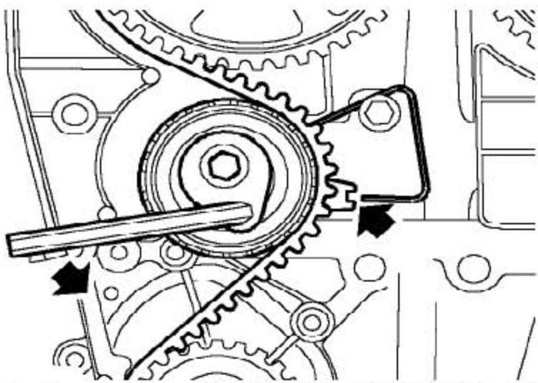
15). 用一6mm的Allen键，逆时针方向转动张紧轮杆，并使指针和如图所示的指针线对准。
