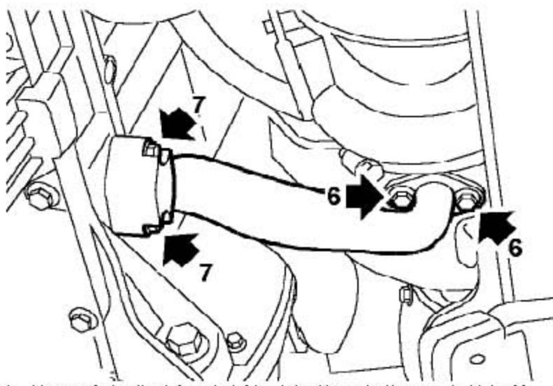
6). 拧下2个把发动机回油管固定到涡轮增压器上的螺栓。
