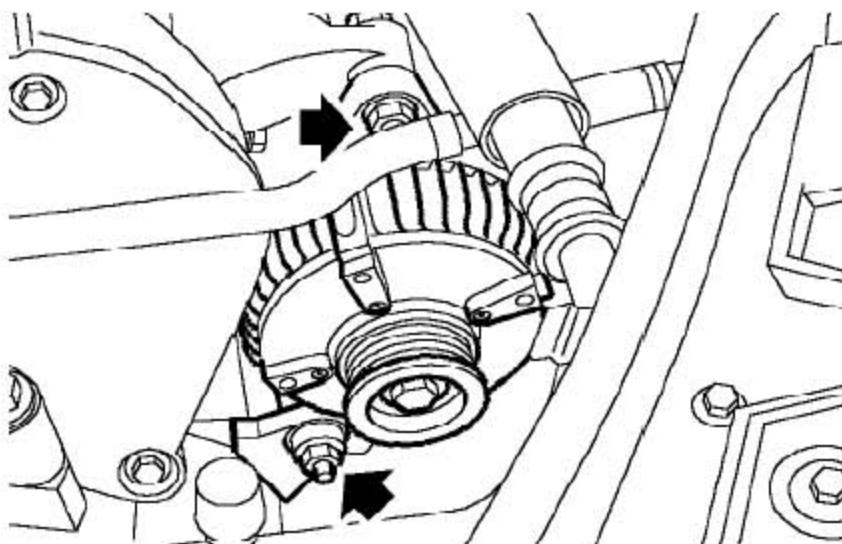
16). 拧下发电机顶部螺母和螺栓，松开底部螺母，并把发电机往后移动。
