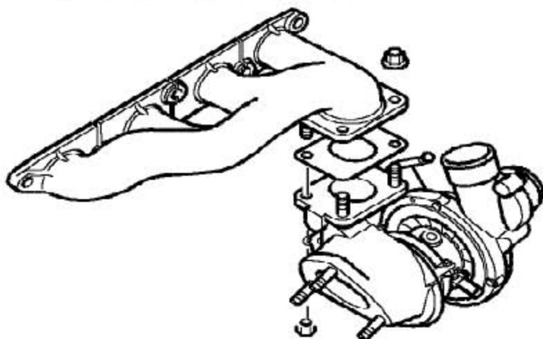
22). 拧下4个把涡轮增压器固定到岐管上的螺母，从涡轮增压器上松开排气岐管，拿开并废弃衬垫。
