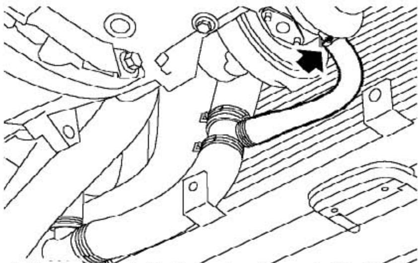
12). 松开把冷却液进液软管固定到涡轮增压器上的夹箍并拿开软管。
