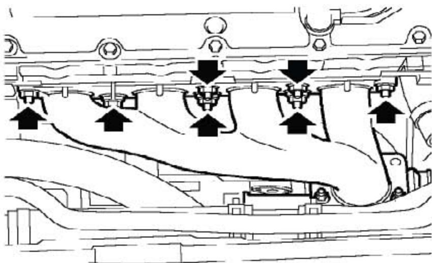
20). 拧下5个把排气歧管固定到发动机上的螺母。
