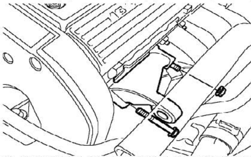
17). 拧下把发电机上支架固定到发动机上的螺母和螺栓并拿开支架。
