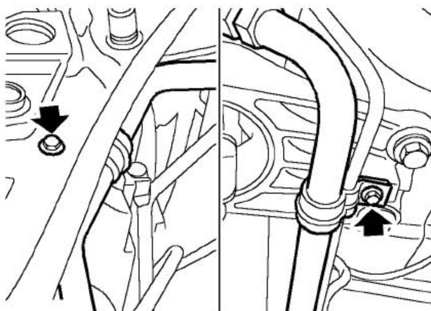
2). 拧下2个把空调管夹子固定到发动机右系杆和发动机罩锁止平台上的螺栓。
