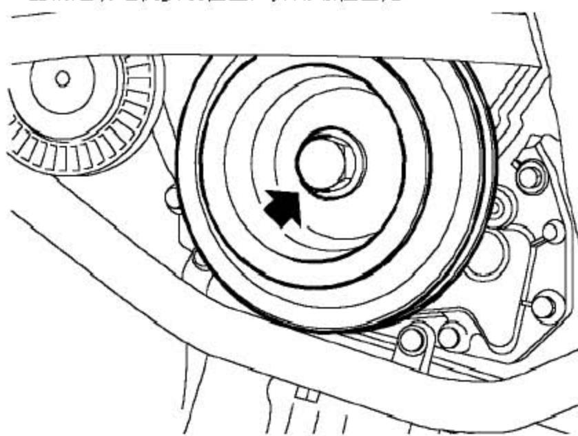
7). 取下固定皮带轮到曲轴上的螺栓和垫圈。
