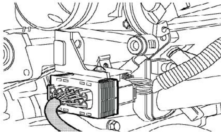
13). 从支架上松开喷嘴线束连接器，并断开连接器的连接。
