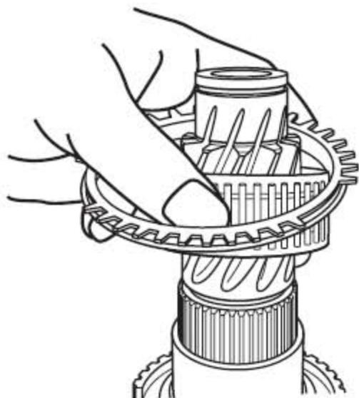
13). 拆下四挡同步器齿环。
