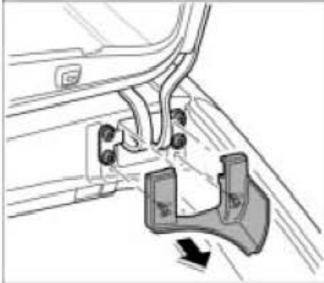
拆卸右侧铰链罩
