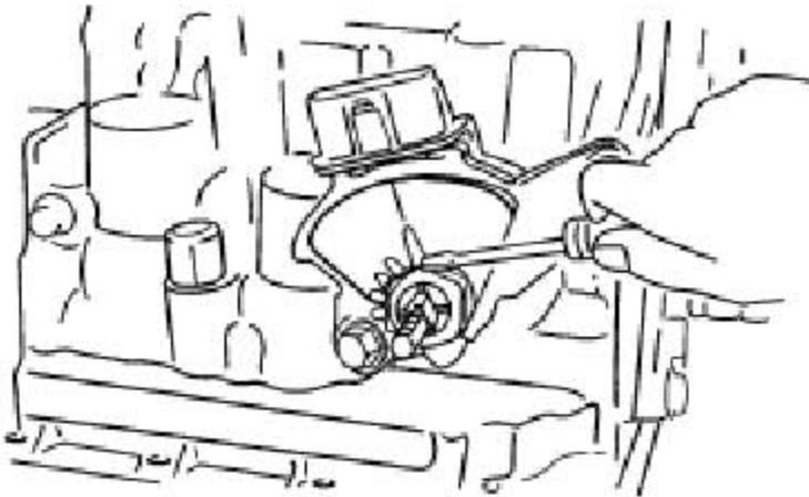
143). 安装控制杆、垫圈和螺母。
