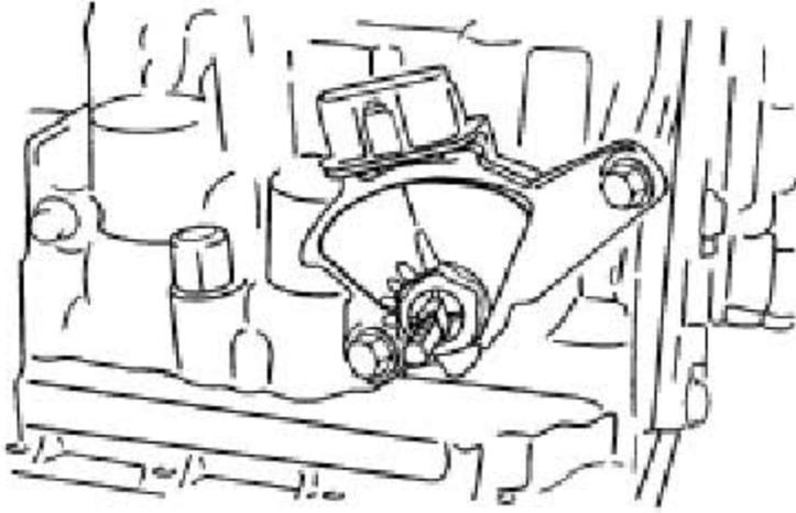
142). 使用螺丝刀，用锁紧垫圈锁紧螺母。
