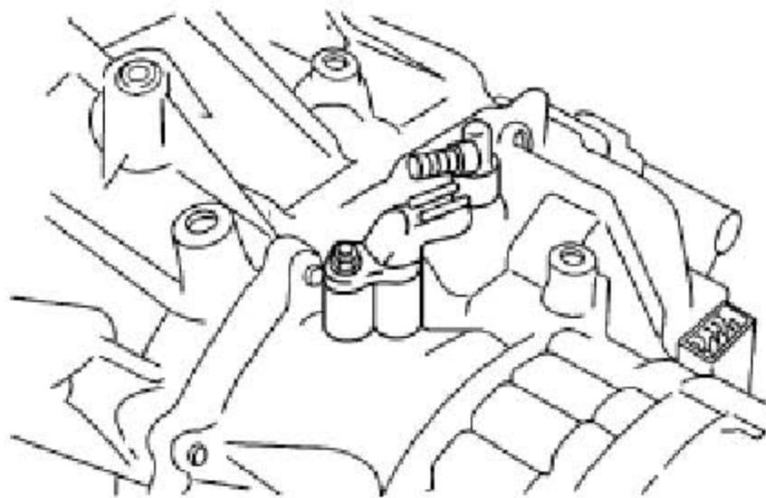
131). 将新O形圈涂上自动变速器油, 然后安装到螺塞上。
