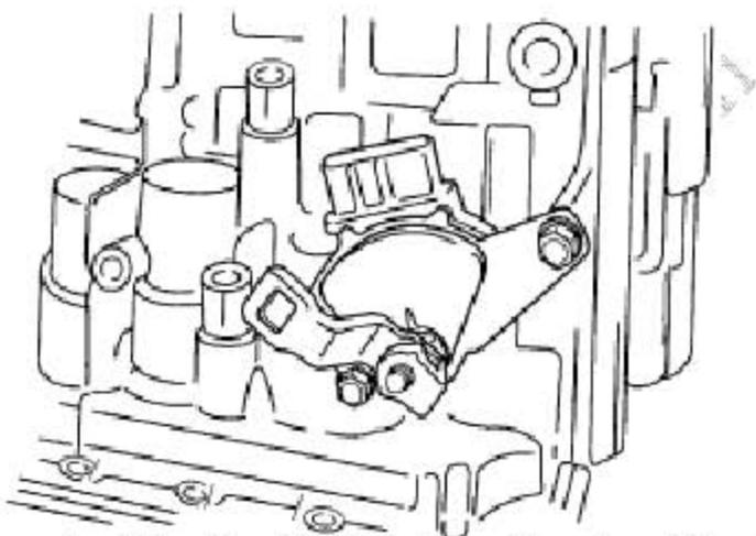
138). 将杆沿逆时针旋转到底,然后再顺时针退转2个缺口。
