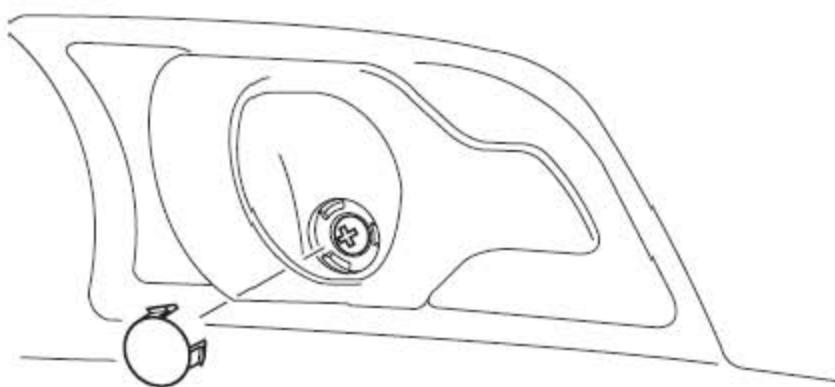
2). 从车门内拉手上拿开饰盖，并拆下将其固定到车门上的螺钉。
