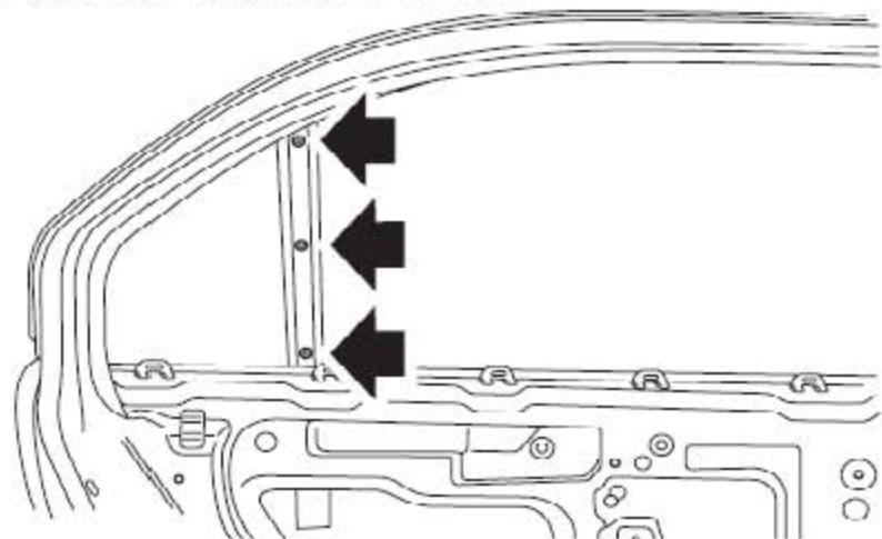
9). 拆下将后侧围车窗分割条固定在车门的3个螺丝。
