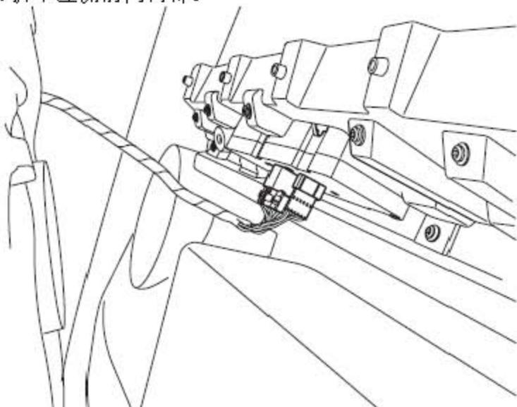
2). 连接车窗开关的连接器。
