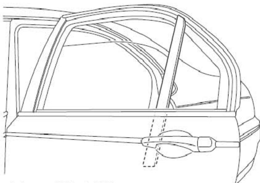
11). 拆下后侧围车窗分割条。
