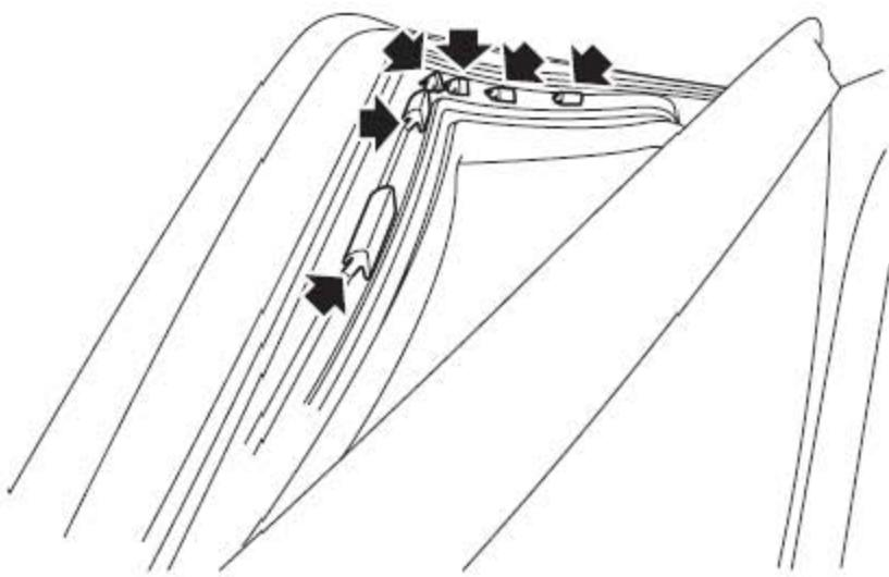
7). 松开将密封条固定到车门顶部的6个卡箍，并取下密封条。
