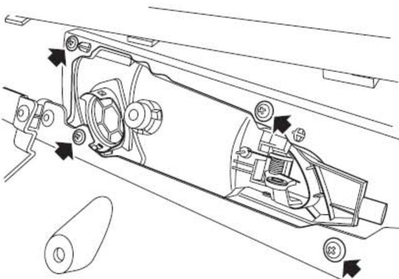
2). 拆下将前车门内拉手固定到饰板上的4个螺钉。
