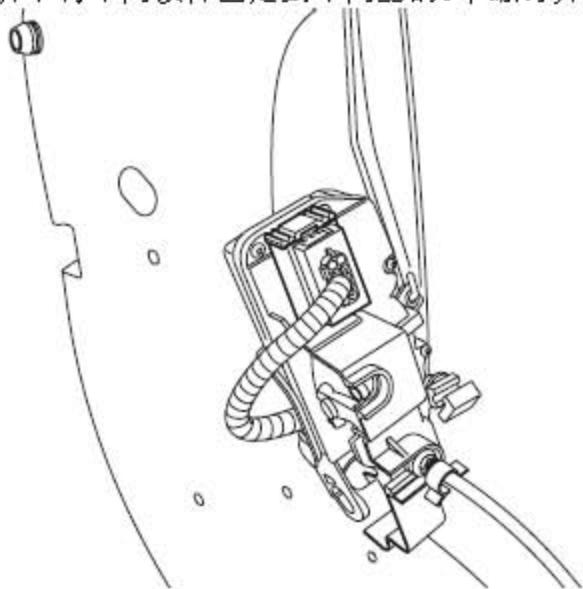
9). 断开车门锁体上的连接器。
