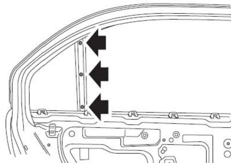
6). 拆下将后侧围车窗分割条固定在车门上的3个螺栓。
