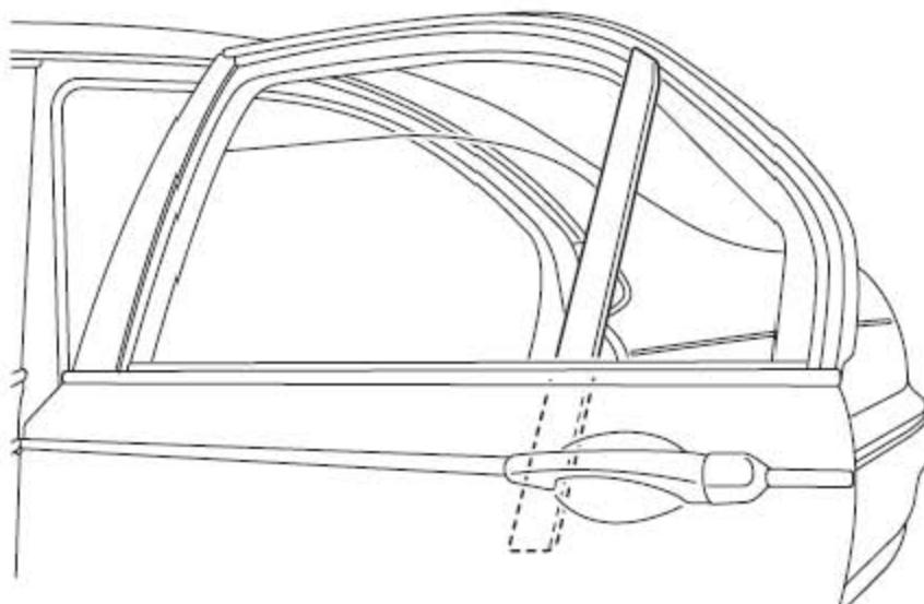
8). 拆下后侧围车窗分割条。
