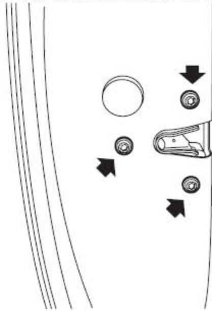
8). 拆下将车门锁体固定到车门上的3个螺钉并向前移动以便接触到连接器。
