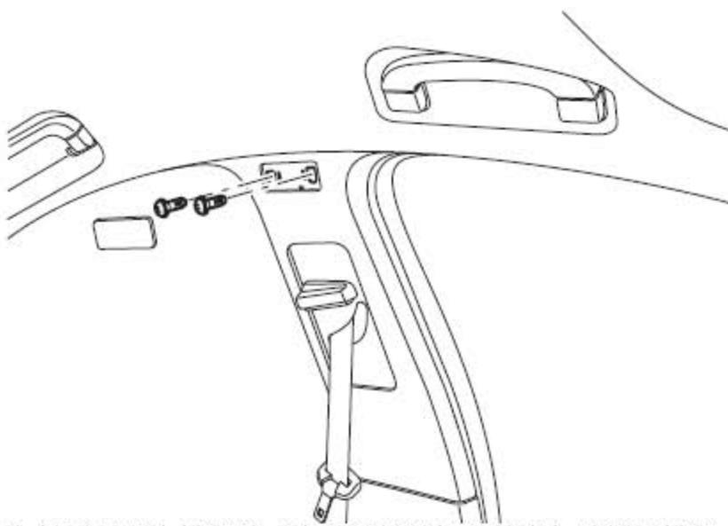
3). 松开BC柱上饰板总成上的螺钉装饰盖的卡扣并拆下饰板，拧下2个螺钉。
