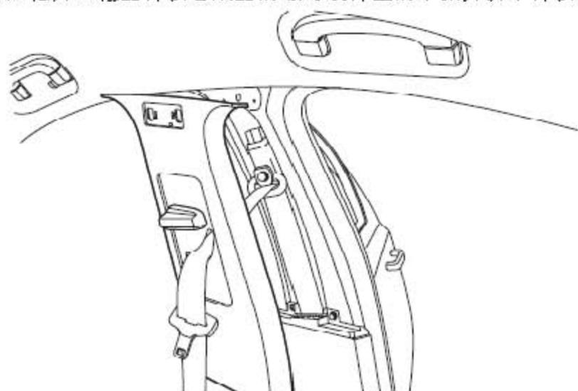
4). 拆下将BC柱饰板固定在BC柱上的2个螺钉。
