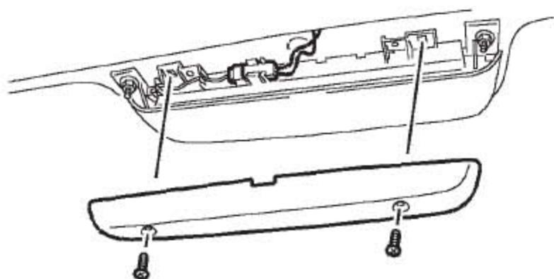
20). 拆下固定高位刹车灯(CHMSL) 盖的2个螺钉并将灯盖取下。
