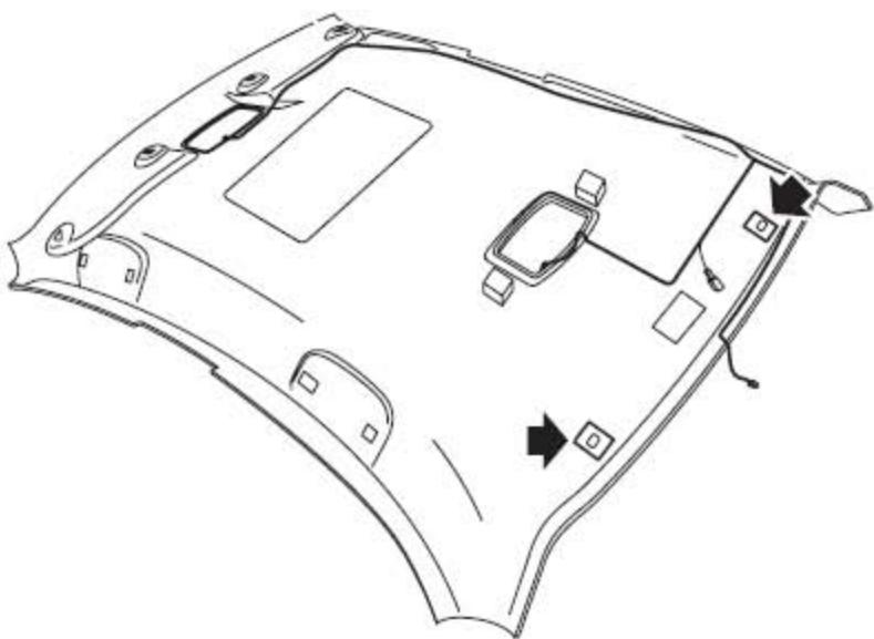
26). 松开将内饰顶板后缘固定到车身上的2个卡扣。
