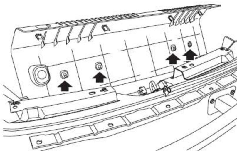
4). 拆下将行李箱门槛饰板固定到车身上的4个快速释放螺钉。
