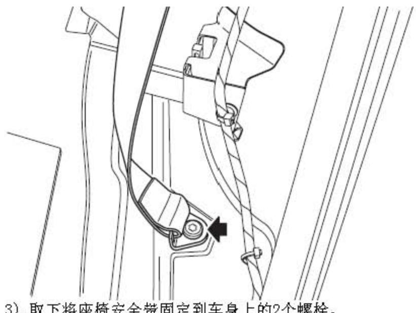
3). 取下将座椅安全带固定到车身上的2个螺栓。
