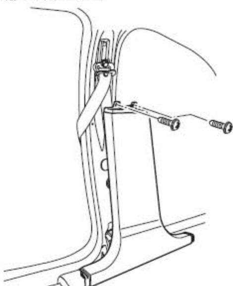
3). 拆下将BC柱下饰板总成固定到BC柱上的2个螺钉。
