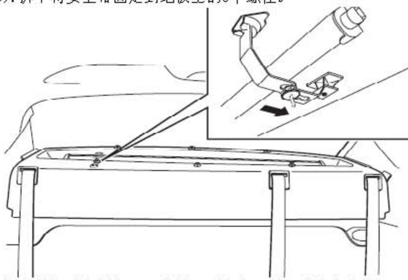
6). 向前滑动台板架子，来松开固定架子的6个定位卡扣。
