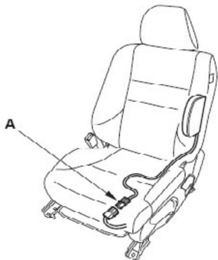
7). 将地板线束2针插接器(A)从侧窗帘式气囊上断开。
