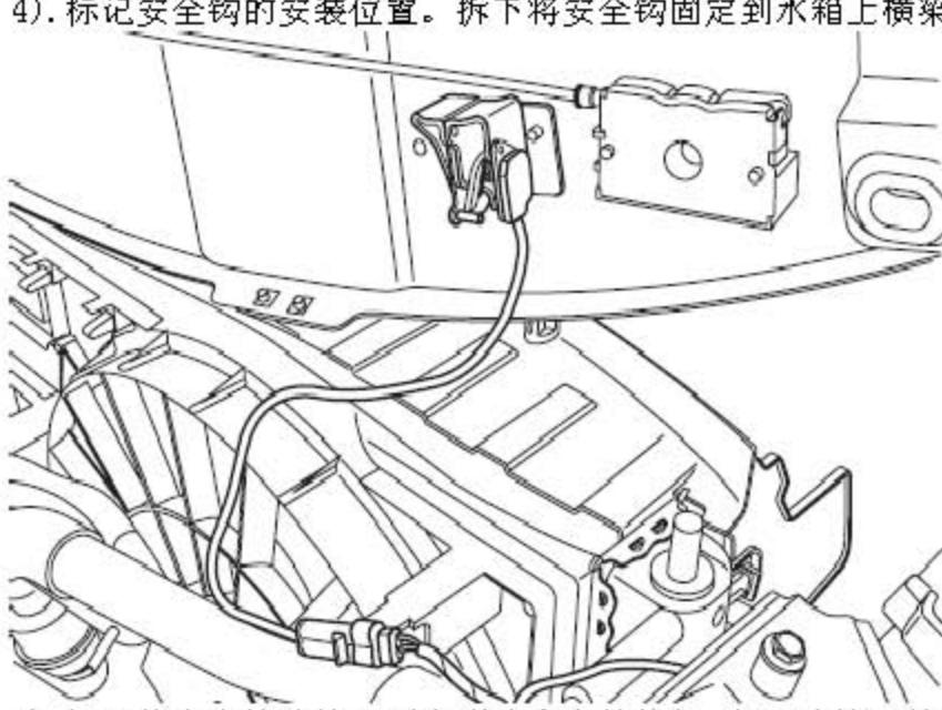
5). 拆下将安全钩连接器固定到线束上的扎带，断开连接器的连接并取下安全钩。
