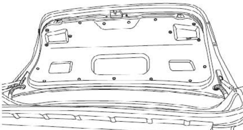
2). 取下将饰板固定到行李箱盖上的所有的卡扣并松开应急开启拉线。
