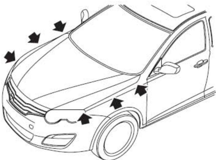
1). 检查发动机罩的定位。发动机罩到前翼板的曲线必须流畅。发动机罩和前翼板之间的间隙必须均匀。发动机罩的前角必须和前翼板水平。
