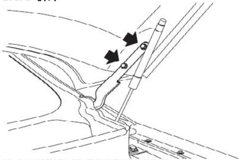
1). 拆下将铰链固定到发动机罩上的螺栓。
