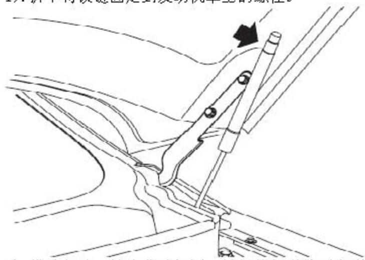
2). 借助帮助，撑住发动机罩，松开将气弹簧固定到发动机罩上的弹簧夹，而后取下发动机罩。
