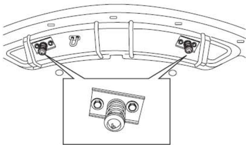
3). 拧开将两个发动机罩锁扣固定到发动机罩总成上的4个螺栓。
