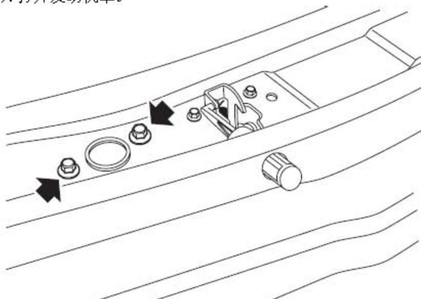
2). 取下将发动机罩锁体总成固定到水箱上横梁上的2个螺栓并拆下锁体总成。
