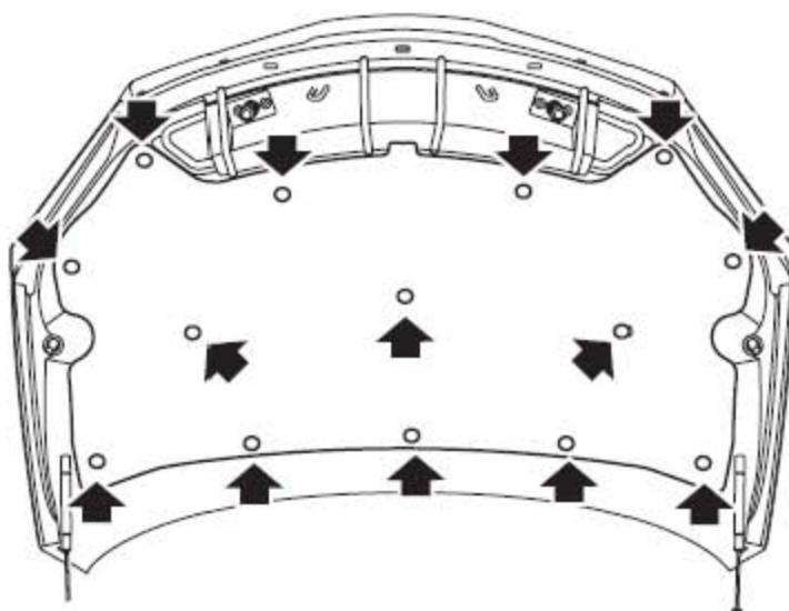
1). 拆下固定发动机罩隔音衬垫的14个卡扣
