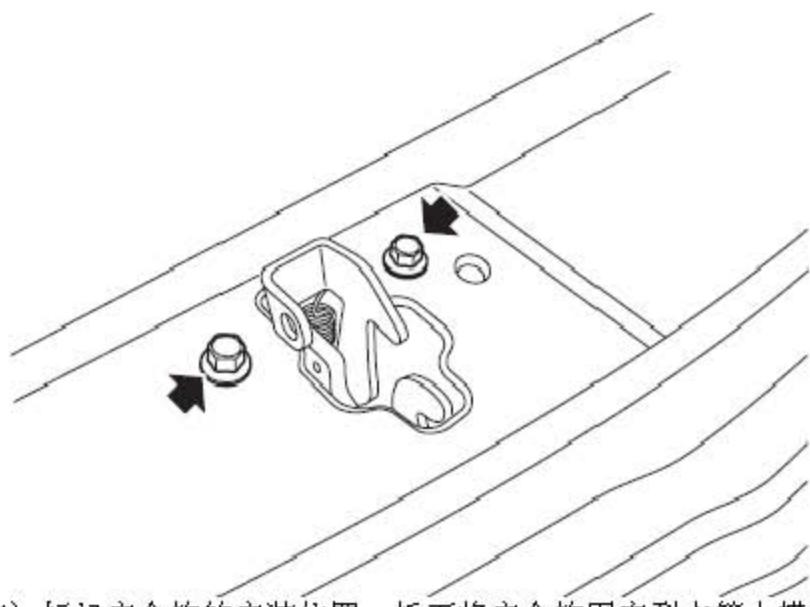
4). 标记安全钩的安装位置。拆下将安全钩固定到水箱上横梁上的2个螺栓。
