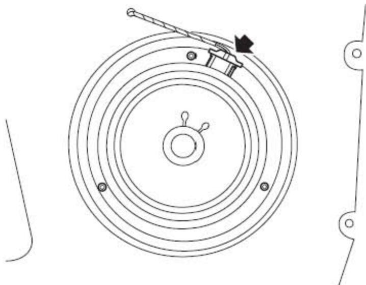
2). 拆下将低音扬声器固定到前车门上的3个螺钉并取下低音扬声器。
