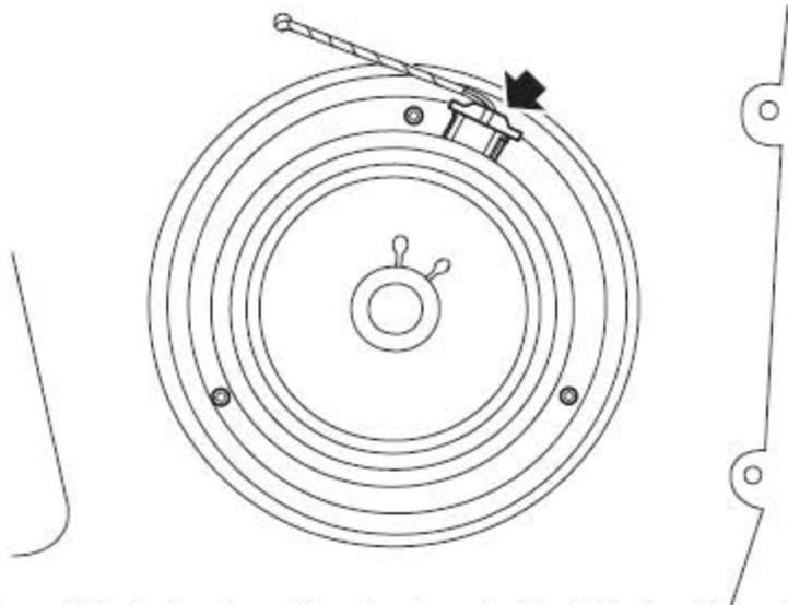
2). 拆下将低音扬声器固定到后车门上的3个螺钉并取下低音扬声器。
