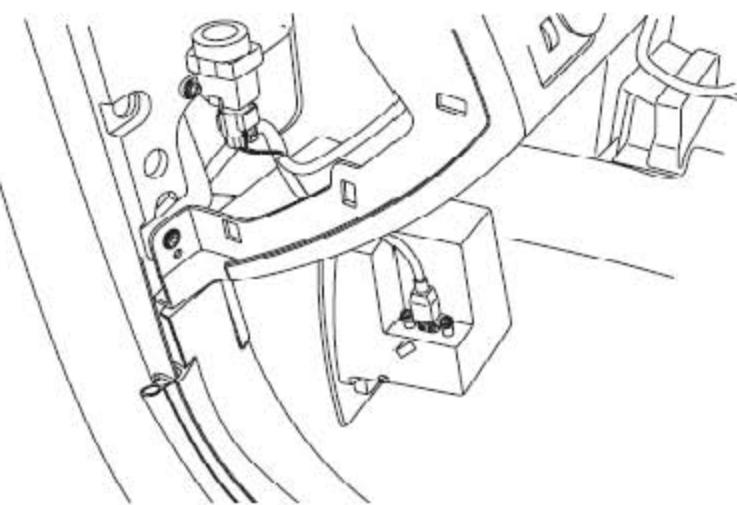
18). 拧下将USB接头固定到储物盒上的2个螺钉，取下储物盒。
