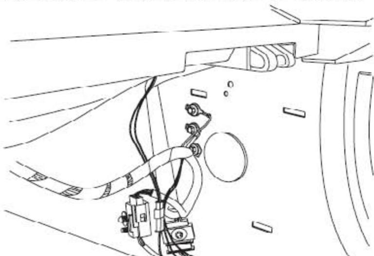
10). 拉开右侧A柱下饰板附近的地毯，拆下3个接地螺栓并断开3个接头。
