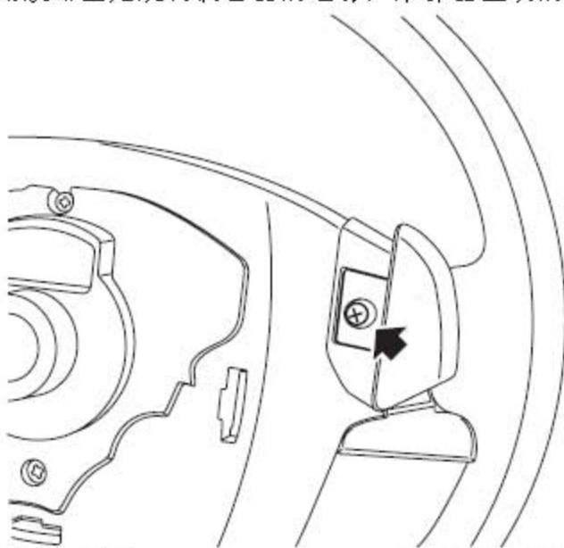
9). 拆下右侧将 tiptronic paddle 开关固定在方向盘的螺栓（如采有安装的话），并且仔细松开将开关固定在方向盘的卡扣。
