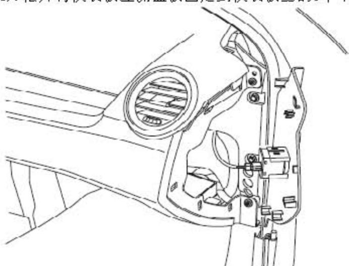
15). 松开将仪表板右侧盖板固定到仪表板上的5个卡扣，断开乘客侧安全气囊(PAB)禁用连接器，并拆下该盖板。
