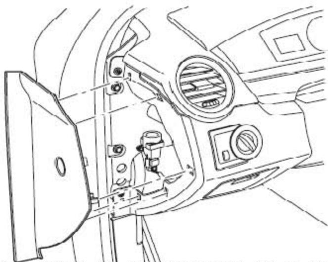
14). 松开将仪表板左侧盖板固定到仪表板上的5个卡扣，并拆下该盖板。
