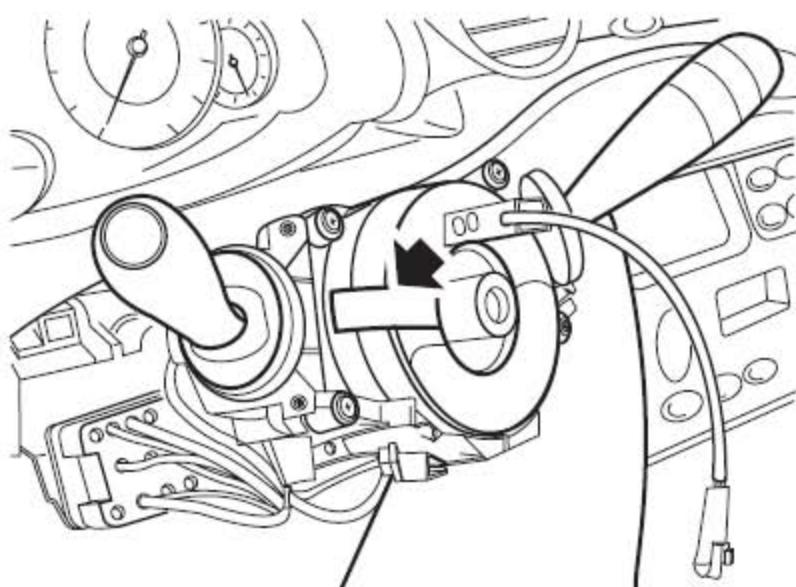
8). 用胶带固定旋转偶合器的边缘，来保留正确的设置。
