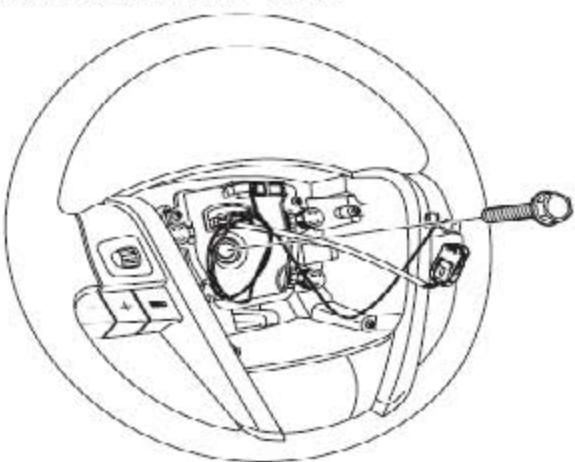
7). 拆下方向盘上的螺栓，并拆下方向盘。
