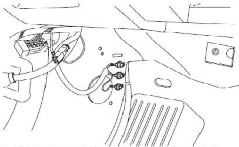
9). 拉开左侧A柱下饰板附近的地毯并拆下3个接地螺栓。
