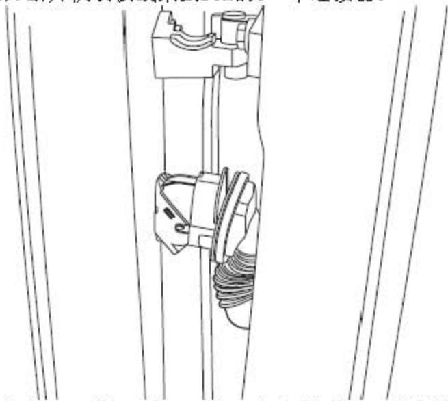
12). 松开2侧车门索环并断开仪表板到车门线束的连接器。
