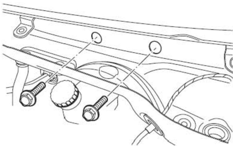
19). 拆下2个将仪表板支撑骨架固定到隔板上的2个螺栓。
