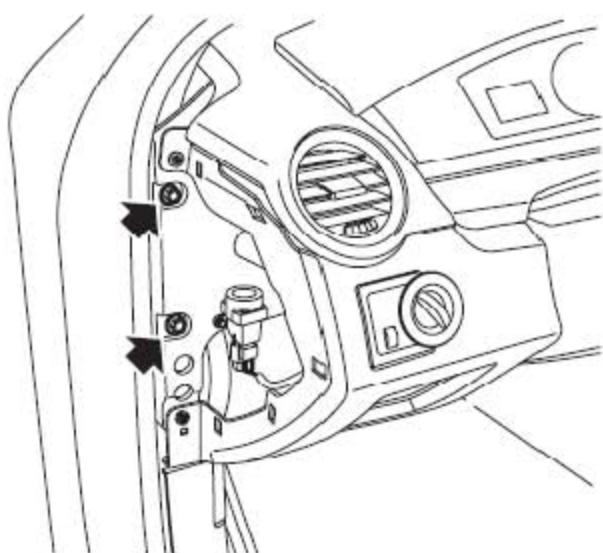
20). 拆下两侧将仪表板支撑骨架固定到车身上的4个螺栓。
