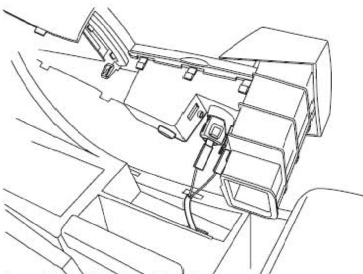
7). 断开2个电器接头和一个连接器。
