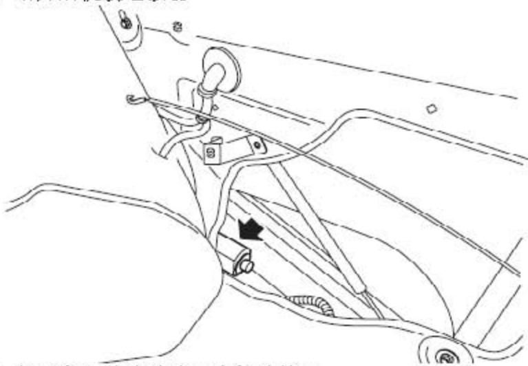
8). 断开车门玻璃升降器电机连接器。
