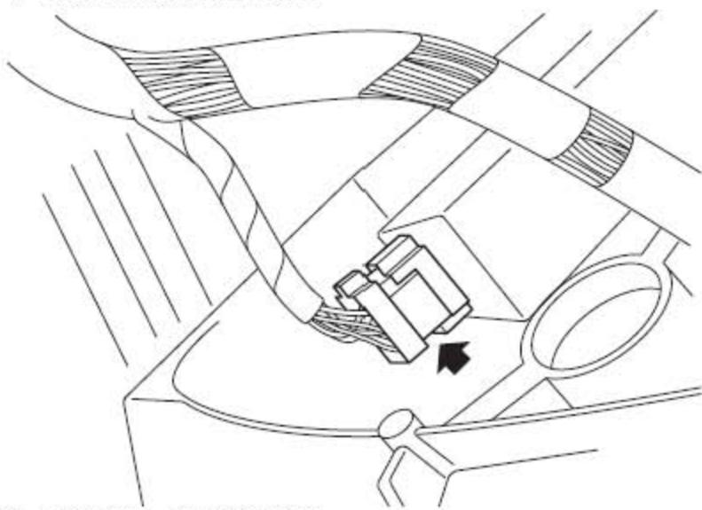
7). 断开ESCL-ECU的连接器。
