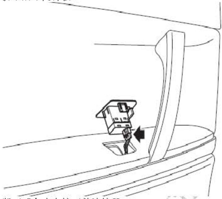
3). 断开后车窗电控开关连接器。
