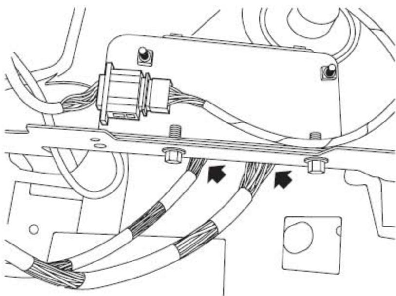
10). 拆下玻璃升降器继电器盒上的连接器（如安装）。
