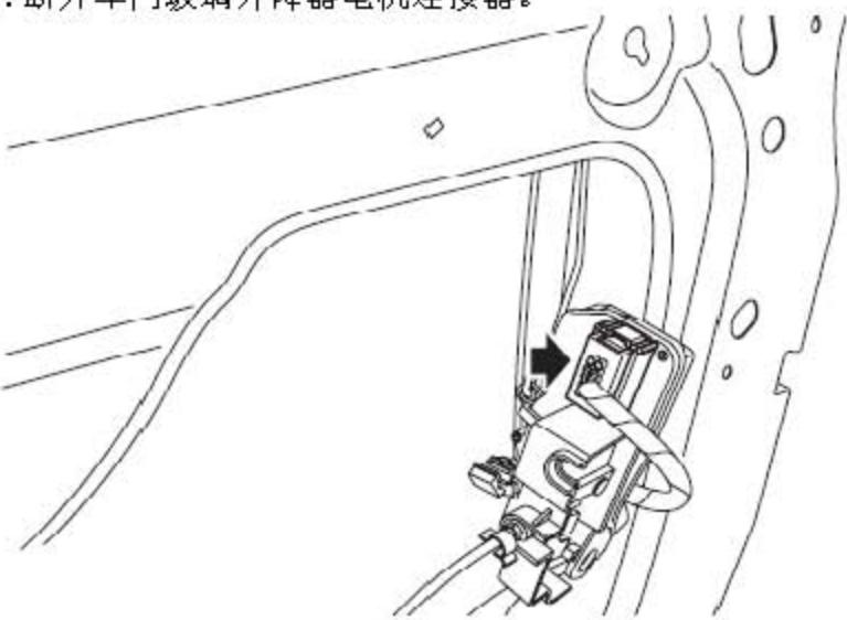
9). 断开车门中控门锁电机连接器。
