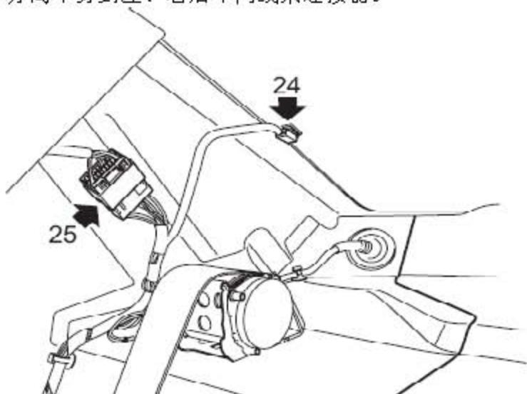
24). 拆下后风窗玻璃加热单元连接器。
