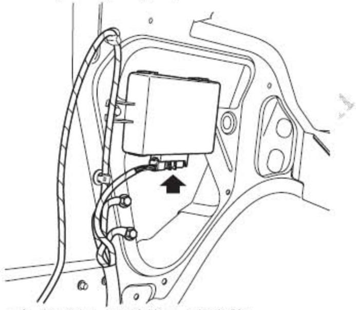
35). 断开PDC-ECU连接器（如安装）。
