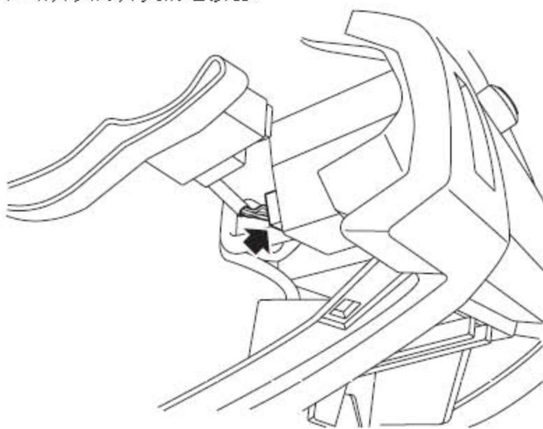
6). 断开起止开关的连接器。
