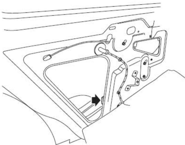
6). 断开车门玻璃升降器电机连接器。
