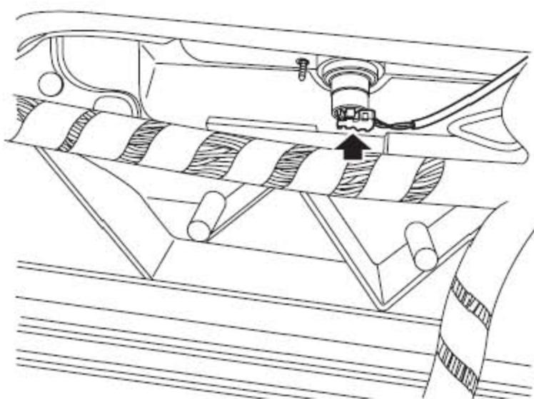
12). 断开乘客侧安全气囊模块连接器。
