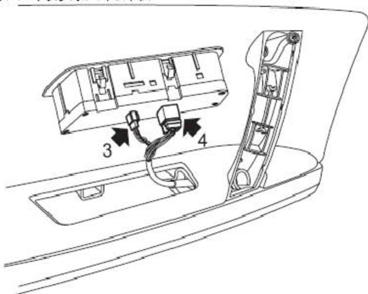
3). 断开驾驶员门车窗电控开关连接器。
