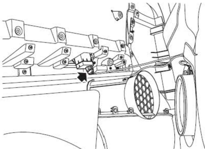
3). 断开乘客侧门车窗电控开关连接器。
