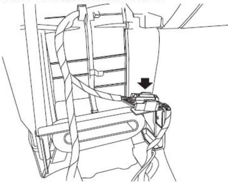
12). 拆下车身到空调线束上的连接器。
