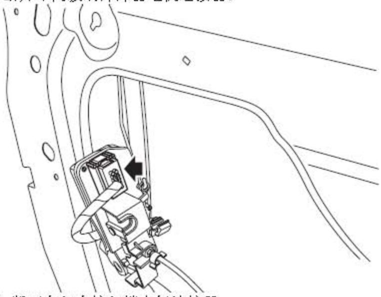
10). 断开车门中控门锁电机连接器。
