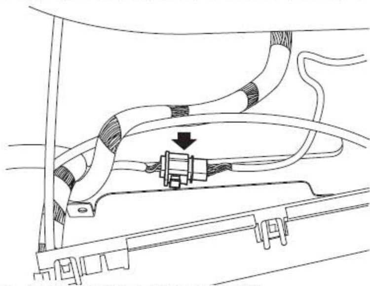
11). 分离车身到发动机舱线束的连接器。
