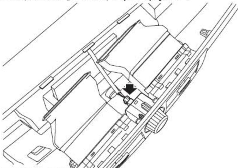
11). 断开多功能控制开关连接器。
