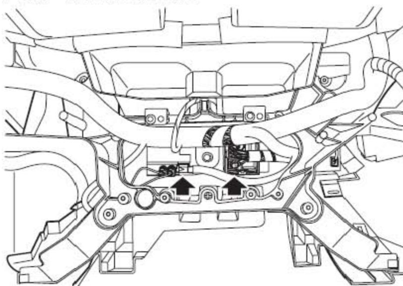
10). 断开CD/导航仪上的两个连接器（如安装）。
