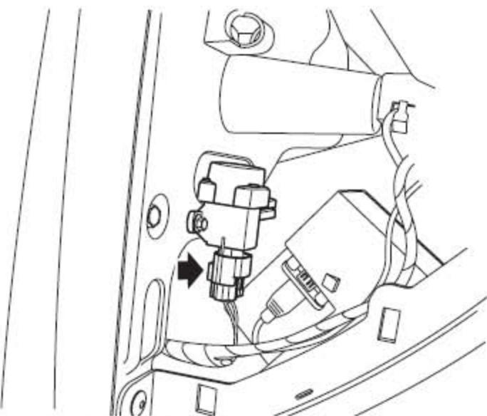
4). 断开惯性开关的连接器。
