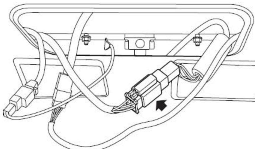
32). 断开倒车雷达摄像头连接器（如安装）。
