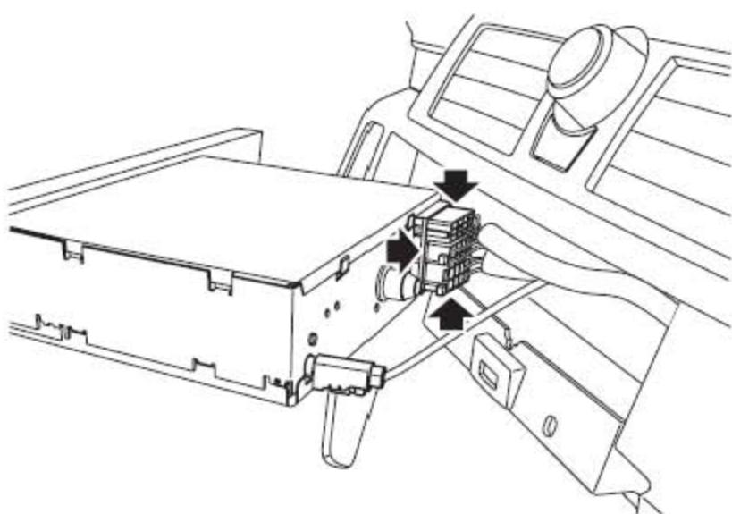
9). 断开CD/收音机上的连接器。
