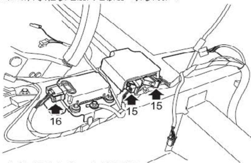
15). 断开安全气囊ECU上的连接器。
