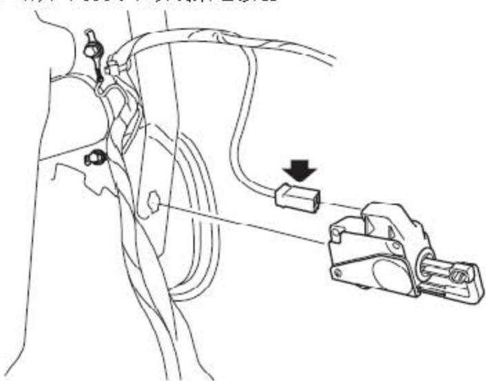
26). 断开加油口盖开闭器电机的连接器。
