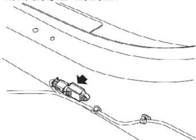
21). 拆下左、右两侧侧撞传感器（如安装）。
