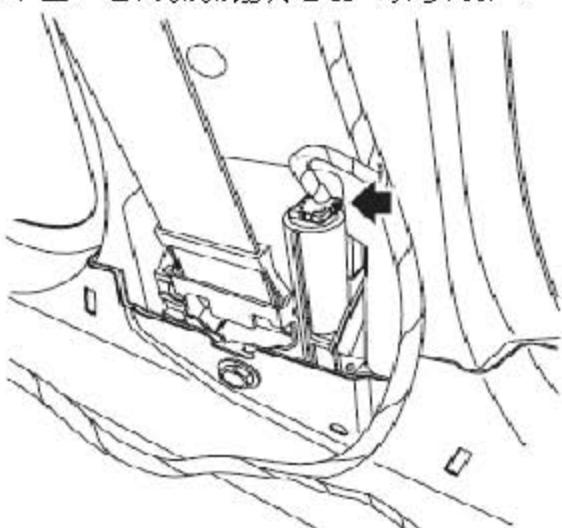
22). 拆下左右两侧的座椅安全带预张紧器连接器。
