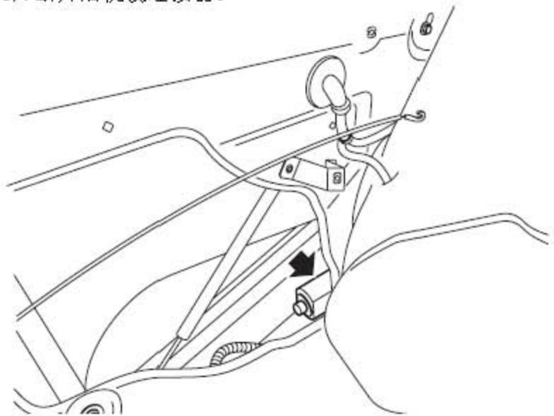
9). 断开车门玻璃升降器电机连接器。
