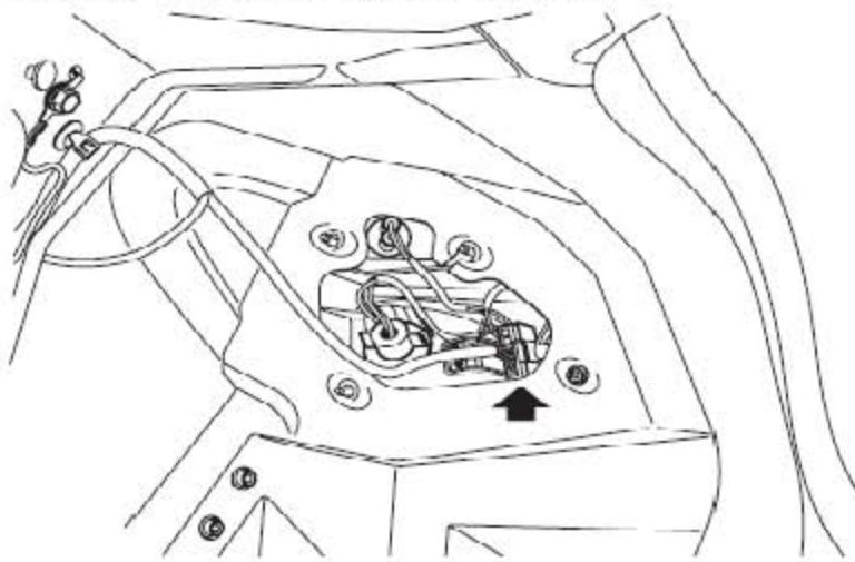
33). 断开左、右后尾灯总成连接器。
