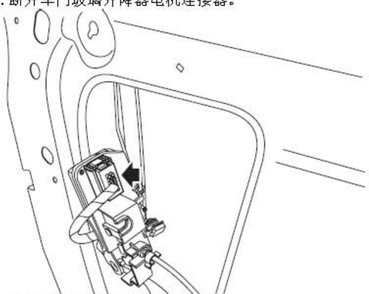
7). 断开后车门中控门锁电机连接器。
