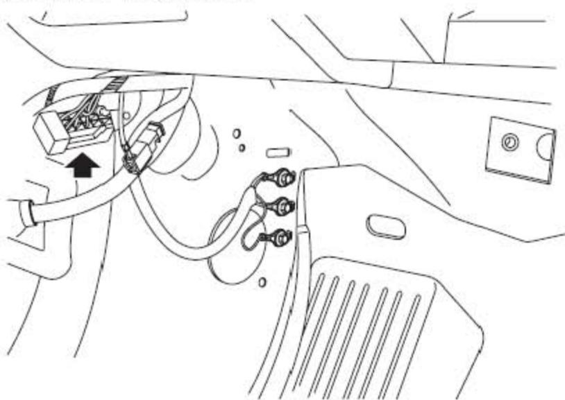
8). 断开诊断接口的连接器。
