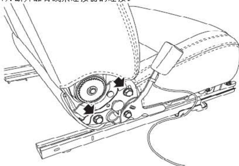
8). 拆下将靠背固定到坐垫骨架上的螺栓（两侧共4个）并拿开靠背。
