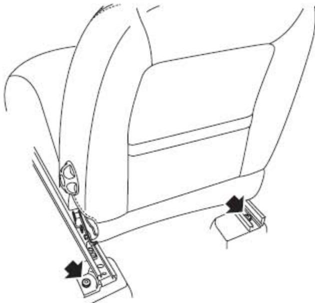
5). 拆下座椅导轨后端的2个固定螺栓，并将其废弃。
