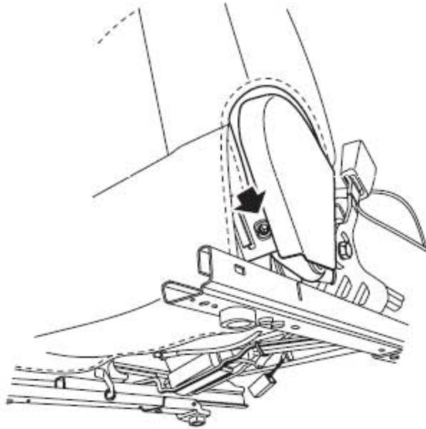
4). 取下将内侧板固定到座椅上的螺钉。
