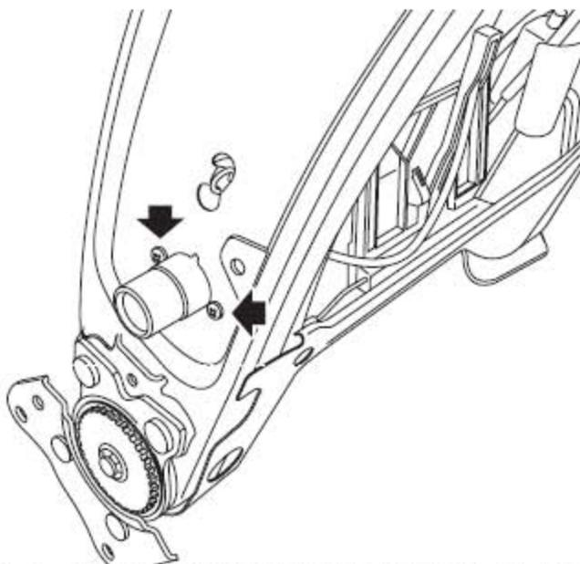
4). 取下将腰托控制器固定到靠背骨架上的2螺钉。
