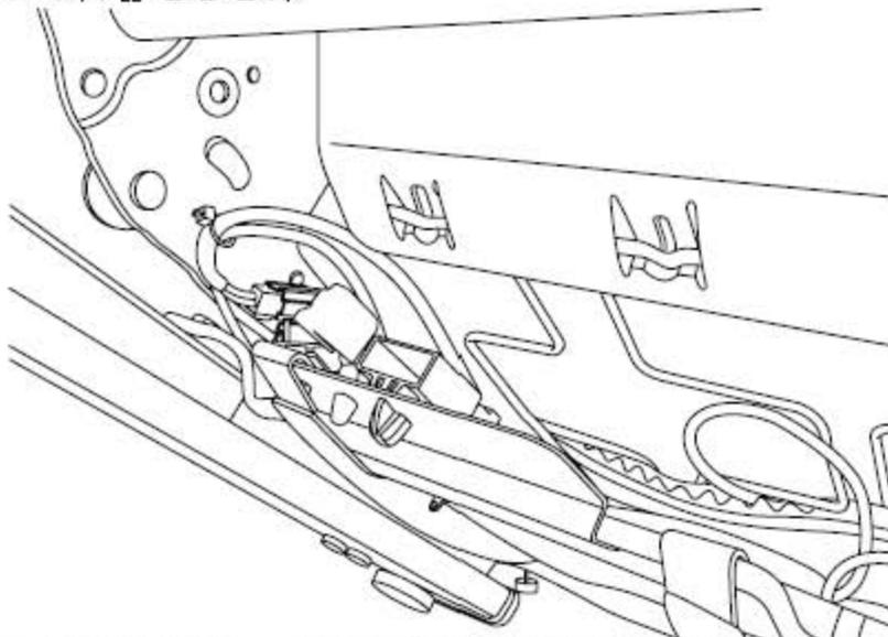
7). 断开安全带扣、及侧气囊模块连接器（如安装）的插头。
