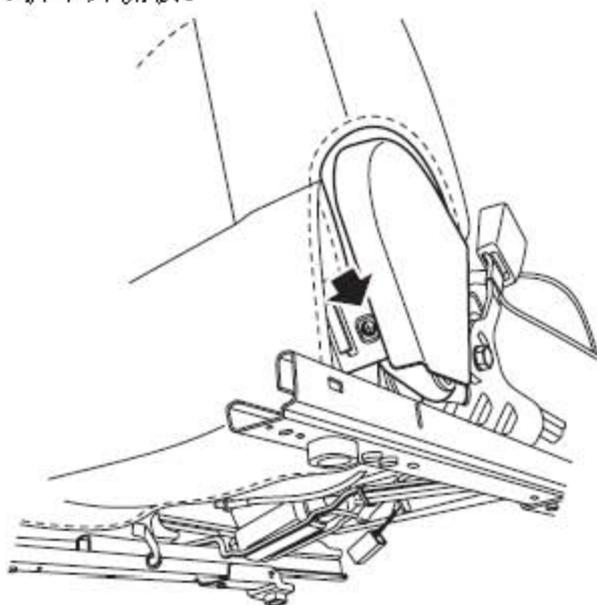
3). 取下将内侧板固定到座椅上的螺钉。
