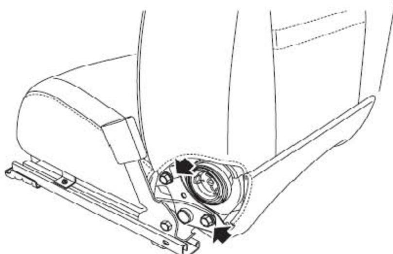
9). 拆下将靠背固定到坐垫骨架上的螺栓（两侧共4个）并拿开靠背。
