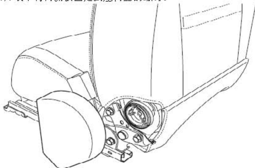
7). 松开将内侧板固定到座椅上的卡扣并拿开内侧板。
