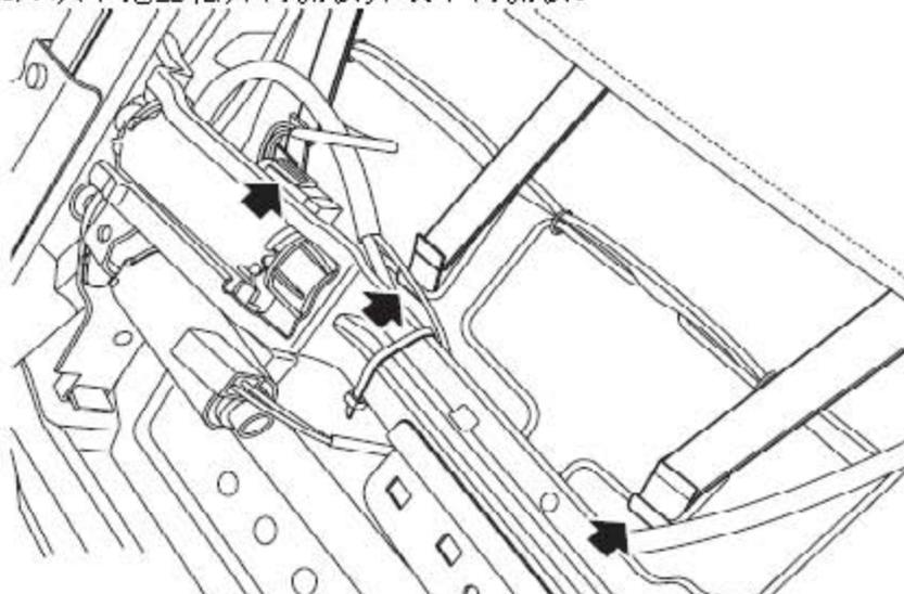
5). 松开将座椅靠背蒙皮固定到坐垫骨架上的3个卡扣。
