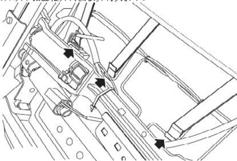
6). 松开将座椅靠背蒙皮固定到坐垫骨架上的3个卡扣。
